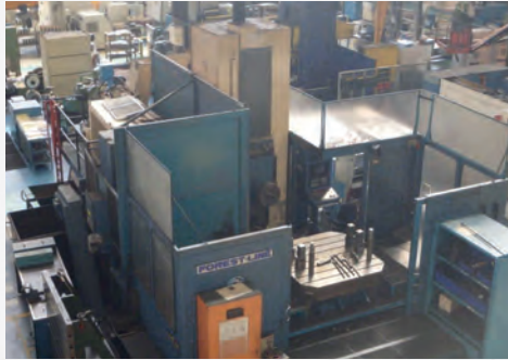
Aléseuse horizontale CNC FOREST-LINE FIMAX P150 Courses X 2500 mm - Y 2000 mm - Z 1800 mm - W 500 mm Année de construction 1993 CNC NUM 760 Table 1600 x 1600 mm Changeur d'outils : 50 outils
