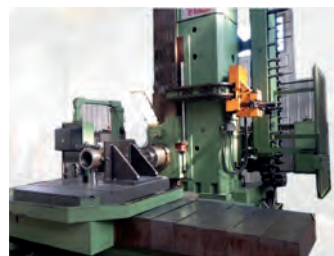
AV Aléuseuse TOS WHN110 Q - Aléuseuse/ fraiseuse en T - CN Heidenhain - Année 1998 - X 2000 x Y 1400 x Z 1250 - Table : 1400 x 1600 - 8 T - Broche : 2800 tr/ min - 37 kw - ISO 50 - Broche : 112 mm Changeur auto 60 outils - Arrosage au centre - Tél : 04 76 37 53 26 Mail : info@mfl-industrie.com
