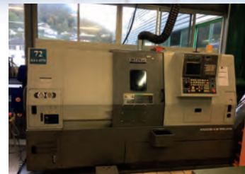
Tour CNC KIA SKT21 LMS De 2007 Bi broche - Commande Fanuc 21 T 4 axes Passage en bar ø : 70 mm
