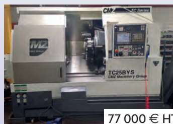
Tour CMZ TC25BYS De 2008 avec 7500 h de broche Arrosage 15 bars - Récupérateur de pièces avec convoyeur - Tourelle 16 postes - Bi broche - TBE
