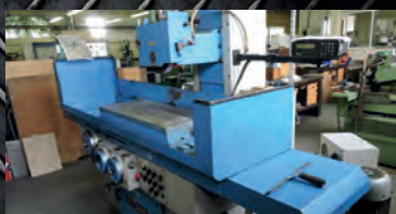
Rectifieuse plane FERDIMAT TA104A 2001 - Plateau 1000 x 4000 - Meule 300 Course 800 - Visu 2 axes - Accessoires
