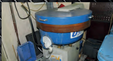
Tonneau d'ébavurage WALTER Trowal CM15 Doseur Diamètre 1000
