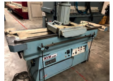
AV Rectifieuse plane à meule boisseau pour lames de cisaille MVM - Type AF 1000 - Surface de rectification : 1000 x 120 mm - Hauteur de rectification : 55 mm - Avance de la tête de la meule : 0,005 / 0,150 mm - Longueur de rectification maximale : 1000 mm - Type de la meule : segments - Vitesse de rotation de la meule : 2800 Tr/Mn - Diamètre de la meule : 150 mm - Puissance du moteur de la tête de la meule : 3 cv - Accessoire inclus : table basculante - Prix : 6 500 Euros HT - Tél : 06 07 68 86 74 Mail : lgmo95@orange.fr
