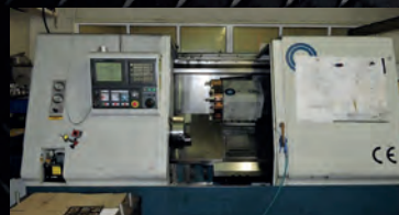
Tour ROMI G30 CNC Fanuc 21i-T Mandrin 310 - EP 1000 - Diam maxi 500
