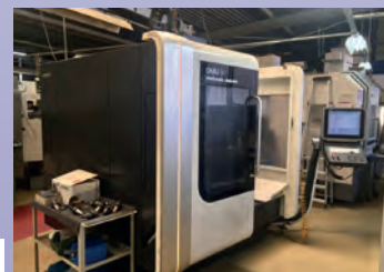
CU DMU 50 - 5 axes De 2010 CNC Mill Plus Courses 500 x 450 x 400 10 000 tr/min - ISO 40
