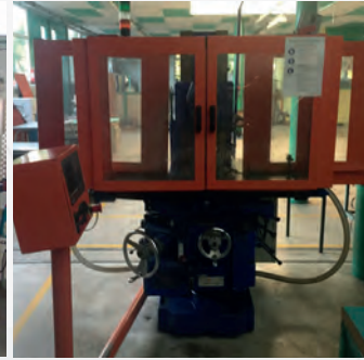
Fraiseuse universelle DUFOUR type F194 Courses X 800 mm - Y 300 mm Z 400 mm Cône SA40 Visu 3 axes HEIDENHAIN
