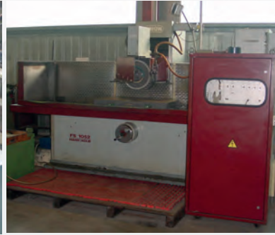
Rectifieuse plane ELB HAHN & KOLB FS1052 Courses X 1000 mm - Y 500 mm - Z 350 mm Année de construction 1989 Table 1600 x 550 mm Axes X-Y-Z : prise de passe auto
