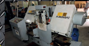
Scie à ruban EVERSING H-360HAPC Automatique - Descente sur colonne Convoyeur à vis
