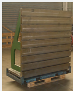
Equerre en fonte rainurée Largeur 1600 mm x hauteur 1620 mm Profondeur 790 mm 8 rainures en T - 20 x 30 mm
