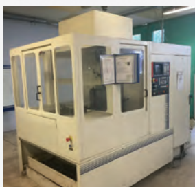
Centre d'usinage REALMECA type CU 300H Courses X 320 mm - Y 350 mm Z 250 mm CN : NUM 1060 Magasin : 20 outils
