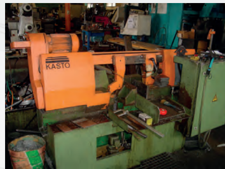
Scie à ruban automatique KASTO SBA 260 AU Ø de coupe maxi 270 mm Course aménagement automatique 1000 mm
