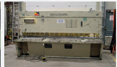
Cisaille hydraulique COMESSA type CN300 Capacité 3000 x 10 mm Profondeur col de cygne 300 mm Butée arrière électrique Lg 850 mm
