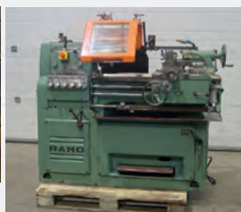
Tour parallèle RAMO T36 ET Entre-pointes 600 mm Ø maxi sur le banc 360 mm Ø maxi au dessus du trainard 180 mm Contrepointe CM4
