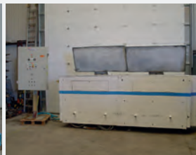
Vibrateur bac droit PARKER Sparatron SP 30/2 Année de construction 1990 Cuve : Lg 2800 x l 500 x ht 500 mm Revêtement en TBE
