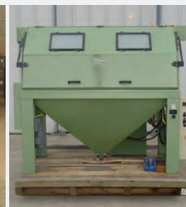
Sableuse de rouleaux HANS STUDER type SM 200 Pour sabler des rouleaux lg maxi 1850 mm Rotation rouleau par variateur
