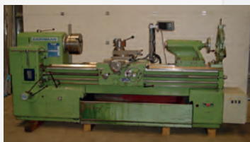
Tour parallèle CAZENEUVE HB 725 Entre-pointes 1500 mm Ø maxi sur le banc 725 mm Ø maxi au dessus du trainard 400 mm Passage de broche Ø 81 mm
