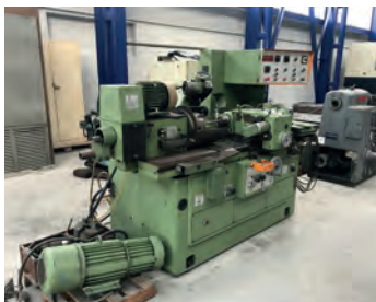
AV Rectifieuse inter VOUARD 5A en TBE - Diam : 5 à 200 - Lg Max : 550 mm HP : 180 mm - Dressage - Prix bas Tél : 04 76 37 53 26 Mail : info@mfl-industrie.com
