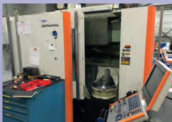
CU 5 axes MIKRON HPM 450 De 2012 Courses 540 x 450 x 400 Broche 20 000 trs/min Heidenhain ITNC 530 Magasin 7 palettes de 450 x 450
