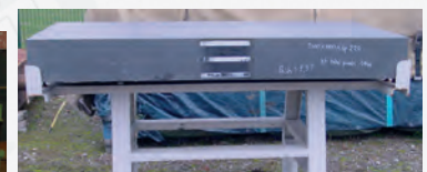
Marbre de contrôle en granit 2000 x 1000 x épaisseur 220 mm Hauteur totale sur pieds 1140 mm + autres dimensions disponibles
