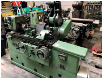
AV Rectifieuse cylindrique inter/exter CONSTRUCTION DE CLICHY - Type CC5010 - Hauteur de pointe : 130 mm Longueur de rectification : 500 mm Appareil intérieur basculant - Vitesse de la meule extérieure : 2840 tr/mn Diamètre de la meule : 300 mm Diamètre du mandrin : 150 mm - Vitesse maximum du mandrin : 900 tr/mn Accessoires inclus : Lunette 2 touches, Appareil à diamanter - Prix : 5 500 Euros HT - Tél : 06 07 68 86 74 Mail : lgmo95@orange.fr
