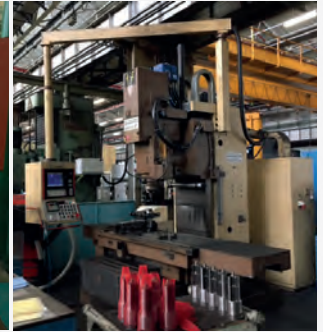
Fraiseuse verticale CNC RAMBAUDI RAMMATIC 600 Courses X 1260 mm - Y 690 mm - Z 600 mm Année de construction 1991 CNC NUM 1060 Table 2000 x 600 mm
