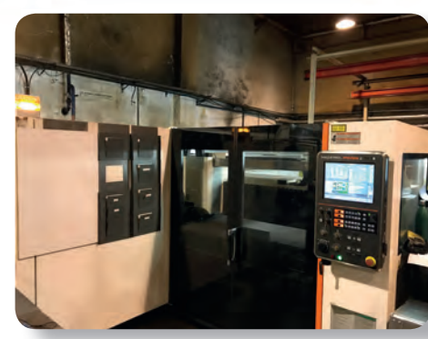
Laser MAZAK OPTIFLEX 3015 CO2 4000 W
