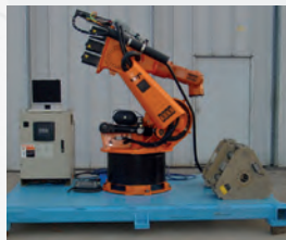
Robot KUKA type KR 125/1 Commande KRC-1 Capacité 125 kg Année de construction 1997
