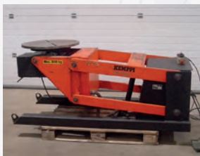
Positionneur 3 axes KEMPMI type 800 SNH Capacité maxi 800 kg Inclinaison de 0 à 135° maxi Ø du plateau 620 mm
