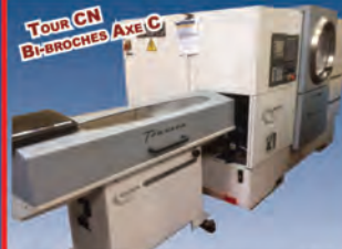
COLCHESTER TORNADO T6MS ANNÉE : 2006 / FANUC 18iTB Ø : 440 / 220 x L. : 450
