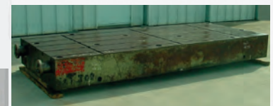
Taqué en fonte rainurée 3890 x 1595 x épaisseur 400 mm 6 rainures en T + autres dimensions disponibles
