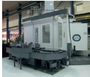
AV Tour vertical HANKOOK VTC 125 E APC - Fanuc 31iTA - Palettisation 2 tables Max. ø de passage : 1600 mm - Max. ø de tournage : 1600 mm - Hauteur de tournage : 1400 mm - Max. couple : 1500 kpm - ø de la table : 1250 mm - Poids sur table : 8000 kg - Z (mouvement vertical) : 900 mm - Course de la traverse : 700 mm - Vitesse de rotation : 0,8 - 360 tpm - Puissance du moteur : 45/37 kw Section du Ram : 220 x 220 mm - Axe C - Outils motorisés : 30 à 3000 t/mn 11/15 kw - Magasin d'outils 12 postes BT 50 - Machine proche du neuf - Machine disponible sauf vente entre temps Tél : 06 09 14 93 74 Mail : info@techmologie.com
