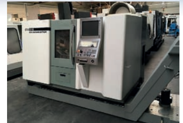
Tour CNC DMG CTX 210 De 2006 3 axes - CNC Heidenhain Dia 220 x 550 ep TBE
