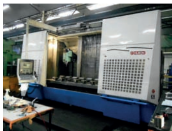
AV Fraiseuse 4 axes HURON EX 30 Année 2001 - CN Heidenhain - X 2400 x Y 700 x Z 800 - Table : 2800 x 750 Puissance ; 25 Kw - Rotation : 14k tr/min Cône HSK63 - Tête axe B continu +/- 90° incrément 0,001° - Rapides : 30 m/min Changeur - Tél : 06 88 94 32 50 Mail : info@mfl-industrie.com
