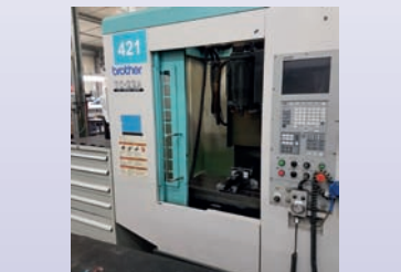
CUV BROTHER TC22A Commande Brother CNC A00 - Année 1999 Table 400 x 650 mm - Courses 500 x 400 x 410 mm - Broche BT 30 - 12 000 tr/mn - Magasin 25 outils - Diviseur 4 ème axe continu Nikken Plateau 220 mm - Manivelle électronique
