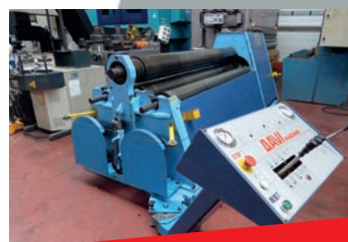
Rouleuse hydraulique 4 rouleaux DAVI Type MCA 2020 Capacité 2050 x 10 mm
