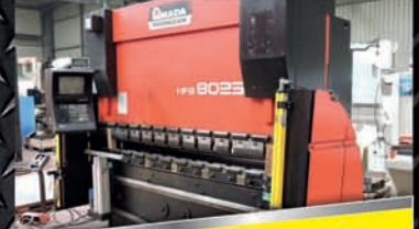
Presse plieuse AMADA HFBO Cap 80 T x 2500 - 6 axes Support avant motorisé
