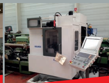
Centre d'usinage 5 axes REALMECA Type RM5H - CN Heidenhain Courses 300 x 200 x 250 mm - Axe A 360 000 positions - Axe B
