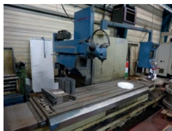
AV Fraiseuse CNC NOVAR Partner 2200 CNC Heidenhain TNC 355 - Année 1994 Course axe X 2000, Y 700, Z 800 Tél : 04 77 73 00 82
