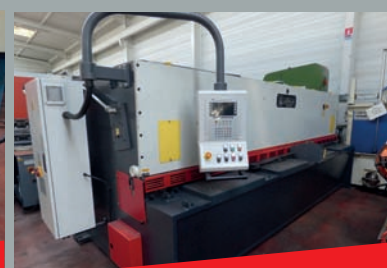
Cisaille guillotine DENER NC 4106 Positionneur ESA 530- Capacité 4160 x 6 mm Butée arrière programmable Réglage du jeu entre lames motorisé
