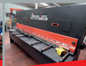
Cisaille guillotine AMADA GPX 630 Capacité 3000 x 6 mm - Réglage de l'angle de coupe et du jeu entre lames automatiques
