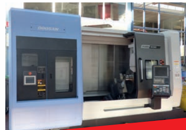
Centre de tournage fraisage DOOSAN SMX 2600S - CNC FANUC 31iB ø maxi d'usinage 660 mm - ø en barre 81 mm Longueur maxi 1540 mm - Magasin 80 outils Lunette AUTOBLOCK
