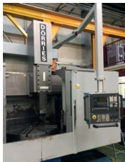
AV Tour vertical DORRIÉS - Plateau : 1200 mm - Changeur d'outils - CNC Siemens - Tél : 06 63 65 11 01
