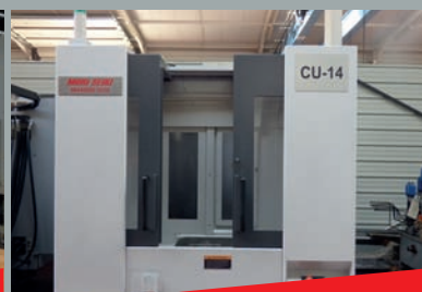
Centre d'usinage horizontal MORI SEIKI Type NH4000 DCG - Dimensions palette 400 x 400 mm CN MSX 501 III - Courses 560 x 560 x 630 mm ø Broche 20 000 trs/min - Arrosage centre broche 4 ème axe continu
