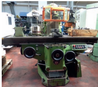
AV Fraiseuse universelle HURON - Type MU6 - Table : 2000 x 470 mm - Courses : 1500 x 700 x 550 mm Tél : 05 61 78 85 85
