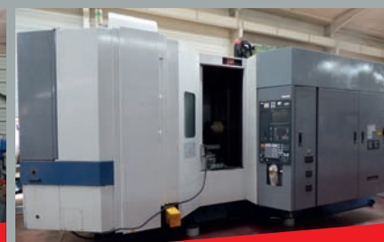
Centre d'usinage horizontal MORI SEIKI SH630 CN FANUC MSC 502 - Palette 630 x 630 Courses 840 x 760 x 840 - Cône BT50
