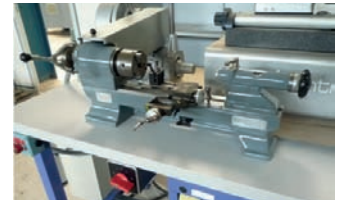
AV Tour conventionnel SCHAUBLIN 70 sur établi - Passage sur le banc : 130 mm - Distance entre pointes : 275 mm Armoire électrique neuve - Chariot croisé - Machine en très bon état Tél : 04 77 73 00 82
