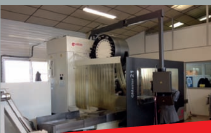
Fraiseuse à banc fixe LAGUN Type G Master 21 Surface de la table 2100 x 900 mm Courses 2000 x 1000 x 1000 mm
