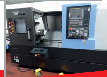
Tour DOOSAN PUMA GT2100B CN FANUC I ø maxi d'usinage 390 mm Longueur maxi 550 mm
