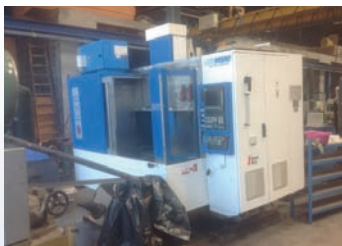
CUV HURON KX 8 De 2002 CNC Heidenhain TNC 426 Courses 800 x 700 x 500 Très bonne machine
