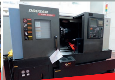
Tour CN DOOSAN PUMA 2100M Année 2011 - CN FANUC OiTD ø maxi d'usinage 406 mm Longueur maxi 520 mm - Outillage
