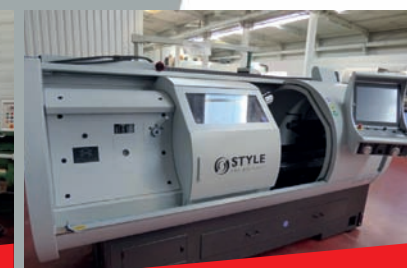
Tour par apprentissage CNC STYLE 510 Année 2017 - CN STYLE CONTROL Longueur entrepointe 1350 mm - Vitesse de rotation de broche 2500 trs/min
