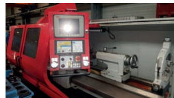
AV Tour électronique PADOVANI E300 X 2000 - Année 2002 Distance entre pointe : 2000 mm Hauteur de pointes : 275 mm - \varnothing de passage au dessus du banc : 570 mm \varnothing de passage au dessus du chariot : 340 mm - Passage de broche \varnothing : 108 mm - Réglage de la vitesse de rotation en continu - Puissance à 40/100 % ED : 25/17 kw - Couple nominal maximum sur la broche principale : 764 / 519 Nm - Normes CE - Commande numérique Fagor 8055T - Ecran couleur 14" Cartérisation complète - Cône de réduction pour broche CM5 Manuels d'utilisation, de service et pièces détachées - Documentation électrique - Tél : 01 34 73 36 85 Mail : lgmo95@orange.fr
