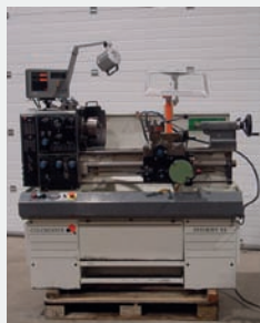
Tour COLCHESTER type STUDENT VS3000 à variateur de vitesse Entre-pointes 720 mm Ø maxi sur le banc 300 mm Ø maxi au-dessus du trainard 200 mm
