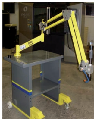
AV Bras de taraudage pneumatique Capacité de taraudage M3-M22 Avec système de lubrification Table en acier - Boite de vitesse (400/115 tr/min) - Puissance : 31/85 N/m Roues d'atelier - Disponible et sous tension - Tél : 06 88 21 67 62
