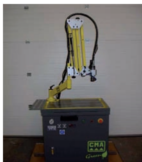
AV Bras de taraudage hydraulique Capacité de taraudage M3-M24 Avec système de lubrification Table rainurée en fonte : 800 x 600 Variateur de vitesse (475 tr/min) Puissance 105 N/m - Tachymètre digital - Groupe hydraulique Disponible et sous tension Tél : 06 88 21 67 62
