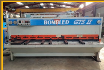
Cisaille guillotine BOMBLED GTS II 3006 Capacité : 3050 x 6 mm
