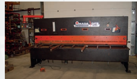
Cisaille hydraulique AMADA type GPS 630 Capacité 3050 x 6,35 mm Longueur de la butée arrière 1000 mm
