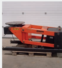
Positionneur 3 axes KEMPPi type 800 SNH Capacité maxi 800 kg Inclinaison de 0 à 135° maxi Ø du plateau 620 mm
