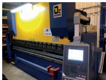
AV Presse plieuse CNC OZBORN PSH 32/125 S - Année 2012 4900 heures sous tension - Axes numérisés : Y1, Y2, X, R et V Puissance : 125 T - Longueur de pliage : 3200 mm - Distance entre montant : 2700 mm - Ouverture : 500 mm - Col de cygne : 350 mm - Dispositif de bombée de table contrôlé par la commande numérique - Système Cybelec type DNC 880 S - Ecran couleur 10,4" Système Windows XP - Graphique 2D - Tél : 01 34 73 36 85
