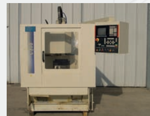
Centre d'usage 3 axes REALMECA type CU 300V Courses X 300 mm - Y 250 mm Z 250 mm - CN : NUM 1040 Magasin : 12 outils
