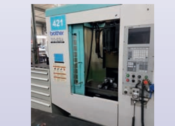
CUV BROTHER TC22A Comande Brother CNC A00 - Année 1999 Table 400 x 650 mm - Courses 500 x 400 x 410 mm - Broche BT 30 - 12 000 tr/mn - Magasin 25 outils - Diviseur 4 ème axe continu Nikken Plateau 220 mm - Manivelle électronique
