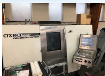
Tour CNC DMG CTX 320 V6 Avec axe Y - Outils motorisés Dia 250 x 700 mm CNC Siemens 840 TBE
