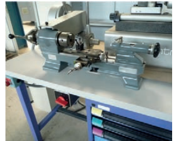
AV Tour conventionnel SCHAUBLIN 70 sur établi - Passage sur le banc : 130 mm - Distance entre pointes : 275 mm - Armoire électrique neuve Chariot croisé - Machine en très bon état - Tél : 04 77 73 00 82
