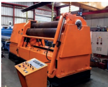
AV Rouleuse croqueuse hydraulique PICOT CRH 2522 - Capacité : 2500 x 22/18 mm - Prix de vente : 15 000 Euros HT - Tél : 04 42 96 48 00 Mail : service.commercial@vamo.fr
