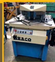
Encocheuse à angles variables HACO VARI 220/6 Capacité : 220 x 6 mm
