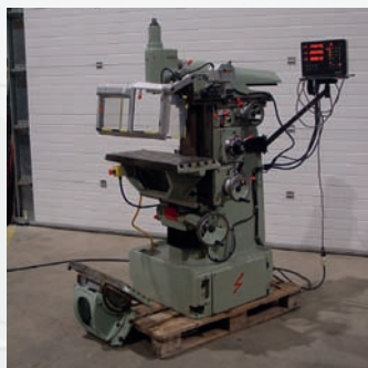
Fraiseuse d'outillage BEIJING type X8130 Course X 400 mm - Y 200 mm - Z 400 mm Année de construction 1989 Visu 3 axes HEIDENHAIN
