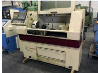
AV Tour par apprentissage HARRISON Alpha 13330 Plus S - De 2003 - CNC Fanuc 20 T avec Manuel Guide - Dia. : 330 x 1000 Tél : 03 88 72 02 47
