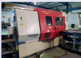
Tour CNC NAKAMURA SC 300 CNC Fanuc 3 axes Outils motorisés TBE
