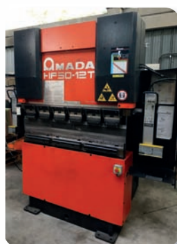
Presse plieuse AMADA HF 50 T x 1200 4 axes
