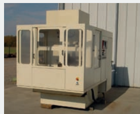
Centre d'usage REALMECA type CU 300H Courses X 320 mm - Y 350 mm Z 250 mm - CN : NUM 1060 Magasin : 20 outils
