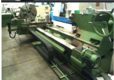
TOUR PAR APPRENTISSAGE TOS SU 125 VARIANT HEIDENHAIN MANUAL PLUS Diamètre sur le banc : 1250 mm Diamètre sur le chariot : 940 mm Distance entre-pointes : 5000 mm
