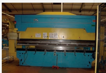
Presse plieuse COLLY type PS 2000 LS Capacité 125 T x 4000 mm Commande CYBELEC DNC 80
