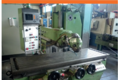
FRAISEUSE HURON PU 771 VISU 3 AXES HEIDENHAIN Courses XYZ 1900 X 1000 X 1000 mm
