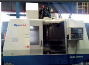
CENTRE D'USINAGE VERTICAL DAEWOO MYNX 500 FANUC 21 M Courses X Y Z : 1020,510,575mm Vitesse max de la Broche : 8 000 tr/min
