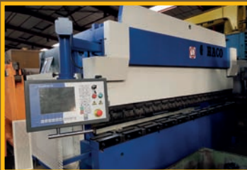
Presse plieuse CNC HACO ERM43150 150 T x 4300 mm Rétrofit CNC EASYBEND 2D
