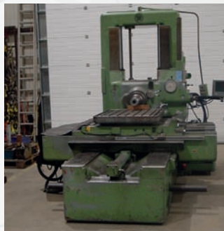
Pointeuse DIXI type 75 ON Courses X 780 mm - Y 680 mm Z 430 mm - Sortie de broche 750 mm Table rotative 870 x 700 mm
