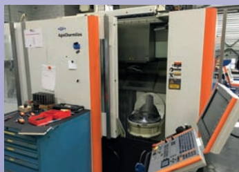
CUV 5 axes MIKRON HPM 450 De 2012 Courses 540 x 450 x 400 Broche 20 000 trs/min Heidenhain ITNC 530 Magasin 7 palettes de 450 x 450
