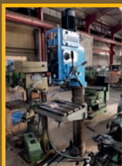
Perceuse à colonne IBARMIA B50 Capacité : 50 mm
