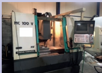
CUV TRENS TOS MC 100 V De 1998 TNC 426 Heidenhain 1000 x 600 x 600 mm
