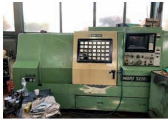
AV Tour CNC 2 axes MORI SEIKI type SL 25 - Année 1988 - ø maxi en barre : 68 mm - ø admissible au dessus du banc : 520 mm - ø sur glissière transversal : 350 mm ø usinable standard : 260 mm Distance entre pointe : 500 mm Vitesse de broche : 35-3500 tr/ min - Puissance broche : 15/11 kw Type de broche : A2-6 - Alésage de broche : 80 mm - Tourelle : 12 postes Course fourreau contrepointe : 100 mm - Commande CNC Fanuc 10T Graphique conversationnelle Mandrin 3 mors ø : 200 mm - Contre pointe CM4 à fourreau hydraulique Palpeur outils - Convoyeur à copeaux - Tél : 01 34 08 42 44
