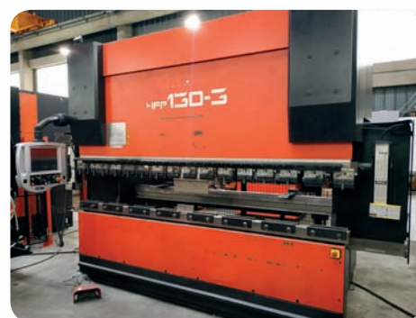
Presse plieuse AMADA HFT 130 T x 3100 8 axes
