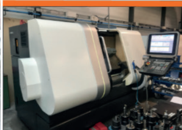
TOUR CNC DMG NEF 400 Cnc SIEMENS, Année 2010 Entre pointes : 800 mm Passage sur le banc : ø 400 mm
