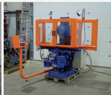
Fraiseuse universelle DUFOR type F194 Courses X 800 mm - Y 300 mm - Z 400 mm Cône SA40 Visu 3 axes HEIDENHAIN
