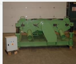
Vibrateur 4 bacs WALTHER type TA.4/72 Dimensions bacs : 800 x 250 x ht 300 mm Armoire électrique neuve
