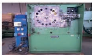
BIHLER RM30 – 1981 Coulisseaux multiples Feuillard jusqu'à max. 40mm Fil jusqu'à max. 3mm Prix sur demande
