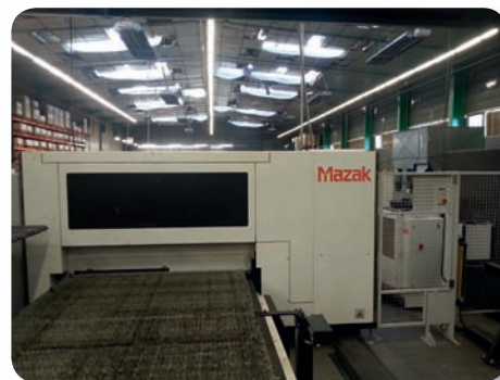
Laser MAZAK OPTIFLEX Fibre 2000 W Année 2012
