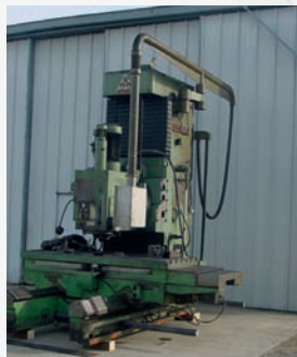
Fraiseuse verticale DROOP & REIN FS130 Courses X 2000 mm - Y 1000 mm Z 1000 mm - Broche SA50 Table 2400 x 1070 mm Visu 3 axes HEIDENHAIN
