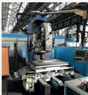
Fraiseuse verticale BOKO type 30 Course X 1400 mm - Y 1000 mm Z 980 mm Cône SA50 Visu 3 axes HEIDENHAIN
