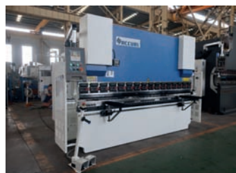
AV Presse plieuse hydraulique ACCURL - Type MB7 3200 x 125 T - Neuve - Puissance : 125 tonnes Longueur de pliage : 3200 mm Entre montant : 2550 mm - Col de cygne : 320 mm - Puissance : 11 kw Encombrement machine : 3790 x 1935 x 2420 mm - Poids : 8000 kg Système de contrôle : Elgo P40 NC (écran tactile) - Nombre d'axes : 2 axes (Y, X) - Bombé de table manuel - Affichage graphique 2D Protection latérale par laser DSP Prix de lancement à partir de : 34 500 Euros - Tél : 01 34 73 36 85 Mail : lgmo95@orange.fr
