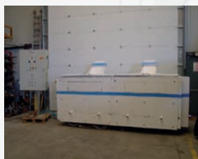
Vibrateur bac droit PARKER Sparatron SP 30/2 Année de construction 1990 Cuve : Lg 2800 x l 1500 x ht 500 mm Revêtement en TBE
