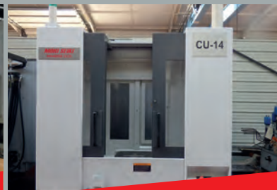
Centre d'usinage horizontal MORI SEIKI NH4000 DCG - Dimensions palette 400 x 400 mm CN MSX 501 III - Courses 560 x 560 x 630 mm Broche 20 000 trs/min - Arrosage centre broche 4 ème axe continu
