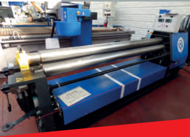
Rouleuse hydraulique 3 rouleaux ROUNBLED R2003 Longueur utile 2100 mm Épaisseur 2 mm
