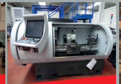
Tour par apprentissage CNC STYLE 350 - Année 2015 ø sur banc 350 mm - Longueur entre pointes 850 mm - VDI 30
