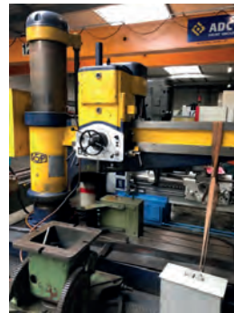
AV Perceuse radiale GSP - Type 407 Q17 Machine sur socle et fournie avec table IPAC - Cône de broche : CM 5 - Rayon max. de perçage : 1960 mm - Rayon mini. de perçage : 590 mm - Course de la broche : 400 mm - Hauteur mini. sous broche : 350 mm - Hauteur max. sous broche : 1550 mm - Tél : 06 07 68 86 74 Mail : lgmo95@orange.fr
