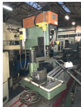
AV Perceuse d'établi SOLID - Type TB 16 S - Capacité de perçage dans l'acier : 16 mm - Longueur de table : 415 mm Largeur de table : 350 mm - Cône de broche : 2 CM - Ecartement : 245 mm Course de la broche : 120 mm - Vitesses de broche : de 250 t/min à 4000 t/min TBE - Tél : 03 88 72 02 47
