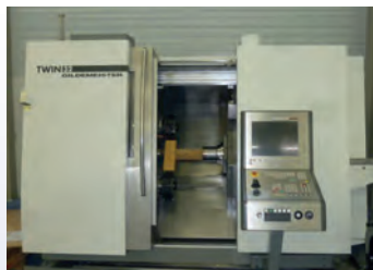
Tour CNC GILDEMEISTER Twin 32 De 2007 Avec LNS CNC Siemens 840 D
