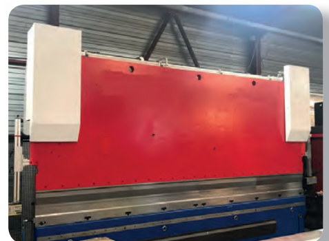
Presse plieuse BEYELER PR6 150 T x 3000 6 axes
