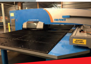
Poinçonneuse électrique FINN POWER ESX - Année 2011 Courses 2584 x 1317 mm Tourelle 20 postes - 1450 heures - Etat neuf
