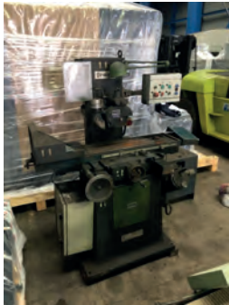
AV Rectifieuse plane PRAGA - Type 452 PA licence JONES & SHIPMAN 540 PA - Année 1995 - Prise de passe auto Dimensions table : 457 x 152 mm Dimensions meules : 180 x 13 x 31,75 mm - Vitesse de la meule : 3000 t/min Puissance de la poupée porte meule : 1,5 kw - Prix : 3 800 Euros HT Tél : 06 07 68 86 74
