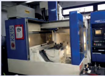
CUV 5 axes HURON KX 15 De 2002 CNC Siemens 840D Shopmill Courses 1000 x 800 x 550 mm
