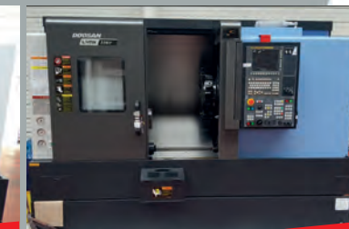
Tour DOOSAN Lynx 220 LYC CN FANUC OiT-D ø maxi d'usinage 300 mm Longueur 510 mm
