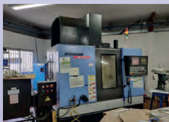
CUV DOOSAN DAEWOO Type NM 410 HS de 2008 Courses 762 x 410 x 510 Broche 20 000 tr/min CNC Fanuc 21 IMB
