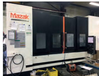
AV Centre d'usinage vertical à CN 5 axes MAZAK VTC 800/30 SR - Année 2012 CN - Armoire Matrix 2 - Courses XYZ : 3000 x 800 x 720 mm - Table : 3500 x 820 mm - Tél : +33 4 77 36 59 90 Mail : axel@axel-machines.com
