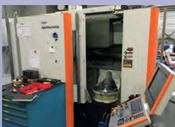
CU 5 axes MIKRON HPM 450 De 2012 Courses 540 x 450 x 400 Broche 20 000 trs/min Heidenhain ITNC 530 Magasin 7 palettes de 450 x 450
