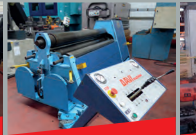
Rouleuse hydraulique 4 rouleaux DAVI MCA 2020 Capacité 2050 x 10 mm
