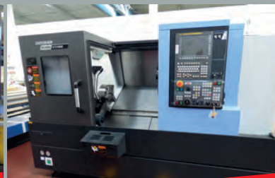
Tour DOOSAN PUMA GT2100B CN FANUC I Series ø maxi d'usinage 390 mm Longueur maxi 550 mm
