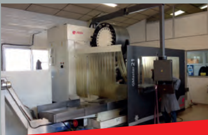
Fraiseuse à banc fixe LAGUN G Master 21 Surface de la table 2100 x 900 mm Courses 2000 x 1000 x 1000 m
