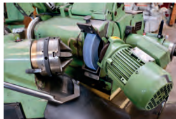
AV Affûteuse de forêts automatique ULRICH KLINGEL BSA - Mandrins de serrage à 6 mâchoires de précision : No. R 269 - \varnothing de serrage : 3-40 mm - Marque Röhm concentricité : 0,04 mm - Vitesse d'outils : 6 - 60 trs/min - Capacité de commande d'outils : 0,09 kW Tél : 03 88 68 01 37 - Mail : info@cpmo.fr
