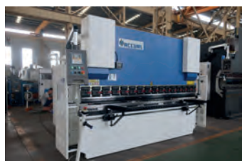
AV Presse plieuse hydraulique ACCURL Type MB7 3200 x 125 T - NEUVE - Puissance : 125 tonnes - Longueur de pliage : 3200 mm - Entre montant : 2550 mm - Col de cygne : 320 mm - Puissance : 11 kw - Encombrement machine : 3790 x 1935 x 2420 mm - Poids : 8000 kg - Système de contrôle : Elgo P40 NC (écran tactile) - Nombre d'axes : 2 axes (Y, X) - Bombé de table manuel - Affichage graphique 2D - Protection latérale par laser DSP - Prix de lancement à partir de : 34 500 Euros - Tél : 01 34 73 36 85 Mail : lgmo95@orange.fr
