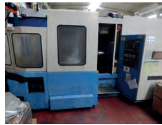
AV Centre d'usinage HYUNDAI - Type SPT H500S - CN Siemens Sinumerik Palette : 500 x 500 mm - Courses : 710 x 700 x 800 mm - Tél : 05 61 78 85 85
