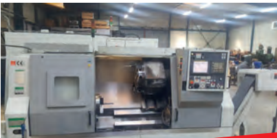
Tour CMZ TBI 520M CNC FANUC 21iTB - Année 2008 - ø maxi d'usinage 400 mm - Longueur maxi 1090 mm Axe C - Outillage
