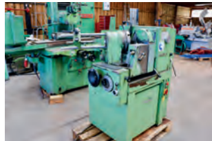
AV Affûteuse automatique de forêts SCHLUMBERGER - \varnothing des forêts : 10 à 80 mm - Longueur maxi des forêts : 720 mm - Nombre de lèvres : 2 - 3 - 4 - Coupe : droite ou gauche - Angle de pointe : 80° à 160° - Tél : 03 88 68 01 37 Mail : info@cpmo.fr
