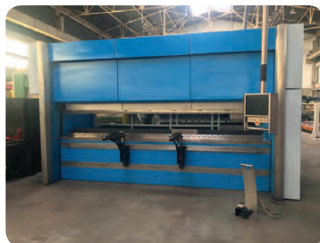
Presse plieuse FINN POWER E-Brake 200 T x 4000 6 axes
