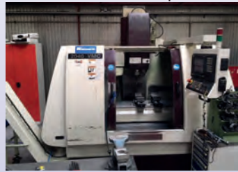
CUV CHEVALIER VMC 2040 De 2000 Courses 1020 x 510 x 510 CNC Siemens 810 D
