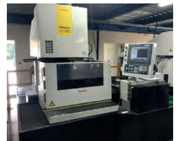
AV Découpe fil FANUC ALPHA 1i-E Année 2012 - Courses : 600 x 400 x 400 Dim pièces : 1050 x 775 x 310 Z auto Enfilage auto - Machine en parfait état Tél : 06 75 63 02 64
