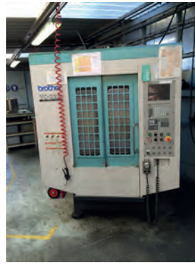
AV Centre BROTHER TC 22 A - De 1999 Broche refaite - Courses : 500 x 400 x 410 - 12 000 tr/min - TBE Tél : 03 88 72 02 47
