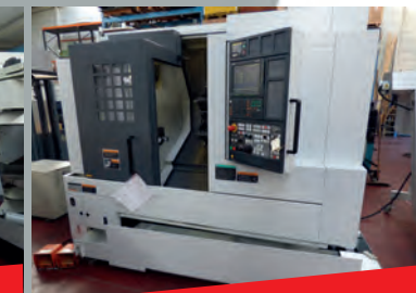
Tour MORI SEIKI NL 1500MC 500 CN FANUC MSX-850 III ø maxi d'usinage 356 mm Longueur d'usinage 504 mm - Axe C
