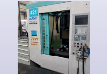
CUV BROTHER TC22A Commande Brother CNC A00 - Année 1999 Table 400 x 650 mm - Courses 500 x 400 x 410 mm - Broche BT 30 - 12 000 tr/mn - Magasin 25 outils - Diviseur 4 ème axe continu Nikken Plateau 220 mm - Manivelle électronique
