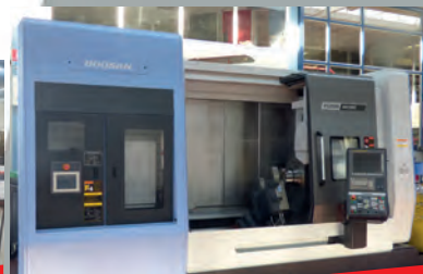
Centre de tournage fraisage DOOSAN SMX 2600S - CNC FANUC 31iB ø maxi d'usinage 660 mm - ø en barre 81 mm Longueur maxi 1540 mm - Magasin 80 outils Lunette AUTOBLOCK
