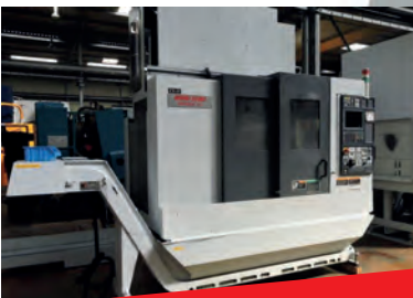
Centre d'usinage vertical MORI SEIKI NV5000 Alpha 1A/40 CN FANUC MSG 501 - Table 1900 x 600 mm Courses 800 X 510 X 510 mm Chargeur de palettes
