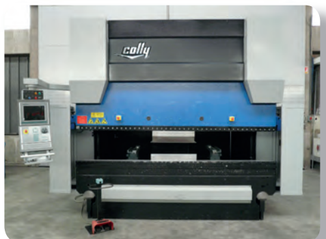
Presse plieuse COLLY PS3000 LS 100 T x 3000 8 axes
