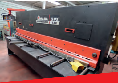
Cisaille guillotine AMADA GPX 630 Capacité 3000 x 6 mm Réglage de l'angle de coupe et du jeu entre lames automatiques
