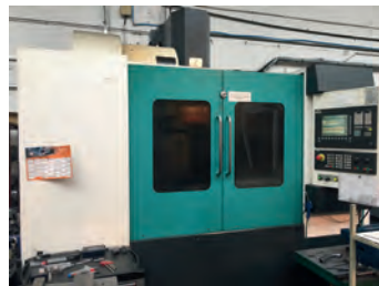
AV Centre d'usinage vertical HURON VX12 - Année 2008 - CN Siemens 840D (Shop Mill) - Courses XYZ : 1220 x 600 x 610 mm - Table : 1400 x 630 mm Tél : +33 4 77 36 59 90 Mail : axel@axel-machines.com
