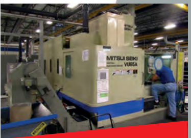
Centre d'usinage MITSUBI SEIKI VU65A Année 2008 - Table 1500 x 600 mm - Courses 1280 x 650 x 610 mm - Broche 15000 trs min 30-27 kW - 120 outils - Règles de mesure
