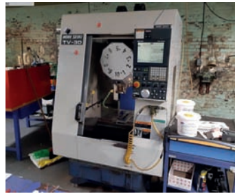
AV Centre d'usinage vertical MORI SEIKI TV 30 - Année 1996 - Courses XYZ : 420 x 300 x 250 mm - CNC Mitsubishi MSC 802 M iso + conversationnel - Magasin : 10 outils BT 30 - Vitesse de broche : 8000 rpm - Tél : 03 88 72 02 47
