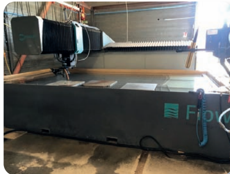
Découpe Jet d'eau FLOW IFB 3020 3000 x 2000 - Année 2011 6000 bars - 5 axes
