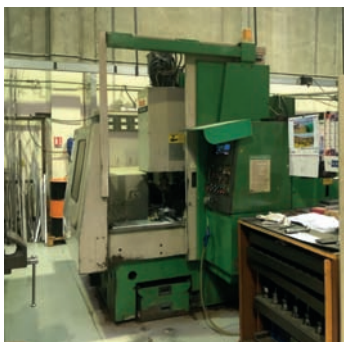
AV Centre d'usinage MAZAK VQC 15/40 Année 1990 - Mazatrol M32 - Courses XYZ : 560 x 410 x 380 mm - Longueur de table : 410 mm - Largeur de table : 900 mm - Magasin outils : 16 - Cône de broche : CAT 40 - Tél : 06 07 68 86 74 Mail : lgmo95@orange.fr
