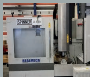
Centre d'usinage vertical 5 axes SPINNER U5-620 CN SIEMENS 840DSL - ST 650 mm Courses 620 x 510 x 460 mm Année 2015
