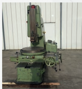
Mortaiseuse verticale KLOPP SK 550 Course table longitudinale 750 mm Course table transversale 600 mm Course coulisseau 550 mm Plateau Ø 775 mm
