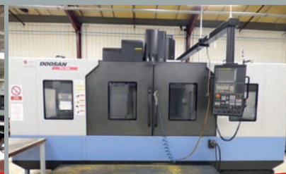
Centre d'usinage vertical DOOSAN VM750L - CN FANUC 31i ST 1900 x 800 mm Courses 1800 x 750 x 800 mm - Année 2013
