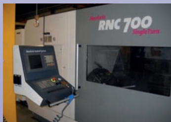
Tour MONFORTS RNC 700 - De 2007 TBE - CNC Fanuc langage Iso et Fapt ø devant le banc 720 mm - ø devant la tourelle 550 mm - Puissance 30/37 kW Longueur usinable 1500 mm - Vitesse 8/4000 rpm - Tourelle 12 outils VDI de 60
