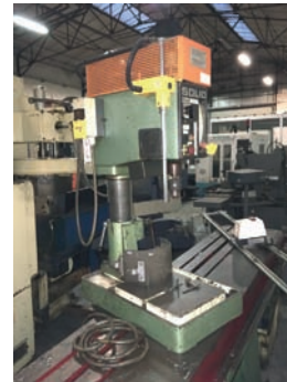
AV Perceuse d'établi SOLID - Type TB 16 S - Capacité de perçage dans l'acier : 16 mm - Longueur de table : 415 mm - Largeur de table : 350 mm - Cône de broche : 2 CM - Ecartement : 245 mm - Course de la broche : 120 mm - Vitesses de broche : de 250 t/min à 4000 t/min TBE - Tél : 03 88 72 02 47
