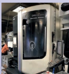
CU 5 axes DMG DMU 60 Evo De 2011 CNC Heidenhain iTNC 530 TBE
