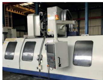
AV Centre d'usinage vertical HARTFORD Vmc 1600A - Heidenhain TNC 426 Année 2001 - Table : 1700 x 7500 mm Charge admissible sur la table : 1500 kg Courses XYZ : 1600 x 820 x 620 mm Distance mini nez de broche table : 1800 mm - Distance maxi nez de broche table : 808 mm - Distance axe de broche / colonne : 800 mm - Vitesse maxi de broche : 8000 tr/min - Cône de broche : BT50 - Magasin 32 outils Tél : 04 77 73 00 82 Mail : cmo42@machine-cmoi.com
