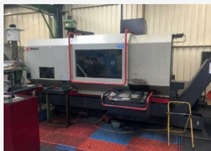
Tour CNC ERNAULT HES 52 A Entre-pointes 1100 mm CN NUM 750 T-GC Année de construction 1994
