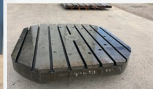
Taques en acier rainurées 1600 x 1600 x épaisseur 250 mm Poids env 2,5 T
