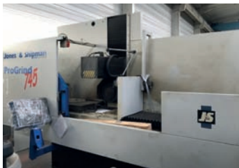
AV Rectifieuse plane JONES & SHIPMAN Progrind 745 Easy - ST : 1000 x 400 mm Courses : 950 x 465 x 595 mm Tél : 05 61 78 85 85
