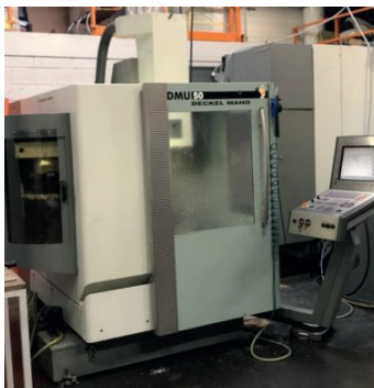
AV Centre d'usinage DMU 50 - Année 2004 - CN Heidenhain iTNC 530, 4 axes + 1 - Dim. de la table : 500 x 380 mm Courses XYZ : 500 x 420 x 380 mm Nombre d'outils : 16 - Nombre d'heures de la broche : 6 400 heures Tél : 04 77 73 00 82 Mail : cmo42@machine-cmoi.com
