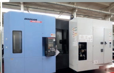
Centre d'usinage horizontal DOOSAN NHM5000 - CN FANUC Palette 500 x 500 mm Courses 800 x 700 x 850 mm - Année 2013
