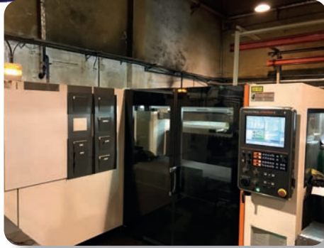
Laser MAZAK OPTIPLEX 3015 4000 W Année 2012
