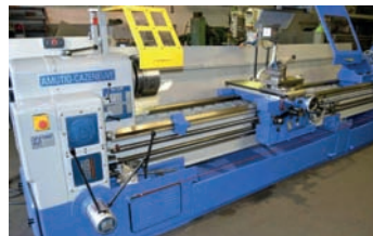
AV Tour parallèle CAZENEUVE - Type HB 725 x 4000 - Reconstitué - Distance entre pointe : 4000 mm - Hauteur de pointe : 315 mm - ø admis au dessus du banc : 725 mm - ø admis dans le rompu : 920 mm - ø admis au dessus du trainard : 670 mm - ø admis au dessus du chariot : 400 mm - Alésage broche : 81 Conicité de la contre pointe : CM6 Course maxi du chariot transversal : 400 mm - Nombre de vitesses de broche : 18 Rapides longitudinales Tél : 06 07 68 86 74
