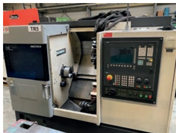
AV Tour à commande numérique HWACHEON - Type CUTEX 160 - Année 2009 - CNC Siemens - ø au dessus du banc : 550 mm - ø de tournage (std/maxi) : 170/300 mm - Longueur de tournage (maxi) : 300 mm - Nez de broche : A2-5 - Vitesse maximum : 6000 t/mn - Alésage de broche : ø 56 mm - Passage en barre : ø 45 mm - Moteur : 7,5/5,5 kW - Nombre d'outils : 12 - Dimensions de l'outil : carré 25 x 25 et ø 32 mm - Temps d'indexation : 0,15 s - Prix : 24 900 Euros Tél : 06 07 68 86 74 Mail : lgmo95@orange.fr
