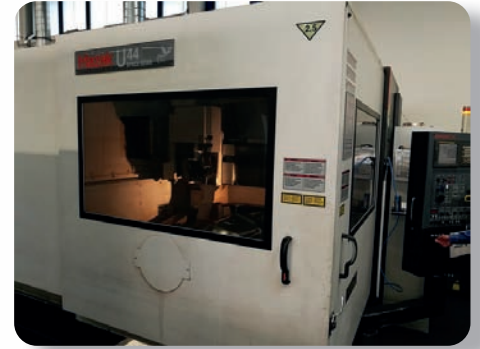
Laser MAZAK SPACE GEAR U44 2500 W Année 2011
