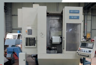
Centre d'usinage 5 axes WILLEMIN MACODEL W428 CN FANUC 16i - ø plateau 500 mm Courses 800 x 500 x 630 mm
