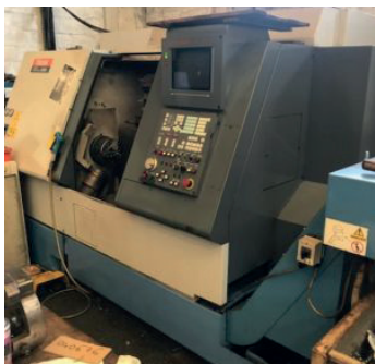
AV Tour CNC MAZAK SQT 200 - Année 1998 - CN Mazatrol T+ - ø sur banc : 300 mm - Longueur entrepointes : 500 mm Tél : 04 77 73 00 82 Mail : cmo42@machine-cmoi.com
