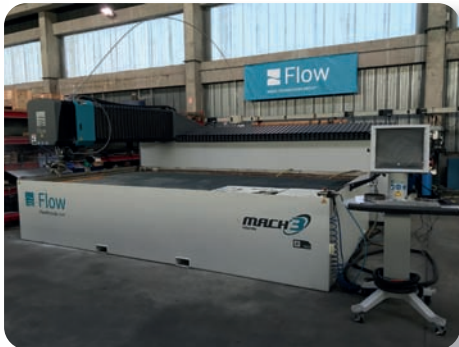
Découpe Jet d'eau FLOW Mach3 4020b 4000 x 2000 - Année 2016 4000 bars - 5 axes
