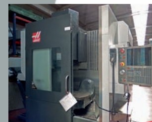
Centre d'usinage vertical 5 axes HAAS UMC 750 - CN HAAS ø plateau 500 x 500 mm Courses 762 x 508 x 610 mm - Année 2014
