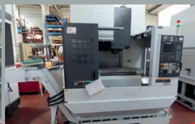
Centre d'usinage MORI SEIKI NV 5000 CN FANUC ST 950 x 480 mm Courses 800 x 500 x 500 mm - 2 palettes
