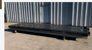
Taque en fonte rainurée 5020 x 1500 x épaisseur 320 mm Poids env 6,5 T
