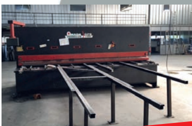
Cisaille guillotine AMADA GPS640 Capacité 4000 x 6 mm
