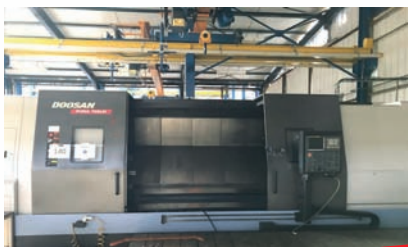
Tour DOOSAN PUMA 700LM CN FANUC 32iA - ø maxi d'usinage 900 mm Longueur maxi 3200 mm - Axe C Année 2013
