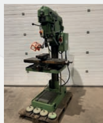
Perceuse à colonne ALZMETALL AB4/SV Broche CM4 Sortie de broche 150 mm Course table X 400 mm / Y 250 mm Profondeur col de cygne 350 mm
