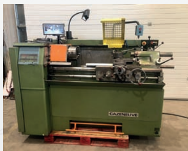
Tour parallèle CAZENEUVE HBX 360 BC Entre-pointes 800 mm Ø maxi sur le banc 400 mm Ø maxi au dessus du trainard 200 mm
