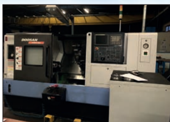
Tour CNC DOOSAN PUMA 300 De 2008 - CNC Fanuc 21i T B Capacité de barre 77 mm Mandrin 300 - ø de coupe max 400 mm Longueur de coupe max 650 mm
