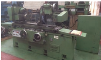
AV Rectifieuse cylindrique universelle DANOBAT 800RP - Distance entre pointes : 800 mm - ø sur le banc : 350 mm - Plongée auto - Plateau magnétique Broche inter - Tél : 06 75 49 57 65
