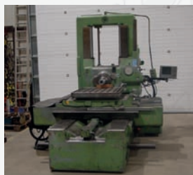
Pointeuse DIXI type 75 ON Courses X 780 mm - Y 680 mm Z 430 mm Sortie de broche 750 mm Table rotative 870 x 700 mm
