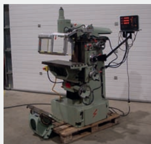
Fraiseuse d'outillage BEIJING X8130 Courses X 400 mm - Y 200 mm Z 400 mm Broches SA 40 verticale + horizontale Vitesse de rotation de 40 à 1600 t/min Visu 3 axes HEIDENHAIN
