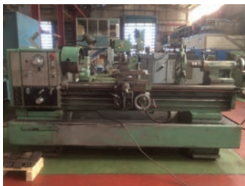
AV Tour parallèle HARRISON M500 x 1500 - ø sur le banc : 530 mm - Alésage de broche : 80 mm - Distance entre pointes : 1500 mm - ø admis dans le rompu : 730 mm - Vitesse de rotation de broche : 31-1600 Tpm - 1 lunette fixe Tél : 06 75 49 57 65
