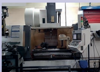
Centre vertical YCM NTV 158 B CNC Fanuc 31 I Courses 1520 x 760 x 700 BT 50 - 22 kw De 2009 - TBE
