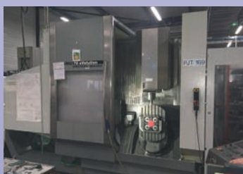
Centre 5 axes DMG DMU 70 Evo De 2003 Heidenhain iTNC 530 Courses 700 x 650 x 500 Broche 18000 t/min
