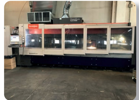
Laser BYSTRONIC Byspeed 3015 CO2 5200 W Avec chargeur / déchargeur
