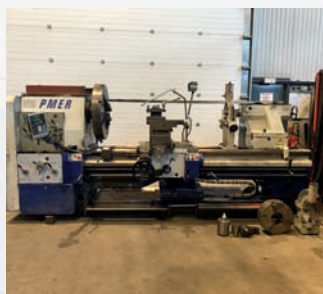
Tour parallèle PMER-ZMM C13SH Entre-pointes 2000 mm Ø maxi sur le banc 1000 mm Ø passage de broche 140 mm Année de construction 2006
