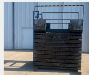
Cube de bridage en fonte 2000 x 1500 x 1200 mm Poids env 7 T
