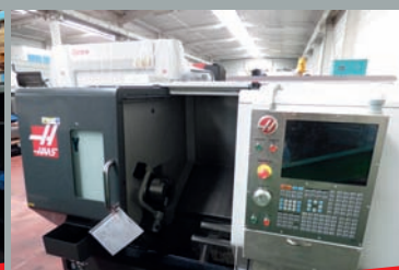
Tour HAAS ST-30Y ø d'usinage max 457 mm Longueur d'usinage 584 mm Axe C - Axe Y - Outillage
