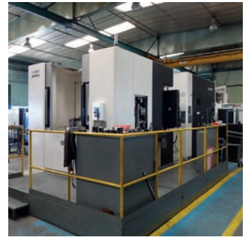
AV Centre d'usinage horizontal OKUMA Année 2014-2015 - Type MA-600H CNC OSP-P300M - Cône BT 50 Big + avec courses : X 1000 x Y 900 x Z 1000 Vitesse de broche : 6000 tr/mn Palette : 630 x 630 - Vitesse : 60 m/min - Magasin : 171 outils - Arrosage 70 bars au centre - Peu d'heures - Nouveau prix : 315 000 Euros avec milliers d'€ d'outillage et équipements Tél : 06 88 94 32 50 Mail : info@mfl-industrie.com
