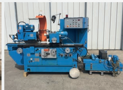
Rectifieuse cylindrique intérieure VOUMARD 5-S LP Ø de rectification de 5 à 200 mm Profondeur maxi de rectification 250 mm Longueur maxi des pièces 1000 mm
