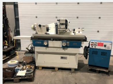
Rectifieuse cylindrique int/ext SIT U700 CA Ø de rectification 300 mm Longueur maxi de rectification 700 mm Prof maxi de rectification 122 mm Poids maxi de la pièce 120 kg
