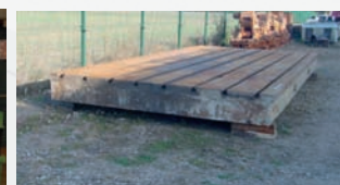
Taque en fonte rainurée 6030 x 2960 x épaisseur 350 mm Poids 22,5 T
