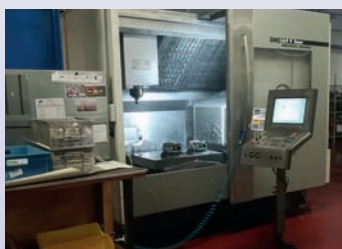
CUV DMG DMC 64 V LINEAR Année 2004 CNC Heidenhain TNC 530 Courses 640 x 600 x 500 mm TBE
