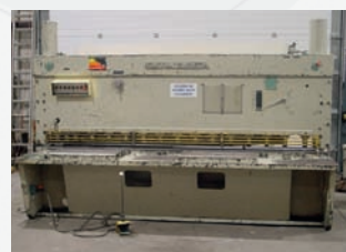
Cisaille hydraulique COMESSA CN 310 Capacité 3000 x 10 mm Butée arrière électrique Lg 850 mm
