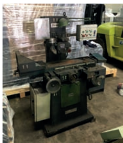
AV Rectifieuse plane PRAGA - Type 452 PA licence JONES & SHIPMAN 540 PA - Année : 1995 - Prise de passe automatique - Dimensions table : 457 x 152 mm - Dimensions meules : 180 x 13 x 31,75 mm - Vitesse de la meule : 3000 t/min - Puissance de la poupée porte meule : 1,5 kW - Prix HT : 2 500 Euros Tél : 06 07 68 86 74
