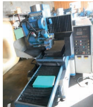
AV Rectifieuse plane LGB - Type R 8050 Courses : 800 x 500 - Automatiques 3 axes - Visible en bon fonctionnement Tél : 03 25 31 92 68 Mail : lemoine.mo@wanadoo.fr
