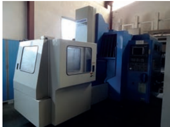
AV Centre d'usinage vertical HYUNDAI SPT-V32S/605 - Année 1999 - CN Siemens 840C - X 1500 x Y 700 x Z 460 mm - Broche : 3150 tr/min - ISO 50 Puissance : 20 KW - Table : 1740 x 650 mm - Rapides : X 24m/min, Y 30 m/min, Z 18 m/min - Changeur 30 outils - TBE Super prix : 15 000 Euros Tél : 06 88 94 32 50 Mail : info@mfl-industrie.com
