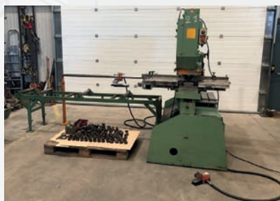
Cisaille/poinçonneuse PEDDINGHAUS PEDDIMAX 800 Capacité de poinçonnage Ø 31 x 20 mm Ø 100 x 6 mm Table 1000 x 430 mm Butée règle manuelle
