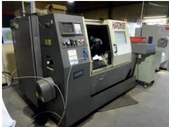
AV Tour CN HARDINGE Cobra 42 - CN Fanuc 21 - Mandrin auto Gamet diam 170 mm - Diam max 209 x longueur 255 mm - Rotation : 5000 tr/min - Puissance : 7,5 kW - VDI 12 positions - Convoyeur Contrepointe - 10 000 Euros - TBE Tél : 06 88 94 32 50 Mail : info@mfl-industrie.com
