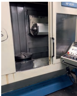
AV Centre d'usinage 5 axes WILLEMIN W428 - CN Fanuc 16i - Plateau : 500 mm Courses : 800 x 500 x 630 Tél : 05 61 78 85 85
