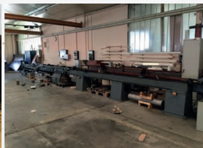
Rodeuse horizontale MAUSER Capacité de rodage maxi Ø 100 mm Lg de rodage 6000 mm Lg totale de la machine : 14 mètres Machine en 3 éléments
