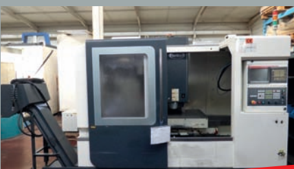
Centre d'usinage vertical HARTFORD PRO 1000 CN FANUC OiMD - ST 1150 x 600 mm Courses 1000 x 600 x 630 Année 2011
