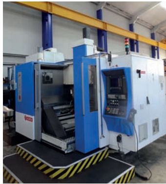
AV Centre de fraiseage 5 axes continu UGV - Type K2X8 - Année 2005/2006 en CNC Siemens 840D - Courses X (chariot sur portique) 1000 x Y (table) 700 x Z (vertical) 450 mm - Electrobroche : 16 000 tr/min - Puissance : 36 kW - Table circulaire diam : 500 mm à 2 axes : C rotation 360° vitesse 50 tr/min + A basculement -45°/+180° rotation 50 tr/min - Rapides : 50 m/min - Arrosage au centre : 50 bars - Magasin auto : 100 outils - Tél : 06 88 94 32 50 Mail : info@mfl-industrie.com
