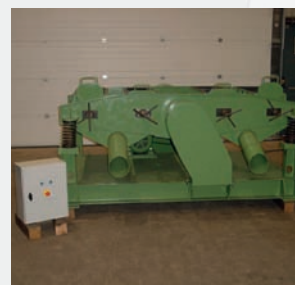
Vibrateur 4 bacs WALTHER type TA.4/72 Dimensions bacs : 800 x 250 x Ht 300 mm Armoire électrique neuve
