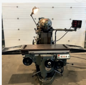
Fraiseuse universelle HURON NU3 Courses X 900 mm - Y 700 mm Z 500 mm - Broche SA 40 Table 1235 x 460 mm Vitesse de rotation de 30 à 2066 t/min
