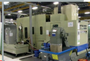
Centre d'usinage MITSUBISHI SEIKI VU65A Année 2008 - ST 1500 x 600 mm Courses 1280 x 650 x 610 mm Règles de mesure
