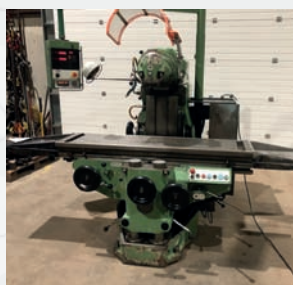
Fraiseuse universelle HURON MU5 - Variateur avances Courses X 1300 mm - Y 700 mm Z 500 mm - Broche SA 40 Table 1630 x 460 mm Vitesse de rotation de 30 à 2066 t/min
