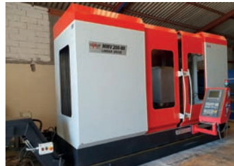
AV Centre d'usinage FAMUP - Année 2006 - X 2000 - Y 800 moteurs linéaires Z 700 - Table : 2400 x 800 - Charge : 4 T - CN Siemens 840D - Electrobroche Kessler (électrobroche garantie) 30 outils - Travail possible en pendulaire Tél : 06 20 75 70 37
