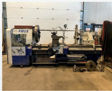
Tour parallèle PMER-ZMM C135H Entre-pointes 2000 mm Ø maxi sur le banc 1000 mm Ø passage de broche 140 mm Année de construction 2006
