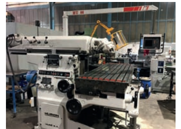
AV Fraiseuse HURON MU66 - Visue Courses : 1500 x 1000 x 550 mm Tél : 06 63 65 11 01
