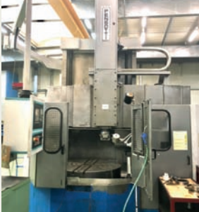
Tour vertical CNC PENSOTTI TP 1250 (rétrofit 2005)
