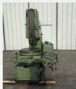
Mortaiseuse verticale KLOPP SK 550 Course table longitudinale 750 mm Course table transversale 600 mm Course coulisseau 550 mm Plateau Ø 775 mm
