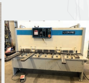
Cisaille hydraulique VUILLERMET 210H Capacité dans l'acier 2000 x 10 mm Capacité dans l'inox 2000 x 8 mm
