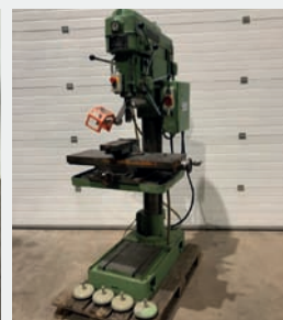
Perceuse à colonne ALZMETALL AB4/SV Broche CM4 Sortie de broche 150 mm Course table X 400 mm / Y 250 mm Profondeur col de cygne 350 mm
