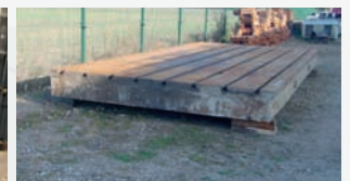
Taque en fonte rainurée 6030 x 2960 x épaisseur 350 mm Poids 22,5 T
