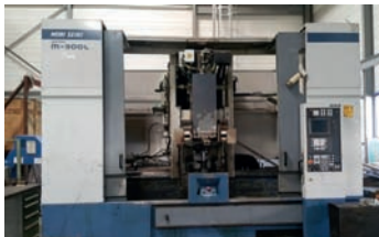
AV Centre d'usinage vertical MORI SEIKI M300L - ST : 830 x 540 mm (x2) - Courses : 1600 (2 x 600) x 500 x 470 mm Tél : 05 61 78 85 85
