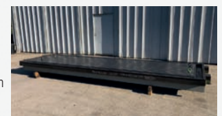
Taque en fonte rainurée 5020 x 1500 x épaisseur 320 mm Poids env 6,5 T
