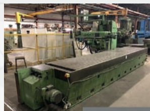
Fraiseuse à banc fixe HURON RU881 Courses X 3500 mm - Y 1000 mm - Z 1000 mm Table 5155 x 1000 mm Vitesse de rotation de 15 à 1500 t/min Visu 3 axes ACU-RITE
