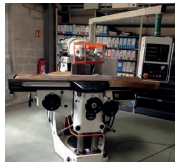
AV Fraiseuse conventionnelle HURON Type MU6 - Table : 2000 x 460 mm Courses : 1500 x 700 x 500 mm Commandes sur pendentif - Machine reconstruite - Tél : 05 61 78 85 85
