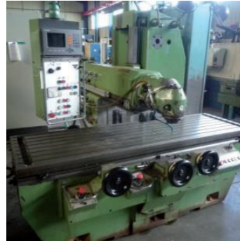
AV Fraiseuse banc fixe HURON PU 771 Surface de la table : 2235 x 700 mm Courses XYZ : 1900 x 1000 x 1000 mm Nombre de vitesses de broche : 27 Gamme des vitesses : 30 à 2066 tr/min Cône de broche : SA 50 - Nombre d'avances : 27 - Gamme des avances : 1,6 à 820 mm/min - Tél : 04 77 73 00 82
