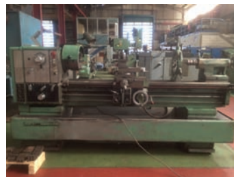
AV Tour parallèle HARRISON M500 x 1500 - ø sur le banc : 530 mm - Alésage de broche : 80 mm - Distance entre pointes : 1500 mm - ø admis dans le rompu : 730 mm - Vitesse de rotation de broche : 31-1600 Tpm - 1 lunette fixe Tél : 06 75 49 57 65
