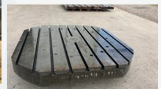
Taqes en acier rainurées 1600 x 1600 x épaisseur 250 mm Poids env 2,5 T
