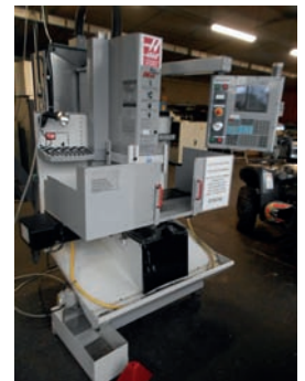
AV Fraiseuse CN HAAS - Type TM 1 HE Table : 1200 x 267 - Courses : X 760, Y 305, Z 406 - En bon état - Visible en fonctionnement - Tél : 03 25 31 92 68 Mail : lemoine.mo@wanadoo.fr
