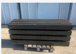
Cubes de bridage en fonte 1550 x 600 x 400 mm Poids env 1,2 T
