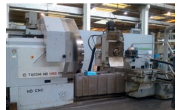
AV Tour TACCHI - Type HD 1450 - CN Num 1060 - ø sur banc : 1300 mm Entrepointe : 4000 mm - Axe C + Axe Y Tél : 05 61 78 85 85
