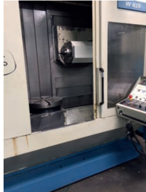
AV Centre d'usinage 5 axes WILLEMIN W428 - CN Fanuc 16i - Plateau : 500 mm Courses : 800 x 500 x 630 Tél : 05 61 78 85 85
