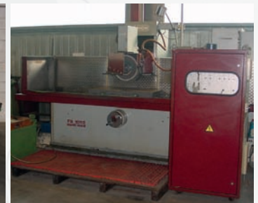
Rectifieuse plane ELB HAHN & KOLB FS1052 Courses X 1000 mm - Y 500 mm - Z 350 mm Année de construction 1989 Table 1600 x 550 mm Axes X-Y-Z : prise de passe auto
