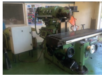
AV Fraiseuse HURON NU5 - Courses : 1300 x 700 x 550 mm - Table : 1635 x 460 mm - Cône de broche : SA40 Visualisation 3 axes Heidenhain Armoire électrique séparée Tél : 06 75 49 57 65
