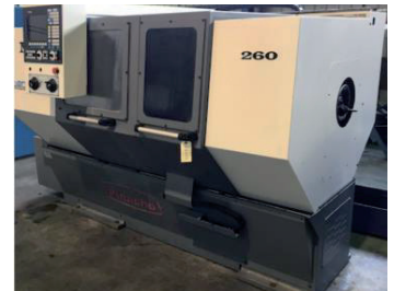
AV Tour CNC par apprentissage PINACHO Smart-Turn 8 260 Commande numérique : par auto apprentissage Fagor 8055 - Année : 2012 - Diamètre sur banc : 530 mm Hauteur de pointes : 260 mm - Longueur entrepointes : 1000 mm - Broche/cône : 5 - Gamme de vitesse de rotation : 0 2500 tr/min - Puissance broche : 17 kW Documentation complète - Tourelle automatique 8 positions - Mandrin 3 mors ø 315 mm - Tél : 04 77 73 00 82
