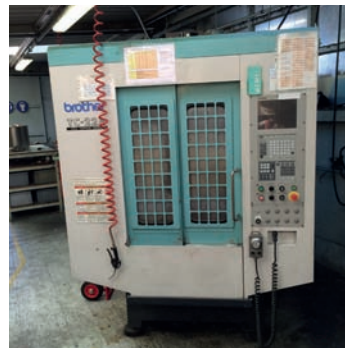
AV Centre BROTHER TC 22 A - De 1999 Broche refaite - Courses : 500 x 400 x 410 - 12 000 tr/min - TBE Tél : 03 88 72 02 47
