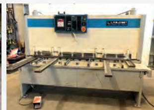
Cisaille hydraulique VUILLERMET 210H Capacité dans l'acier 2000 x 10 mm Capacité dans l'inox 2000 x 8 mm
