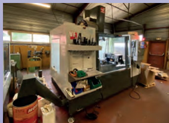
CUV HAAS VF 4 De 2015 Courses 1270 x 510 x 510 4 axes inclus Machine état neuf
