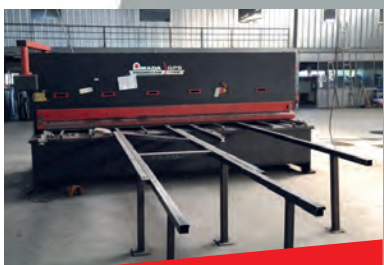
Cisaille guillotine AMADA GPS640 Capacité 4000 x 6 mm
