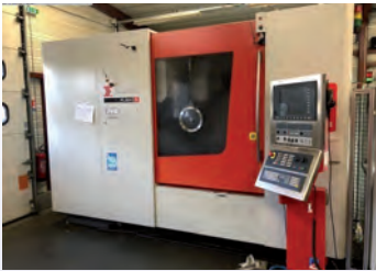
Centre 5 axes SIGMA FLEX 3 De 2015 CNC Siemens Courses 1150 x 600 x 600 TBE
