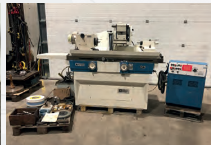
Rectifieuse cylindrique int/ext SIT U700 CA Ø de rectification 300 mm Longueur maxi de rectification 700 mm Prof maxi de rectification 122 mm Poids maxi de la pièce 120 kg
