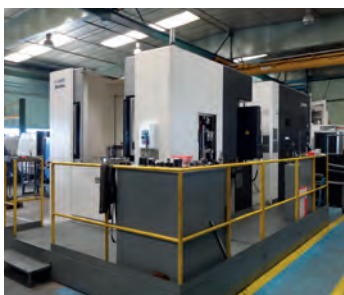
AV Centre d'usinage horizontal OKUMA Année 2014-2015 - Type MA-600H - CNC OSP-P300M - Cône BT 50 Big + avec courses : X 1000 x Y 900 x Z 1000 - Vitesse de broche : 6000 tr/mn - Palette : 630 x 630 - Vitesse : 60 m/min - Magasin : 171 outils - Arrosage 70 bars au centre - Peu d'heures - Nouveau prix : 315 000 Euros avec milliers d'€ d'outillage et équipements - Tél : 06 88 94 32 50 Mail : info@mfl-industrie.com
