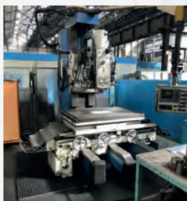
Fraiseuse verticale BOKO type F30 Courses X 1400 mm - Y 1000 mm Z 980 mm - Cône SA 50 Table 1400 x 1000 mm Visu 3 axes HEIDENHAIN
