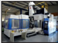
Centre UGV HURON 5 axes continu KX100 de 2002 CN Siemens 840 D Table 3300 x 1250 mm X 3200 x Y 2300 x Z 1000
