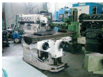
AV Fraiseuse HURON MU4 avec variateur Refaita - Repeinte - Nouvelle visu Heidenhain TBE - Tél : 03 88 72 02 47
