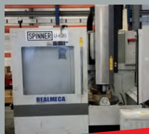
Centre d'usinage vertical 5 axes SPINNER U5-620 - CN SIEMENS 840DSL - ST 650 mm Courses 620 x 510 x 460 mm Année 2015
