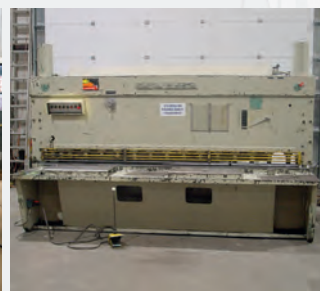
Cisaille hydraulique COMESSA CN 310 Capacité 3000 x 10 mm Butée arrière électrique Lg 850 mm
