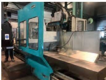
AV Fraiseuse ZAYER 20 KFU 3000 - Année 1997 - CN NUM 1060 - Courses XYZ : 2700 x 1200 x 1000 mm - Surface de la table : 3000 x 1000 mm - Cône de broche : ISO 50 - Vitesse de broche : 35 à 3000 tr/min - Prix : 45 000 Euros - Tél : 06 15 59 43 02
