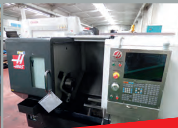
Tour HAAS ST-30Y ø d'usinage max 457 mm Longueur d'usinage 584 mm Axe C - Axe Y - Outillage
