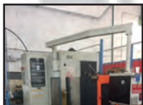
Fraiseuse HURON DX TT CN Heidenhain de 1985 Table 1350 x 700 mm
