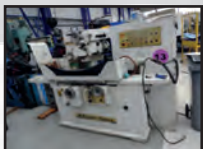
Rectifieuse plane ERNAULT SOMUA MH 650 Plateau magnétique 650 x 220 mm Hauteur de rectif 215 mm
