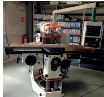
AV Fraiseuse conventionnelle HURON - Type MU6 - Table : 2000 x 460 mm - Courses : 1500 x 700 x 500 mm Commandes sur pendentif Machine reconstruite - Tél : 05 61 78 85 85
