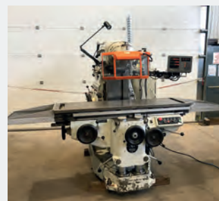
Fraiseuse universelle HURON MU5 Courses X 1300 mm - Y 700 mm Z 500 mm Broche SA 40 Table 1635 x 460 mm Vitesse de rotation de 30 à 2066 t/min
