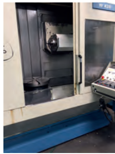
AV Centre d'usinage 5 axes WILLEMIN W428 CN Fanuc 16i - Plateau : 500 mm - Courses : 800 x 500 x 630 - Tél : 05 61 78 85 85
