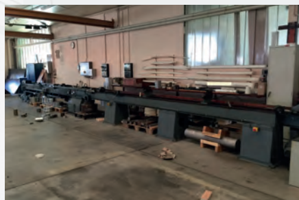
Rodeuse horizontale MAUSER Capacité de rodage maxi Ø 100 mm Lg de rodage 6000 mm Lg totale de la machine : 14 mètres Machine en 2 éléments
