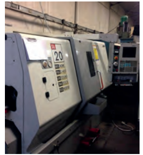
AV Tour CNC HAAS SL 20 THE (2004) - 3 axes CNC Haas - Dia : 584 x 533 mm - EP mandrin : 210 mm - Passage de barres : 51 mm Tél : 03 88 72 02 47
