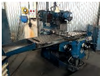
AV Fraiseuse HURON MU 5 - Année 1990 Courses XYZ : 670 x 400 x 1635 mm - Surface de la table : 460 mm - Cône de broche : SA 40 Vitesse de broche : 2066 rpm - Prix : 8 000 Euros - Tél : 06 15 59 43 02
