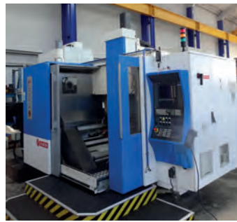
AV Centre de fraisage 5 axes continu UGV Type K2X8 - Année 2005/2006 en CNC Siemens 840D - Courses X (chariot sur portique) 1000 x Y (table) 700 x Z (vertical) 450 mm - Electrobroche : 16 000 tr/min Puissance : 36 kW - Table circulaire diam : 500 mm à 2 axes : C rotation 360° vitesse 50 tr/ min + A basculement -45°/+180° rotation 50 tr/min - Rapides : 50 m/min - Arrosage au centre : 50 bars - Magasin auto : 100 outils Tél : 06 88 94 32 50 Mail : info@mfl-industrie.com
