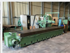
Fraiseuse à banc fixe HURON RU881 - Courses X 3500 mm Y 1000 mm - Z 1000 mm - Table 5155 x 1000 mm - Vitesse de rotation de 15 à 1500 t/min Visu 3 axes ACU-RITE
