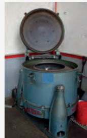
Essoreuse centrifugeuse à copeaux ROUSSELET type RAPIDE SC85KFO Contenance 240 L Charge maxi 150 kg Vitesse de rotation 650 t/min maxi
