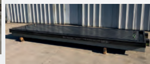
Taques en fonte rainurée 5020 x 1500 x épaisseur 320 mm Poids env 6,5 T + autres dimensions disponibles
