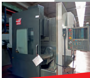
Centre d'usinage vertical 5 axes HAAS UMC 750 - CN HAAS ø plateau 500 x 500 mm Courses 762 x 508 x 610 mm - Année 2014
