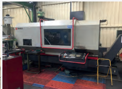
Tour CNC ERNAULT HES 52 A Entre-pointes 1100 mm CN NUM 750 T-GC Année de construction 1994
