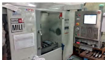
AV Centre d'usinage HAAS Super Mini Mill 16" x 12" - 405 x 305 x 254 mm - Cône ISO 40 Commande vectorielle 7,5 hp (5,6 kw) - 6000 tr/min - TBE - Tél : 03 88 72 02 47
