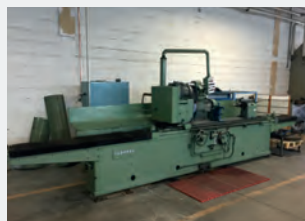
Rectifieuse cylindrique int/ext GENDRON RUP40 x 180 Entre pointes 1800 mm Hauteur de pointe 250 mm Ø de rectification 480 mm
