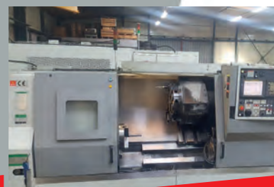
Tour CMZ TBI 520M CNC FANUC 21ITB - Année 2008 - ø maxi d'usinage 400 mm - Longueur maxi 1090 mm - Axe C - Outillage
