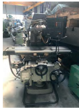
AV Fraiseuse GAMBIN 1M - Table : 1170 x 270 mm - Cône SA 40 - 1800 tr/min - Visu 3 axes Heidenhain - X 680 x Y 260 x Z 580 mm - Prix : 4 000 Euros - Tél : 06 88 94 32 50 Mail : info@mfl-industrie.com
