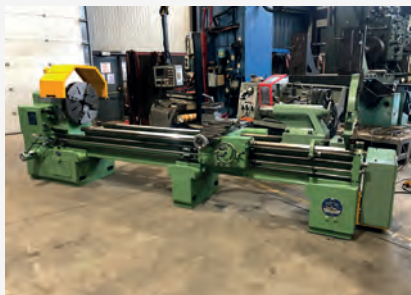
Tour parallèle CAZENEUVE HB 725 x EP 3000 mm Entre-pointes 3000 mm Ø maxi sur le banc 725 mm Ø au-dessus du trainard 430 mm - Ø rompu 960 mm Mandrin 4 mors Ø 600 mm
