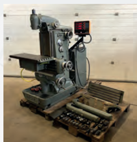
Fraiseuse universelle DECKEL FP2 Courses X 500 mm - Y 200 mm Z 390 mm - Cône SA 40 Table 700 x 285 mm Vitesse de rotation de 40 à 2000 t/min
