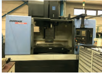
CUV DOOSAN MYNX 540 De 2007 Courses 1050 x 510 x 510 CNC Fanuc 21iT B Superbe état
