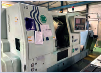
Tour BIGLIA B 550Y Fanuc 18 iTB Diam 400 x 550 long Axe C + Y TBE
