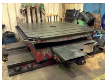
AV Table rotative SKODA 2000 x 2000 mm Charges : 25 tonnes - Tél : 06 63 65 11 01
