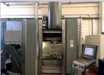
CUV DMG DMC 85 V LINEAR De 2002 Heidenhain iTNC 530 Courses 950 x 630 x 500 Broche 30 000 tr/min
