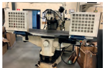
AV Fraiseuse HURON BASIC MU6 numérisée 3 axes CN Num 720 - Dimensions table : 2000 x 460 mm - Courses : X 1500 x Y 700 x Z 500 mm - Tête ISO 40 - Rotation : 30 à 2066 tr/ min - Cône ISO 40 - Tél : 06 88 94 32 50 Mail : info@mfl-industrie.com
