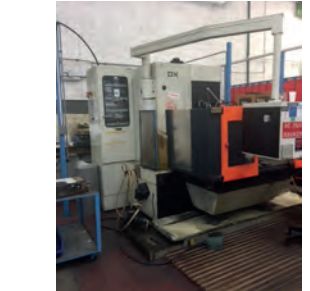
AV Fraiseuse HURON DX TT - Banc fixe - Table mobile - Année 1985 - Charge sur table : 1200 kg - Table : 1350 x 700 mm - Courses environ : X 1250 x Y 700 x Z 660 mm - Broche ISO 50 Vitesse : 30 à 2066 tr/min - Serrage auto des outils - Prix bas - Tél : 06 88 94 32 50 Mail : info@mfl-industrie.com
