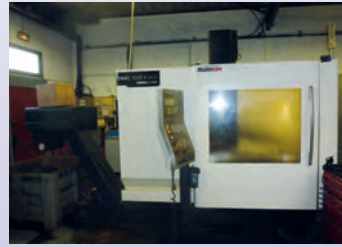
Centre vertical DMG DMC 1035 Courses 1020 x 600 x 600 CNC Siemens 840 D TBE
