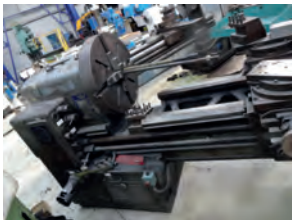
AV Tour parallèle CAZENEUVE HB 725 x 2000 mm avec rompu - Mandrin 4 mors ø : 600 mm - Lunette - Copieur - Etat médiocre Prix intéressant - Tél : 06 88 94 32 50 Mail : info@mfl-industrie.com
