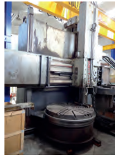
AV Tour vertical CN BERTHIEZ TFM 125 Num 1060 - Diam maxi : 1550 - Diam plateau : 1250 Hauteur maxi usinable : 1150 - Course coulant Z : 1000 - Rotation plateau : 2,5 à 315 tr/min Moteur principal : 65/55 kW - Charge admise : 10 T - Pas de fondations - Prix : 20 000 Euros !! - Tél : 06 88 94 32 50 Mail : info@mfl-industrie.com
