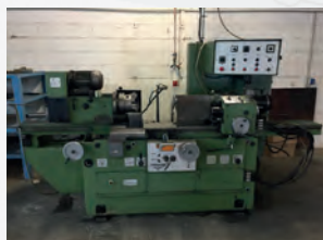
Rectifieuse cylindrique intérieure VOUMARD 5 ALP Ø de rectification de 5 à 200 mm Profondeur maxi de rectification 250 mm Longueur maxi des pièces 1110 mm
