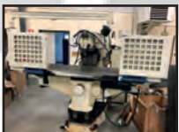
Fraiseuse HURON BASIC base de MU6 mais numérisée 3 axes avec CN Num 720 Table 2000 x 460 X 1500 x Y 700 x Z 500 Cône ISO 40
