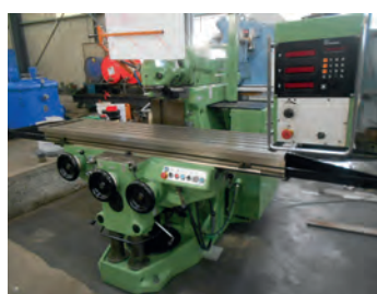
AV Fraiseuse HURON type MU 6 - Courses : 1500 x 700 Vert. 550 - Variateur de vitesse Machine rénovée - Tél : 03 25 31 92 68 Mail : lemoine.mo@wanadoo.fr
