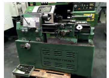
AV Tour VUILLEUMIER - HP : 125 mm Passage sur chariot : 130 mm - EP : 520 mm - Très bon état - Prix : 3 000 Euros - Tél : 03 88 72 02 47
