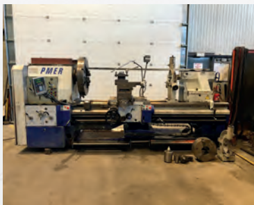
Tour parallèle PMER-ZMM C13SH Entre-pointes 2000 mm - Ø maxi sur le banc 1000 mm - Ø au-dessus du trainard 740 mm Ø passage de broche 140 mm Année de construction 2006
