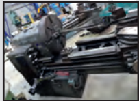
Tour parallèle CAZENEUVE HB 725 x 2000 mm avec rompu - mandrin ø 600
