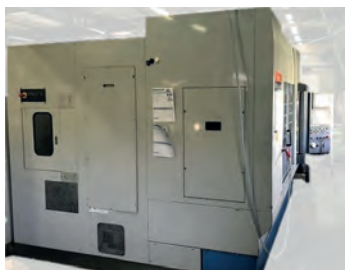
AV Centre vertical MAZAK VTC 200 - Année 2003 - CNC Mazatrol Fusion 640M - Table : 1460 x 510 mm - Courses : X 1120 x Y 510 x Z 510 mm - Broche : 10 000 tr/min - Puissance : 15 Kw - Changeur 30 outils - Arrosage au centre - Convoyeur - Tél : 06 88 94 32 50 Mail : info@mfl-industrie.com
