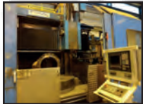
Tour vertical TITAN SC 22 CNC de 2007 avec axe C et outils tournants
