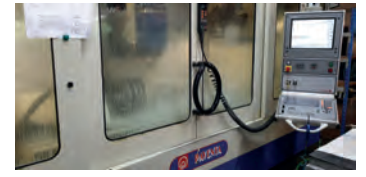
Centre vertical PAVENTA Courses 1700 x 700 x 700 CNC Heidenhain TNC 530 Diviseur 4 et 5 axes inclus TBE
