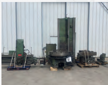
Tour vertical GRAFFENSTADEN TV1616 Ø maxi de tournage 1500 mm Ht maxi de tournage sous traverse 1400 mm Mandrin Ø 1400 mm Visu 2 axes HEIDENHAIN
