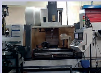
Centre vertical YCM NTV 158 B CNC Fanuc 31 I Courses 1520 x 760 x 700 BT 50 - 22 kw De 2009 - TBE
