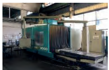
AV Fraiseuse ANAYAK VH PLUS V3000 - Année 2002 - CN Heidenhain 430 - Courses XYZ : 3000 x 120 x 1260 mm - Surface de la table : 3200 x 1100 mm - Cône de broche : ISO 50 Prix : 35 000 Euros - Tél : 06 15 59 43 02
