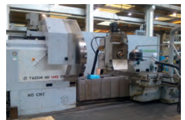
AV Tour TACCHI - Type HD 1450 - CN Num 1060 - ø sur banc : 1300 mm - Entrepoinde : 4000 mm - Axe C + Axe Y - Tél : 05 61 78 85 85
