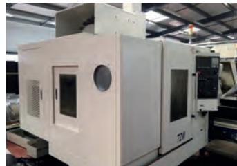
AV Centre d'usinage vertical DAHLIHC VMC 720 - Année 2007 Courses : 720 x 460 x 510 mm - Poids maxi pièce : 500 kg - Broche : 8000 tr/min - Cône BT 40 (30 cônes) - Changeur 24 outils - Commande Fanuc OiMC - Arrosage centre broche : 15 bars - Carter enveloppant Convoyeur à copeaux à tapis - Diviseur Nikken - Moteur de broche Fanuc 15 kW Tél : 04 74 73 80 48
