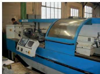
AV Tour CNC par apprentissage STANKO Krasny - De 2006 - CNC Fagor 8055TC - EP : 2000 x dia 600 mm - Tél : 03 88 72 02 47
