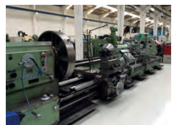
AV Tour POREBA TR 135 - Visue - Cap : 6000 x 1350 mm sur banc - Tél : 06 63 65 11 01
