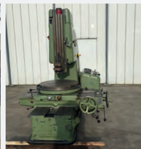
Mortaiseuse verticale KLOPP SK 550 Course table longitudinale 750 mm Course table transversale 600 mm Course coulisseau 550 mm Plateau Ø 775 mm
