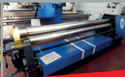
Rouleuse hydraulique 3 rouleaux ROUNDBLED R2003 Longueur utile 2100 mm Épaisseur 2 mm
