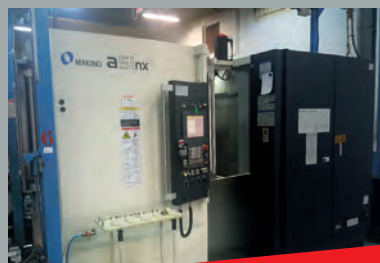
Centre d'usinage horizontal MAKINO A51 NX - CN FANUC Palette 400 x 400 mm Courses 560 x 640 x 640 mm - Année 2015
