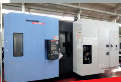
Centre d'usinage horizontal DOOSAN NHM5000 - CN FANUC Palette 500 x 500 mm Courses 800 x 700 x 850 mm - Année 2013
