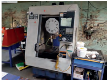
AV Centre d'usinage vertical MORI SEIKI TV 30 - Année 1996 - Courses XYZ : 420 x 300 x 250 mm - CNC Mitsubishi MSC 802 M iso + conversationnel - Magasin : 10 outils BT 30 Vitesse de broche : 8000 rpm Tél : 03 88 72 02 47
