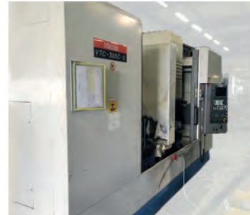
AV Centre vertical MAZAK VTC 300C 2 ème génération - Année 2003 - Mode pendulaire av cloison centrale - CNC Mazatrol Fusion 640M - Table : 2000 x 760 mm - Courses : X 1740 x Y 760 x Z 660 mm - Broche : 12 000 tr/min Puissance : 18,5 Kw - Changeur 30 outils Arrosage au centre - Convoyeur Tél : 06 88 94 32 50 Mail : info@mfl-industrie.com
