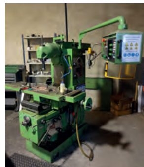
AV Fraiseuse espagnole de 2005 - Table : 1300/1155 x 300 mm - Course approx. : 950 x 300 x 500 mm - Visu Fagor 3 axes - Cône ISO 40 - Tél : 06 88 94 32 50 Mail : info@mfl-industrie.com
