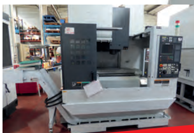
Centre d'usinage MORI SEIKI NV 5000 CN FANUC ST 950 x 480 mm Courses 800 x 500 x 500 mm - 2 palettes
