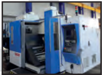
Centre de fraisage 5 axes continu UGV K2X8 de 2006 avec table circulaire ø 500 mm inclinable - Z 450 mm Electrobroche 18 000 tr/min
