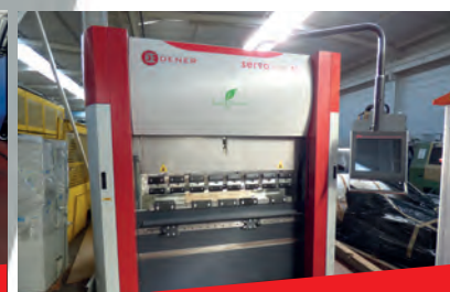
Presse plieuse électrique DENER DD-M-4015 Capacité 40 T x 1530 mm Etat neuf
