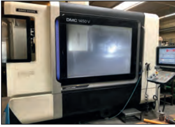
Centre d'usinage vertical DMG DMC 1450 V BAUJAHR 2015 Courses 1400 400 x 550 Commande 3D Siemens 840D Sinumerik
