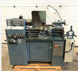
Tour parallèle WEILER MATADOR VS2 Entre-pointes 500 mm Ø maxi sur le banc 300 mm Ø au-dessus du trainard 150 mm Ø passage de broche 36 mm
