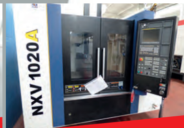
Centre d'usinage YCM NXV1020A CN FANUC Courses 1020 x 520 x 540 mm Année 2015 - Etat neuf
