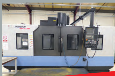
Centre d'usinage vertical DOOSAN VM750L - CN FANUC 31i ST 1900 x 800 mm Courses 1800 x 750 x 800 mm - Année 2013
