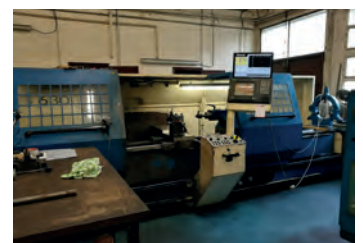
AV Tour CNC SOTOS VOJUS Turntec 63 x 3000 mm - Année 1999 - CNC Siemens 840 D Shopturn - TBE Tél : 03 88 72 02 47
