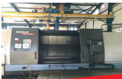
Tour DOOSAN PUMA 700LM CN FANUC 321A - ø maxi d'usinage 900 mm Longueur maxi 3200 mm - Axe C Année 2013
