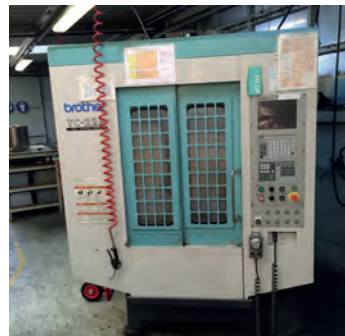
AV Centre BROTHER TC 22 A - De 1999 Broche refaite - Courses : 500 x 400 x 410 - 12 000 tr/min - TBE - Tél : 03 88 72 02 47
