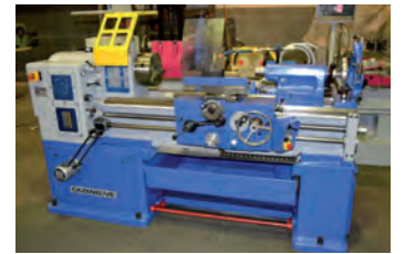
AV Tour parallèle CAZENEUVE - Type HB 500 x 1000 - Machine entièrement reconstruite - Refaite à neuf - Distance entre pointe : 1000 mm - Hauteur de pointe : 200 mm - ø admis au dessus du banc : 500 mm - ø admis au dessus du chariot : 220 mm - Alésage broche : 40,5 mm - Conicité de la contre pointe : CM4 Course maxi du chariot transversal : 400 mm - 18 vitesses de broche : 25 à 2000 tr/min - Puissance moteur de broche : 8,8 kw - Norme CE Tél : 06 70 68 86 74
