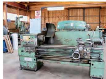
AV Tour ZMM C 11 MT - Distance entre pointes : 1500 mm - ø admis au dessus du banc : 500 mm - ø admis au dessus du chariot : 310 mm - ø admis dans le rompu : 650 mm - Broche percée à : 64 mm - Vitesses de broche : 16 à 2000 tr/min - Contact CPMO - Tél : 03 88 68 01 37
