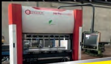
Presse plieuse DENER E-BRAKE DDM - 4015 - CNC ESA 660W 4 axes - Cap 40T x 1500 mm
