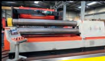
Rouleuse PICOT RCS 350-30 Double croquage Cap 3050 x 20 mm
