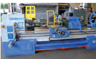
AV Tour parallèle CAZENEUVE - Type HB 800 x 2000 - Reconstituit - Longueur entre pointes : 2000 mm - ø mandrin plateau : 800 mm - ø en mandrin maxi : 400 mm - ø maxi en barre : 80 mm ø maxi en dessous du banc : 800 mm ø maxi au dessus du chariot : 740 mm Course maxi du chariot porte outil : 400 mm - Gamme de vitesses de broche : 8-2000 tr/mn - Nombre de vitesses de broche : 36 - Tél : 01 34 08 42 44 ou 06 07 68 86 74
