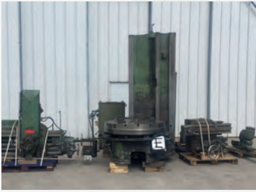
Tour vertical GRAFFENSTADEN TV1616 Ø maxi de tournage 1500 mm Ht maxi de tournage sous traverse 1400 mm Mandrin Ø 1400 mm Visu 2 axes HEIDENHAIN
