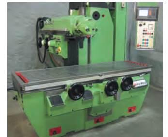
AV Fraiseuse HURON PU 771 - Visue 3 axes - Variateur - Courses : 1900 x 1000 mm - Tél : 06 63 65 11 01
