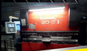
Presse plieuse AMADA HFT 80-25 CNC 4 axes - Cap 80T x 2500 mm
