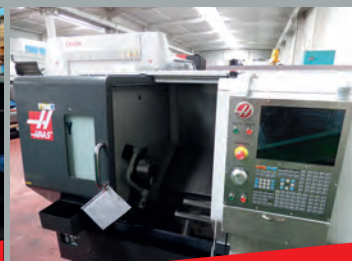
Tour HAAS ST-30Y ø d'usinage max 457 mm Longueur d'usinage 584 mm Axe C - Axe Y - Outillage
