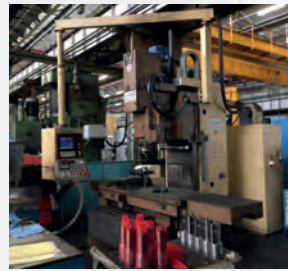
Fraiseuse verticale CNC RAMBAUDI RAMMATIC 600 Courses X 1260 mm - Y 690 mm Z 600 mm - Année de construction 1991 - CNC NUM 1060 Table 2000 x 600 mm
