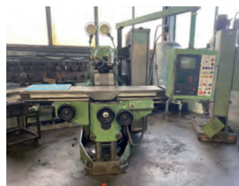
AV Fraiseuse universelle HURON Type MU6 - CNC Heidenhain TNC 135 Variateur de vitesse - Surface de la table : 2000 x 460 mm - Cône de la broche : SA40 - Course longitudinale : 1500 mm - Course transversale : 700 mm Course verticale : 550 mm - 27 vitesses de broche : 30 à 2066 tr/min Déplacement rapide : 2800 mm/min Tél : 06 07 68 86 74 Mail : lgmo95@orange.fr
