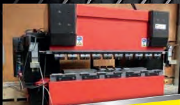
Presse plieuse AMADA HFT 50-20 Cap 50 T x 2 m CNC - 4 axes
