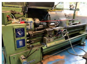
AV Tour parallèle CAZENEUVE - Type HB 500 x 2000 - Distance entre pointe : 1000 mm - Hauteur de pointe : 200 mm ø admis au dessus du banc : 500 mm ø admis au dessus du chariot : 220 mm Alésage broche : 40,5 mm - Conicité de la contre pointe : CM4 - Course maxi du chariot transversal : 400 mm - 18 vitesses de broche : 25 à 2000 tr/min Puissance moteur de broche : 8,8 kw Tél : 06 07 68 86 74
