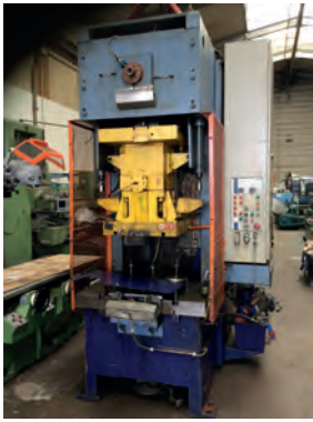
AV Presse col de cygne BRET PCK 120 tonnes - Course variable
