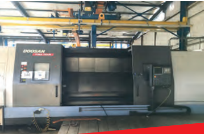
Tour DOOSAN PUMA 700LM CN FANUC 32iA - ø maxi d'usinage 900 mm Longueur maxi 3200 mm - Axe C Année 2013
