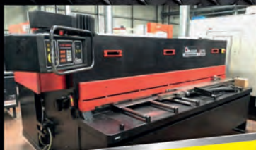
Cisaille guillotine AMADA GPS 425 - Cap 2500 x 4 mm avec SUPPORT TÔLES FINES
