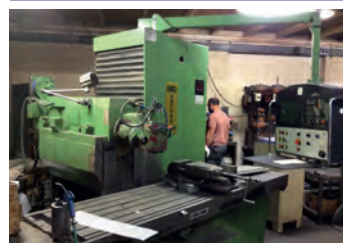
AV Fraiseuse CORREA A16 - Heidenhain TNC 355 - Courses : 1600 x 800 x 800 mm - Tél : 06 63 65 11 01
