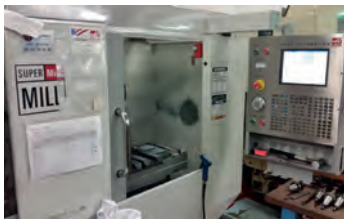
AV Centre d'usinage HAAS Super Mini Mill 16" x 12" - 405 x 305 x 254 mm Cône ISO 40 - Commande vectorielle 7,5 hp (5,6 kw) - 6000 tr/min - TBE Tél : 03 88 72 02 47
