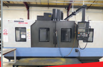
Centre d'usinage vertical DOOSAN VM750L - CN FANUC 3ii ST 1900 x 800 mm Courses 1800 x 750 x 800 mm - Année 2013
