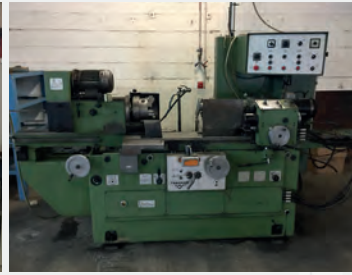
Rectifieuse cylindrique intérieure VOUMARD 5 ALP Ø de rectification de 5 à 200 mm Profondeur maxi de rectification 250 mm Longueur maxi des pièces 1110 mm
