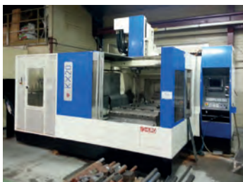
AV Centre d'usinage HURON KX20 CNC Siemens 840D - Machine portique 3 axes - Electrobroche : 15 000 tr/min 10/15 kw - Tél : 02 51 34 12 12
