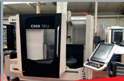
Centre d'usinage 5 axes DMG CMX 70 CN MULTI TACTILE DMG SLIM LINE - SIEMENS Année 2018 - Etat neuf - Table 800 x 600 mm Courses 750 x 600 x 520 mm
