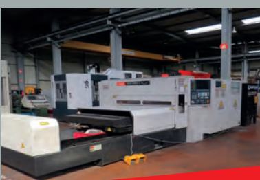
Machine de découpe laser MAZAK Format 2500 x 1250 Puissance 1,3 Kw Année 2007
