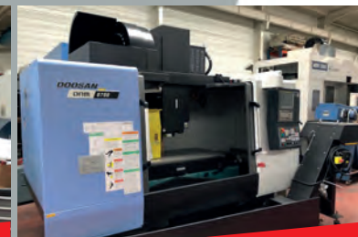
Centre d'usinage vertical DOOSAN DNM 6700 CNC FANUC Oi - Table 1500 x 670 mm Courses 1300 x 670 x 625 mm - Année 2018
