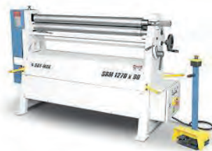
AV Rouleuse motorisée SAY MAK - Type SRM 1050 x 90 - Neuve - Capacité de roulage (longueur x épaisseur) : 1050 x 3 mm - ø du rouleau : 90 mm - ø de cintrage minimum (1,5 x ø rouleau supérieur) : 135 mm - Vitesse de roulage : 6 tr/min - Puissance moteur rotation des rouleaux : 1.1 kw - Dim. machine : 1630 x 700 x 1200 mm - Poids : 480 kg Transmission du rouleau supérieur et inférieur par boîte de vitesse Dispositif de roulage conique - Panneau de commande par pédale - Système de roulage de précision avec moteur frein - Normes CE - Manuel d'utilisation Machine neuve disponible : 4 990 Euros HT - Tél : 06 07 68 86 74
