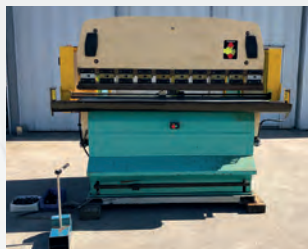
Presse hydraulique PROMECAM RG 35-20 Capacité 35 T Longueur de pliage 2000 mm Passage entre montants 1650 mm Course du coulisseau 100 mm
