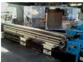
AV Tour à fileter NILES - Modèle : DLZ 800 - 4000 - Année 1974 - Entre pointe : 4000 - ø au dessus du banc : 800 - ø rompu : 850 - Hauteur de pointe : 380 Avec 2 mandrins et 2 lunettes + outils divers - Tél : 03 88 72 02 47
