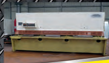
Cisaille guillotine BEYELER CP 3116 - Cap 3100 x 16 mm avec support tôles fines
