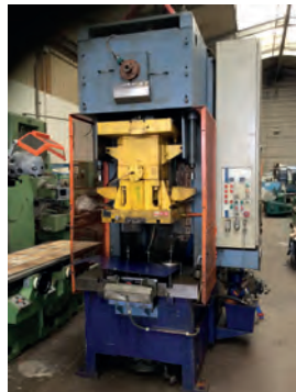
AV Presse col de cygne BRET 125 tonnes REDEX 80 tonnes - SAN GIACOMO 50 tonnes - Courses variables
