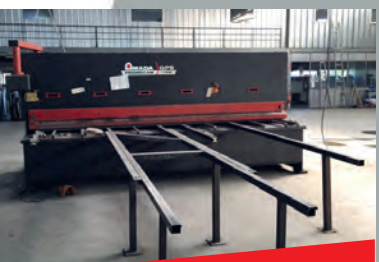
Cisaille guillotine AMADA GPS640 Capacité 4000 x 6 mm
