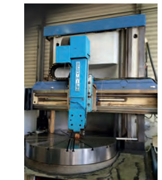
AV Tour vertical BERTHIEZ BMF 200 Num 1040 - Capacité : 2400 mm Passage hauteur : 1850 mm - Remonte copeaux - Cartérisation Tél : 06 63 65 11 01
