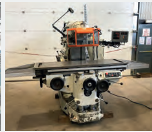
Fraiseuse universelle HURON MU5 Courses X 1300 mm - Y 700 mm Z 500 mm - Broche SA 40 Table 1635 x 460 mm Vitesse de rotation de 30 à 2066 t/min
