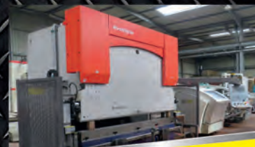
Presse plieuse BYSTRONIC PR 6020 - CNC CYBELEC MODEVA 12S - 7 axes - Cap 60T x 2000 mm
