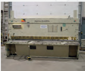
Cisaille hydraulique COMESSA CN 310 Capacité 3000 x 10 mm Butée arrière électrique Lg 850 mm
