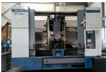
AV Centre d'usinage vertical MORI SEIKI M300L - ST : 830 x 540 mm (x2) - Courses : 1600 (2 x 600) x 500 x 470 mm Tél : 05 61 78 85 85
