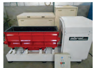
AV Vibrateur ABRAL - Capacité : 250 Litres - Peut travailler à la bille inox
