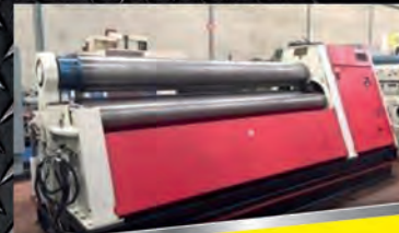
Rouleuse DAVI MCB 3034 CNC 4R - Double croquage Cap 3100 x 20 mm
