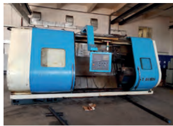
AV Gros Tour CNC JOHNFORST ST 80BH Passage : 1000 mm x 2 m - Entre pointe Lunette - CNC Fanuc 31 i - Mandrin dia : 630 mm - TBE - Tél : 03 88 72 02 47
