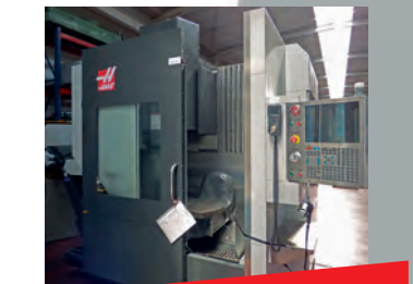
Centre d'usinage vertical 5 axes HAAS UMC 750 - CN HAAS ø plateau 500 x 500 mm Courses 762 x 508 x 610 mm - Année 2014
