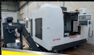
Centre STAR MECA SV1020 CNC FANUC Oi 1020 x 550 x 580
