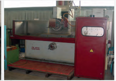
Rectifieuse plane ELB HAHN & KOLB FS1052 Courses X 1000 mm - Y 500 mm - Z 350 mm Année de construction 1989 Table 1600 x 550 mm Axes X-Y-Z : prise de passe auto
