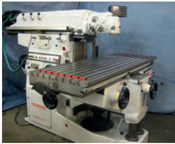
AV Fraiseuse HURON MU66 - Visue Courses : 1500 x 1000 x 550 mm Tél : 06 63 65 11 01
