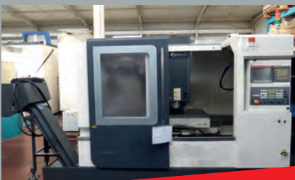
Centre d'usinage vertical HARTFORD PRO 1000 CN FANUC OiMD - ST 1150 x 600 mm Courses 1000 x 600 x 630 Année 2011
