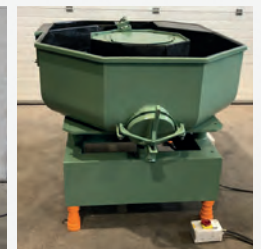
Bac vibreur tribofinition ABRAL-TROWAL H200 Cuve octogonale largeur 250 mm x ht 400 mm Moteur 1500 t/min
