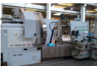
AV Tour TACCHI - Type HD 1450 - CN Num 1060 - ø sur banc : 1300 mm Entrepoint : 4000 mm - Axe C + Axe Y Tél : 05 61 78 85 85
