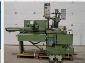
Fraise/scie à disque automatique KALTENBACH KKS 400 Ø du plateau : 550 mm Capacité de coupe dans le rond : 120 mm Capacité de coupé dans le carré : 120 x 120 mm - 2 vitesses de rotation
