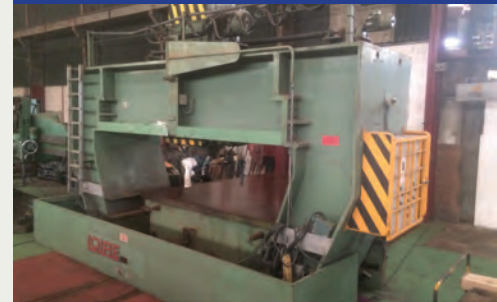
Presse à redresser hydraulique LOIRE SAFE PAM 300
