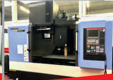
Centre d'usinage vertical DOOSAN MYNX 6500-50 - FANUC OiM - Table 1400 x 670 mm - Courses 1270 x 670 x 625 mm - Année 2017
