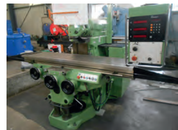
AV Fraiseuse HURON - Type MU 6 Courses : 1500 x 700 x Vert. 550 Variateur de vitesse - Machine rénovée Tél : 03 25 31 92 68 Mail : lemoine.mo@wanadoo.fr
