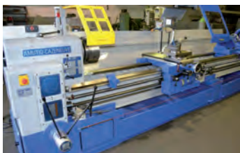
AV Tour parallèle CAZENEUVE - Type HB 725 x 4000 - Reconstitue - Distance entre pointe : 4000 mm - Hauteur de pointe : 315 mm - ø admis au dessus du banc : 725 mm - ø admis dans le rompu : 920 mm - ø admis au dessus du trainard : 670 mm - ø admis au dessus du chariot : 400 mm - Alésage broche : 81 - Conicité de la contre pointe : CM6 Course maxi du chariot transversal : 400 mm - Nombre de vitesse de broche : 18 Rapides longitudinales Tél : 06 07 68 86 74
