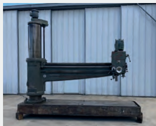
Perceuse radiale GRAFFENSTADEN Course du coulisseau 2500 mm Côte CM5 Broche Ø 100 mm Sortie de broche 350 mm
