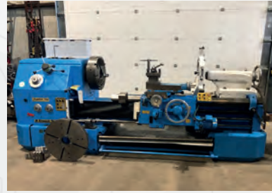
Tour parallèle HES JUPITER 730 Entre-pointes 1600 mm Ø maxi sur le banc 600 mm Ø au-dessus du trainard 400 mm Ø passage de broche 80 mm
