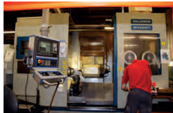
AV Tour fraiseur CNC WILLEMEN W428MT - CNC Siemens 840D Machine 7 axes - Ravitailleur de barres Tél : 02 51 34 12 12
