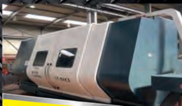
Tour JOHN FORD ST100 CDC Axe C - FANUC 21i TB Diam 1200 - EP 2400
