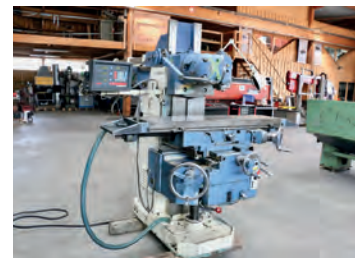
AV Fraiseuse DUFOUR 231 - Table : 1300 x 325 mm - Courses : 900 x 300 x 565 mm - Vitesse : de 35 à 2250 tr/min - Visu 3 axes - Lot d'outillage - Contact CPMO Tél : 03 88 68 01 37
