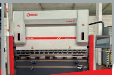
Presse plieuse DENER PUMA 3013C Cap 135 T x 3000 mm - CN Tactile ESA 660 4 axes - Passage entre montants 2550 mm Col de cygne 450 mm - Machine neuve
