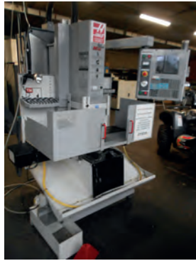
AV Fraiseuse CN HAAS - Type TM 1 HE Table : 1200 x 267 - Courses XYZ : 760 x 305 x 406 - Visible, en bon état de fonctionnement - Tél : 03 25 31 92 68 Mail : lemoine.mo@wanadoo.fr
