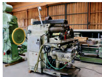
AV Fraiseuse GAMBIN 3 M - Table : 1520 x 385 mm - Longitudinale : 1000 mm Transversale : 420 mm - Verticale : 710 mm - Broche : 9 kW - Contact CPMO Tél : 03 88 68 01 37
