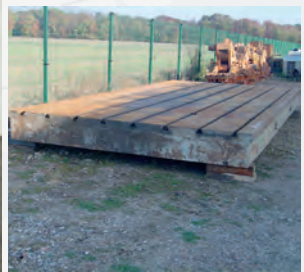
Taque en fonte rainurée 6030 x 2960 x épaisseur 350 mm Poids 22,5 T + autres dimensions disponibles
