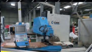
Fraiseuse CME FS2 - CNC HEIDENHAIN TNC 530 - Cap 2000 x 1000 x 1000 mm Convoyeur à copeaux
