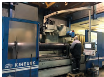
AV Fraiseuse CNC KIHEUNG U 1000 - Heidenhain TNC 530 - Cap : 4000 x 1250 x 1600 mm - Tête auto Tél : 06 63 65 11 01
