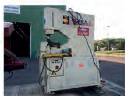
AV Poinçonneuse universelle ACCURL Type IW 60 S - Machine neuve - Double poste - Diamètre et épaisseur max. : 28 x 20 mm - Col de cygne : 310 mm - Coupe rond : 40 mm - Coupe carré : 38 mm Cornière : 130 x 130 x 12 mm - Fers plats : 350 x 15 mm - Puissance moteur : 5,5 kw Poids : 1750 kg - Dimensions machines : 1700 x 800 x 1710 mm - Puissance : 60T Avec jeu de 10 poinçons matrices ø : 8-10-12-14-16-18-20-22-24-26 jeu de 3/10 - Prix HT : 9 990 Euros Tél : 01 34 73 36 85
