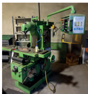
AV Fraiseuse espagnole de 2005 - Table : 1300/1155 x 300 mm - X 966 x Y 287 x Z 414 mm - Visu Fagor 3 axes - Cône ISO 40 - Tél : 04 77 29 56 74 Mail : info@mfl-industrie.com
