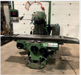
Fraiseuse universelle HURON MU5 variateur avances Courses X 1300 mm - Y 700 mm Z 500 mm Broche SA 40 Table 1630 x 460 mm Vitesse de rotation de 30 à 2066 t/min
