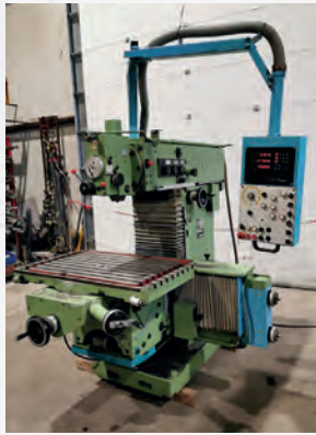
Fraiseuse universelle MAHO MH800 à variation Courses X 700 mm Y 450 mm - Z 500 mm Broche sensitive SA 40 Table 1050 x 625 mm Vitesse de rotation de 32 à 1600 t/min
