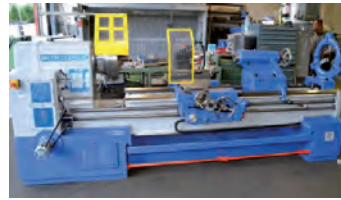
AV Tour parallèle CAZENEUVE - Type HB 800 x 2000 - Reconstitué - Longueur entre pointes : 2000 mm - ø mandrin plateau : 800 mm - ø en mandrin maxi : 400 mm - ø maxi en barre : 80 mm ø maxi en dessous du banc : 800 mm ø maxi au dessus du chariot : 740 mm Course maxi du chariot porte outil : 400 mm - Gamme de vitesses de broche : 8-2000 tr/mn - Nombre de vitesses de broche : 36 - Tél : 01 34 08 42 44 ou 06 07 68 86 74 Mail : lgmo95@orange.fr
