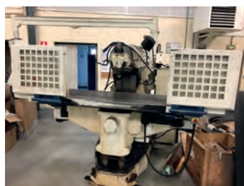
AV Fraiseuse HURON CN et apprentissage type MU BASIC - Base de MU 6 avec CN Num - Tête à serrage auto des outils (hydraulique) - Table : 2000 x 460 X 1500 x Y 700 x Z 500 mm - Tête : 2066 tr/min - En parfait état Tél : 04 77 29 56 74 Mail : info@mfl-industrie.com
