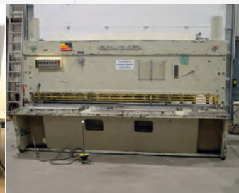
Cisaille hydraulique COMESSA CN 310 Capacité 3000 x 10 mm Butée arrière électrique Lg 850 mm
