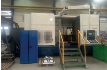
AV Centre d'usinage 5 axes HURON EXC30 - CNC Siemens 840D - 5 axes continus - Broche : 14 000 tr/min Magasin 32 outils - Tél : 02 51 34 12 12
