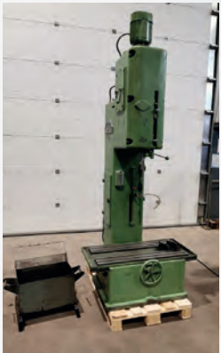
Rodeuse verticale CIMOF 300 Course verticale de la broche Ø 300 mm Capacité Ø 130 mm Vitesse de broche de 100 à 400 t/min Surface table 1100 x 500 mm
