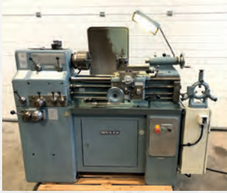
Tour parallèle WEILER MATADOR VS2 Entre-pointes 500 mm Ø maxi sur le banc 300 mm Ø au-dessus du trainard 150 mm Ø passage de broche 36 mm
