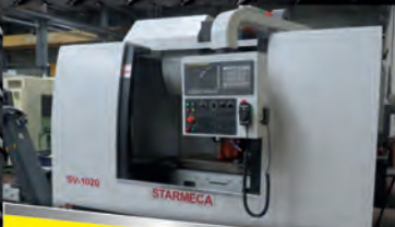
Centre STARMECA SV1020 - 2017 CNC FANUC Oi MC Cap 1020 x 550 x 580 mm - Etat neuf
