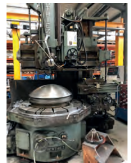
AV Tour vertical BERTHIEZ type 9330/4 ø plateau (4 mors indépendants) : 1400 mm - ø maxi à tourner : 1520 mm - ø maxi à tourner au centre : 1760 mm - Hauteur maxi de tournage : 1170 mm - Vitesse du plateau : 3,15 - 160 tr/min - Charge maxi sur plateau : 8 T - Puissance du moteur : 35 CV - Inclinaison du chariot sur montant : +/- 30° - Poids approx. : 5,2 T - Visu 2 axes Heidenhain - Tourelle 6 positions au coulant Tél : 06 07 68 86 74 Mail : lgmo95@orange.fr
