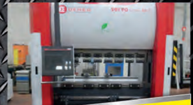
Presse plieuse électrique DENER DD - 40 T x 1400 mm CNC ESA 660 W - 4 axes - 2017
