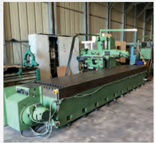
Fraiseuse à banc fixe HURON RU881 Courses X 3500 mm - Y 1000 mm Z 1000 mm Table 5155 x 1000 mm Vitesse de rotation de 15 à 1500 t/min Visu 3 axes ACU-RITE
