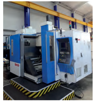
AV Centre de fraisage 5 axes continu UGV - Type K2X8 - Année 2005/2006 en CNC Siemens 840D - Courses X (chariot sur portique) 1000 x Y (table) 700 x Z (vertical) 450 mm - Electrobroche : 16 000 tr/min - Puissance : 36 kW - Table circulaire diam : 500 mm à 2 axes : C rotation 360° vitesse 50 tr/min + A basculement -45°/+180° rotation 50 tr/min - Rapides : 50 m/min - Arrosage au centre : 50 bars - Magasin auto : 100 outils - Tél : 04 77 29 56 74 Mail : info@mfl-industrie.com
