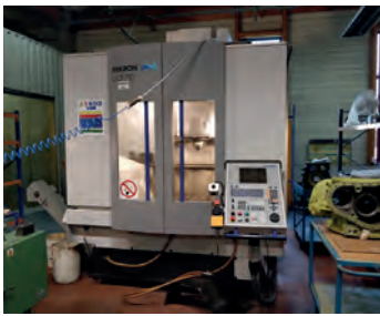
AV Centre d'usinage 5 axes MIKRON UCP710 - CNC Heidenhain - Broche : 12000 tr/min / 11 kw - Tél : 02 51 34 12 12
