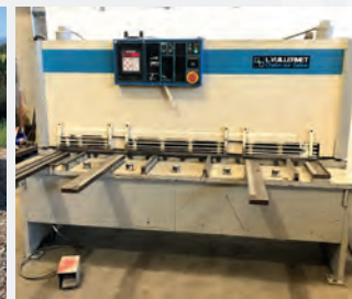
Cisaille hydraulique VUILLERMET 210H Capacité dans l'acier 2000 x 10 mm Capacité dans l'inox 2000 x 8 mm
