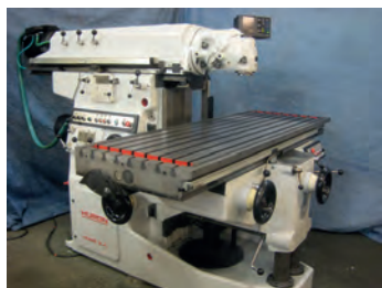
AV Fraiseuse HURON MU66 - Visue Courses : 1500 x 1000 x 550 mm Tél : 06 63 65 11 01
