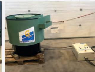
Sécheur tribofinition TROWAL G100B à rafle de maïs Année de construction 1997 Cuve Ø 1100 mm x ht 1100 mm Moteur 1500 t/min
