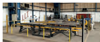
AV Cintreuse de tube à commande numérique CSM 120TRS-RBF - Capacité : 120 mm - Avec dispositif de retour- nement automatique pour réalisation d'épingles - Mandrin longueur : 6 m Lot d'outillage important avec la machine - Année 2018 - Machine visible en fonctionnement - Tél : 02 51 34 12 12
