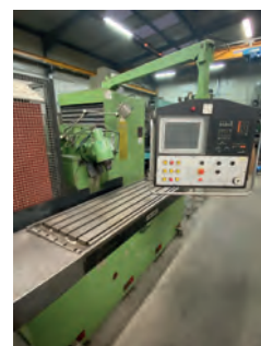
AV Fraiseuse commande numérique CORREA type A10 - Année : 1989 Courses XYZ : 1300 x 630 x 630 mm Control Heidenhain TNC 355 - Surface table : 1500 x 660 mm - Vitesse de rotation : 80-3150 tr/min - Inclinaison tête : +/- 2 x 360° - Vitesse de dépla- cement : 10 - 5000 mm/min - Vitesse rapide : 8 m/min - Charge sur table : 6,6 T - Puissance totale : 12 kw - Poids de la machine : 6 T - Serrage hydraulique de l'outil - Tél : 01 34 73 36 85 Mail : lgmo95@orange.fr
