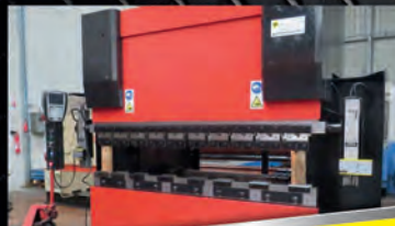
Presse plieuse AMADA HFT 50 T x 2000 CNC CD 4 axes
