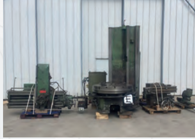
Tour vertical GRAFFENSTADEN TV1616 Ø maxi de tournage 1500 mm Ht maxi de tournage sous traverse 1400 mm Mandrin Ø 1400 mm Visu 2 axes HEIDENHAIN
