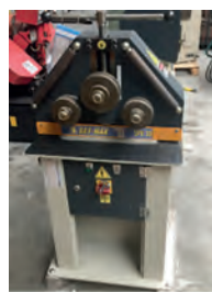
AV Cintreuse de profilés type SPK 30 Neuve - Système horizontal et vertical Diamètre des arbres : 30 mm - Vitesse de travail : 2-4 m/mn - Fer plat : 80 x 15 - Cornière : 40 x 40 x 5 - Carré : 30 x 30 mm - Machine neuve disponible sauf vente entre temps : 3 290 Euros Tél : 06 07 68 86 74 Mail : lgmo95@orange.fr
