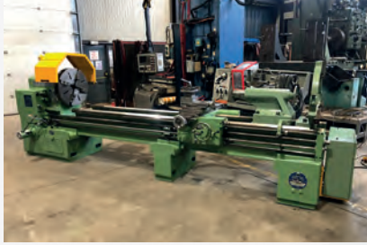
Tour parallèle CAZENEUVE HB 725 x EP 3000 mm Entre-pointes 3000 mm Ø maxi sur le banc 725 mm Ø au-dessus du trainard 430 mm - Ø rompu 960 mm Mandrin 4 mors Ø 600 mm
