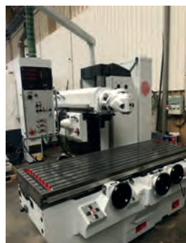
AV Fraiseuse HURON PU 771 - Visue 3 axes - Variateur - Courses : 1900 x 1000 x 1000 mm - Tél : 06 63 65 11 01
