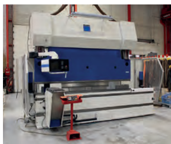
AV Plieuse TRUMPF Trumabend V230 Capacité : 3000 x 230T - 6 axes : Y1, Y2, X, R, Z1, Z2 - Accompagnateur de tôle Tél : 02 51 34 12 12
