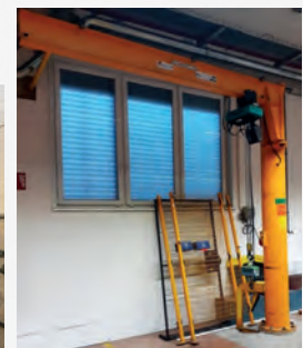
Potence de levage TOURTELLIER - 500 kg Capacité 500 kg Année de construction 2004 Longueur du bras 3000 mm Diamètre de la colonne 350 mm
