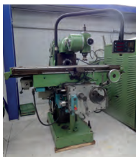
AV Fraiseuse GRAFFENSTADEN type FH 126 Hyper - Tête verticale indexable bi-rotative en cône SA 40 et broche horizontale en SA 50 - Table : 1600 x 400 mm (intérieur 1355 x 310 mm) - X 1210 x Y (table) 300 x Z 470 mm + Bélier 800 mm Visualisation 3 axes Heidenhain Tél : 04 77 29 56 74 Mail : info@mfl-industrie.com
