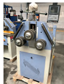
AV Cintreuse de profilés type SPK 35 Neuve - Système horizontal et vertical Diamètre des arbres : 50 mm - Diamètre des galets : 155 mm - Vitesse de travail : 4.5 m/mn - Entraînement des deux galets par motoréducteur : 1.5 kW - Fer plat : 100 x 15 - Cornière : 50 x 50 x 6 UPN : 80 - Carré : 35 x 35 mm - Machine neuve disponible sauf vente entre temps : 4 590 Euros HT Tél : 06 07 68 86 74 Mail : lgmo95@orange.fr
