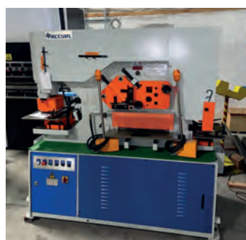
AV Poinçonneuse universelle ACCURL Type IW 60 S - Machine neuve - Double poste - Diamètre et épaisseur max. : 28 x 20 mm - Col de cygne : 310 mm - Coupe rond : 40 mm - Coupe carré : 38 mm Cornière : 130 x 130 x 12 mm - Fers plats : 350 x 15 mm - Puissance moteur : 5,5 kw Poids : 1750 kg - Dimensions machines : 1700 x 800 x 1710 mm - Puissance : 60T Avec jeu de 10 poinçons matrices ø : 8-10-12-14-16-18-20-22-24-26 jeu de 3/10 - Prix HT : 9 990 Euros Tél : 01 34 73 36 85
