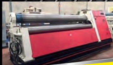
Rouleuse DAVI MCB3034 4 rouleaux CNC Cap 3100 x 20 mm
