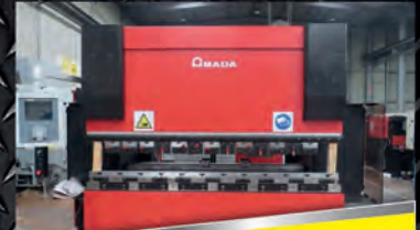
Presse plieuse AMADA HFT 80 T x 2500 4 axes
