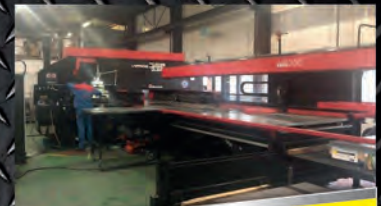
Poinçonneuse AMADA VIPROS 368 Chargement / déchargement de tôles Déchargement pièce à pièce
