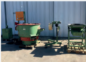
Vibreur tribofinition SPALECK VA-240 Capacité 240 L - Cuve Ø 1350 mm Revêtement en TBE Moteur 1500 t/min
