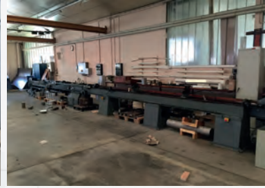
Rodeuse horizontale MAUSER Capacité de rodage maxi Ø 100 mm Lg de rodage 6000 mm Lg totale de la machine : 14 mètres Machine en 2 éléments
