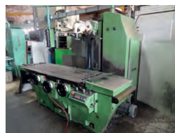
AV Fraiseuse banc fixe conventionnelle HURON PU 601 - Table : 2000 x 700 mm - X 1660 x Y 700 x Z 900 mm - Tête SA 40 ou 50 au choix - Vitesse broche : 2066 tr/min - Visu 3 axes Heidenhain Tél : 04 77 29 56 74 Mail : info@mfl-industrie.com
