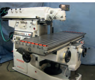
AV Fraiseuse HURON MU66 - Visue Courses : 1500 x 1000 x 550 mm Tél : 06 63 65 11 01
