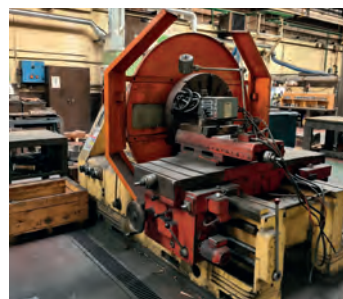
AV Tour frontal SCULFORT Superfaciap 1500 - ø du plateau : 800 mm - Longueur usinable : 650 mm - ø de tournage : 1540 mm - ø sur transversal : 700 mm - Largeur de banc : 1100 mm - Vitesses de rotation de broche : 24/10-800 Tpm Visu 2 axes - Tél : 06 75 49 57 65
