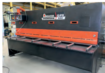
AV Cisaille AMADA - Type GPS 630 CNC Capacité : 3050 x 6 mm Ets GIROUDON : 04 77 71 24 55
