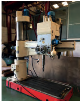
AV Perceuse radiale STANKO 2A554 Année 1987 - Course de la broche : 400 mm - Distance max outil-table : 450-1600 mm - Cône de broche : CM5 Rayon : 375-1600 mm - Ø de perçage : 50 mm - Vitesses de rotation de broche : 24/18-2000 Tpm - Vitesses d'avance : 24/0,045-50 mm/mn - Puissance moteur principal : 5,5 Kw Tél : 06 75 49 57 65
