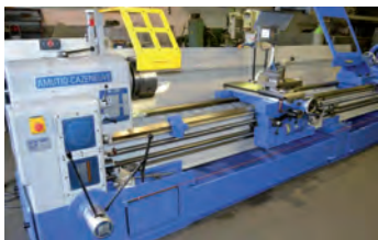
AV Tour parallèle CAZENEUVE - Type HB 725 x 4000 - Reconstitue - Distance entre pointe : 4000 mm - Hauteur de pointe : 315 mm - \varnothing admis au-dessus du banc : 725 mm - \varnothing admis dans le rompu : 920 mm - \varnothing admis au-dessus du trainard : 670 mm - \varnothing admis au-dessus du chariot : 400 mm - Alésage broche : 81 - Conicité de la contre pointe : CM6 Course maxi du chariot transversal : 400 mm - Nombre de vitesse de broche : 18 Rapides longitudinales Tél : 06 07 68 86 74
