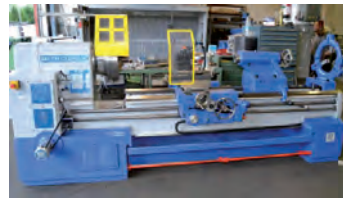
AV Tour parallèle CAZENEUVE - Type HB 800 x 2000 - Reconstitue - Longueur entre pointes : 2000 mm - \varnothing mandrin plateau : 800 mm - \varnothing en mandrin maxi : 400 mm - \varnothing maxi en barre : 80 mm \varnothing maxi en-dessous du banc : 800 mm \varnothing maxi au-dessus du chariot : 740 mm Course maxi du chariot porte outil : 400 mm - Gamme de vitesses de broche : 8-2000 tr/mn - Nombre de vitesses de broche : 36 - Tél : 01 34 08 42 44 ou 06 07 68 86 74 Mail : lgmo95@orange.fr
