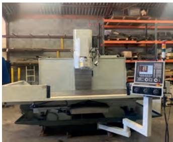
AV Fraiseuse CNC Fagor - Table : 2300 x 760 mm - Tête universelle - 22 kW Tél : 06 20 75 70 37
