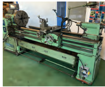
AV Tour parallèle CAZENEUVE HB 575 x 2000 - \varnothing s/ le banc : 575 mm - Alésage de broche : 51 mm - Distance entre-pointes : 2000 mm - \varnothing admis dans le rompu : 750 mm - Largeur du rompu : 235 mm \varnothing sur transversal : 300 mm - Vitesses de rotation de broche : 20-2500 Tpm Vitesses d'avance : 0,009-5,6 mm/mn Visu 2 axes Heidenhain Tél : 06 75 49 57 65
