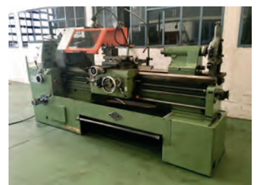
AV Tour parallèle ZUBAL AP 250 x 1500 Reconstitué en 1989 - ø s/ le banc : 500 mm - Alésage de broche : 51 mm - Distance entre-pointes : 1500 mm - ø admis dans le rompu : 750 mm - Largeur du rompu : 240 mm - ø sur transversal : 320 mm - Lunette fixe ø : 150 - Tourelle rapide + 3 x porte-outils Tél : 06 75 49 57 65
