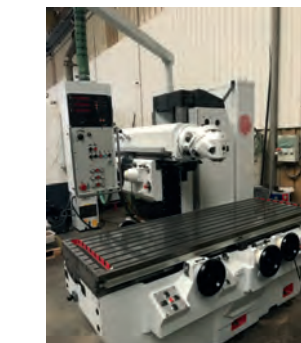
AV Fraiseuse HURON PU 771 - Visue 3 axes - Variateur - Courses : 1900 x 1000 x 1000 mm - Tél : 06 63 65 11 01
