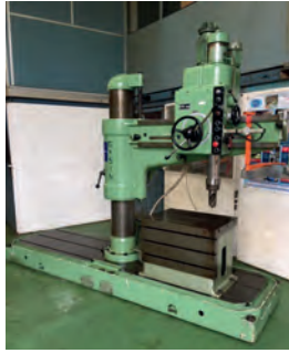
AV Perceuse radiale GYSIN RH40 Reconstituée en 1993 - Course de la broche : 300 mm - Distance max outil-table : 270-1270 mm - Cône de broche : CM5 - Longueur de bras : 1290 mm - Ø de perçage : 45 mm - Vitesses de rotation de broche : 21-1800 Tpm Tél : 06 75 49 57 65
