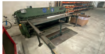
AV Cisaille guillotine BOMBLED Type 209 HK - Capacité : 3020 x 7 mm Presse tôle hydraulique refait (joints et embouts) - Butée arrière électrique, course : 750 mm - Butée arrière refaite à neuf - Remplacement câble et pédale électrique - Lames réaffûtées Règle d'équerre avant de 2500 mm Encombrements : 4600 x 1360 x 1840 mm Poids : 8000 kg Tél : 06 07 68 86 74 Mail : lgmo95@orange.fr
