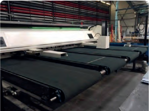
Cisaille guillotine PERROT HGL 4100 x 6 mm - CNC Avec support de tôles arrière et transporteur à bandes - Retour par l'avant (2015)
