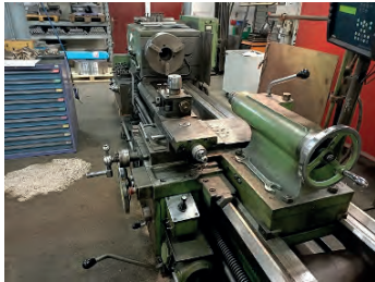
AV STANKO 1 M63 x 3000 - Hauteur de pointes : 315 mm - Distance entre-pointes : 3000 mm - \varnothing maxi au-dessus du chariot transversal : 350 mm - \varnothing maximum au-dessus du banc : 630 mm Alésage de broche : 70 mm - Cône de la contre-pointe CM 6 - Nombre de vitesses de broche : 22 - Vitesse de broche : 10 à 1250 tr/mn - Moteur 15 kw Poids approximatif - 8000 kg - Mandrin 3 mors \varnothing : 400 mm - Visu 2 axes - Lunette fixe - Tél : 06 09 14 93 74 Mail : info@techmologie.com
