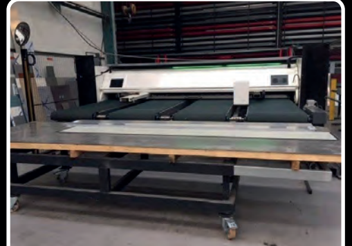
Cisaille guillotine PERROT HGL 4100 x 6 mm - CNC Avec support de tôles arrière et transporteur à bandes - Retour par l'avant (2015)
