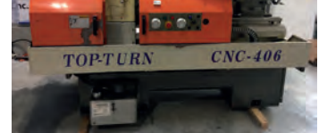
AV Tour TOP TURN CN Fagor 8055T Z=760, X=195 - 2 gammes vitesse Tourelle automatique 4 positions - \varnothing s/ banc : 406 mm - Prix : 10 000 Euros Contact AEMTEK : 04 26 00 34 01
