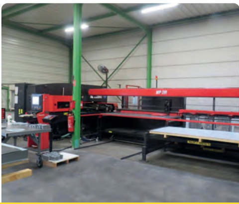
Poinçonneuse AMADA Electrique AE 255 NT avec Chargeur LKI MP250 (état neuf 2011) - Nombreux outillages avec placard
