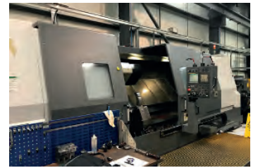
AV Tour CNC SAMSUNG PL 60M Année 2014 - 8 000 heures de travail CNC Fanuc OiT Conversationnel manuel guide - \varnothing de tournage au-dessus du banc : 1030 mm - Distance entre pointe : 3000 mm - Max. diamètre de machine x longueur : 900 x 3000 mm - Passage en broche : 170mm - Vitesses de broche : 1200 tpm - Moteur de broche : 45/37 kW - Mandrin hydraulique 3 mors : 600 mm - Axe C - Vitesses de la broche de fraisage : 4000 tpm - Moteur de fraisage : 11 kW - Tourelle 12 poste BMT 75 Lunette auto SMW : \varnothing 350mm - Palpeur d'outils - Tél : 06 09 14 93 74 Mail : info@techmologie.com
