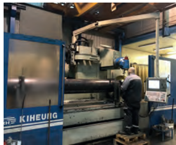
AV Fraiseuse CNC KIHEUNG U 1000 Heidenhain TNC 530 - Cap : 4000 x 1250 x 1600 mm - Tête auto Tél : 06 63 65 11 01
