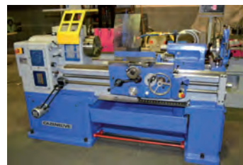
AV Tour parallèle CAZENEUVE - Type HB 500 x 1000 - Machine entièrement reconstruite - Refaite à neuf - Distance entre pointe : 1000 mm - Hauteur de pointe : 200 mm - ø admis au-dessus du banc : 500 mm - ø admis au-dessus du chariot : 220 mm - Alésage broche : 40,5 mm - Conicité de la contre pointe : CM4 - Course maxi du chariot transversal : 400 mm - 18 vitesses de broche : 25 à 2000 tr/min - Puissance moteur de broche : 8,8 kw - Norme CE Tél : 06 70 68 86 74 Mail : lgmo95@orange.fr
