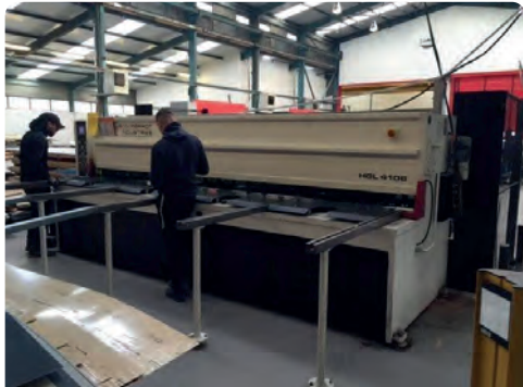
Cisaille guillotine PERROT HGL 4100 x 6 mm - CNC Avec support de tôles arrière et transporteur à bandes - Retour par l'avant (2015)
