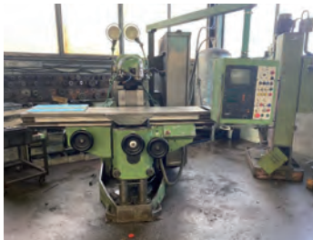
AV Fraiseuse universelle HURON Type MU6 - CNC Heidenhain TNC 135 Variateur de vitesse - Surface de la table : 2000 x 460 mm - Cône de la broche : SA40 - Course longitudinale : 1500 mm - Course transversale : 700 mm - Course verticale : 550 mm - 27 vitesses de broche : 30 à 2066 tr/min - Déplacement rapide : 2800 mm/min - Encombrement : L x l x H : 2460 x 2460 x 215 - Poids approximatif : 4000 kg Tél : 06 07 68 86 74 Mail : lgmo95@orange.fr
