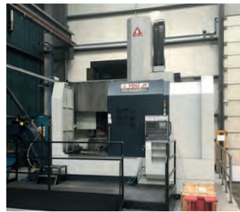
AV Tour vertical YOU JI VTL1600ATC + C - Année 2014 - 4700 heures de travail CNC Fanuc 18i-TB - ø plateau : 1600 mm - ø maxi : 2000 mm - Hauteur pièce : 1250 mm - Vitesse broche : 250 tr/mn - Puissance moteur broche : 37/45 kW - Poids maxi pièce : 8000 kg - Axe C - Outils tournants - Outils motorisés vitesse : 2500 tr/mn - Outils motorisés puissance : 5,5/7,5 kW - Changeur d'outils 16 postes - Machine en très bon état - Visible sous tension Tél : 06 09 14 93 74 Mail : info@techmologie.com
