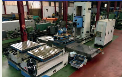
Centre de fraiseage à table croisée 4 axes JUARISTI TX1-D
