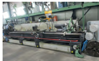
AV Tour CAZENEUVE - Type HB 725 en 5 mètres - Très bon état mécanique et géométrique - Visu - Lunettes fixes et à suivre - Accessoires - Electricité, lubrifiant - Visible en bon état de fonctionnement - Tél : 03 25 31 92 68 - Mail : lemoine.mo@wanadoo.fr
