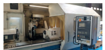
AV Rectifieuse exte cylindrique SCHAUDT SA 7M - CNC Siemens 840C Capacité : 2000 x 620 mm Tél : 06 63 65 11 01
