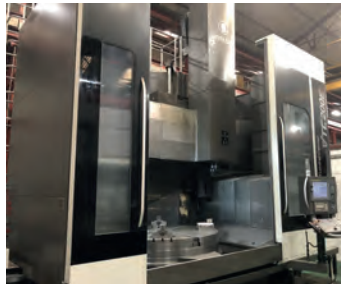
AV Tour vertical HANKOOK VTC 200 E - Année 2013 - Mise en service 2017 3500 heures de travail - CNC Fanuc 32i ø du plateau : 2000 mm - Poids sur table : 12t - ø passage max : 2500 mm Hauteur pièce : 2000 mm - Traverse mobile course : 1000 mm - Course Z (coulant) : 1500 mm - Section du coulant : 240 x 240 mm - Rotation du plateau : 1 à 200 tr/mn - Puissance moteur broche : 45/55 kW - Boite de vitesse 2 gammes - Axe C : 0.001° Magasin d'outils : 24 postes BT 50 (12 tournages +12 motorisés) - Outils motorisés vitesse : 3000 tr/mn - Outils motorisés puissance : 18.5/22 kW Couple maxi : 40 403 Nm - Convoyeur de copeaux - Dimensions de la machine : 6280 x 4500 x 7258 mm - Poids : 45t Tél : 06 09 14 93 74 Mail : info@techmologie.com
