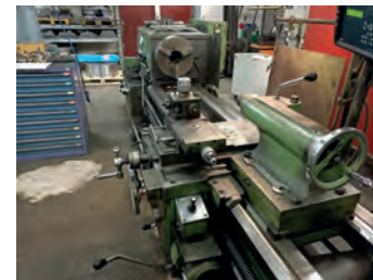
AV Tour STANKO 1m63 x 3000 - Hauteur de pointes : 315 mm - Distance entre-pointes : 3000 mm - ø maxi au-dessus du chariot transversal : 350 mm - ø maximum au-dessus du banc : 630 mm Alésage de broche : 70 mm - Cône de la contre-pointe CM6 - Nombre de vitesses de broche : 22 - Vitesse de broche : 10 à 1250 tr/mn - Moteur : 15 kw - Avances rapides sur 3 axes Petit chariot motorisé - Possibilité synchroniser le petit chariot et le trainard pour usinage cône - Poids approximatif : 8000 kg - Mandrin 3 mors ø : 400 mm - Visu 2 axes - Lunette fixe - Tél : 06 09 14 93 74 - Mail : info@techmologie.com
