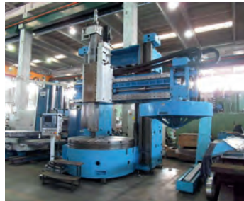
AV Tour CNC TITAN SC 22 axe C 1990/2005 - Machine en cours de remontage - CNC Fagor 8065 - ø de la table : 2000 mm - ø maxi de passage : 2150 mm - Passage en hauteur sous la traverse : 1650mm - Section de ram : 250 x 250mm - Course du coulant : 1200 mm - Vitesse de rotation du plateau : 0 à 143 tr/min - Puissance du moteur de broche : 60 kw - Axe C - Puissance outils de fraiseage : 17 kw - Vitesse de rotation outils motorisés : 1000 t/mn - Changeur d'outils : 16 postes Convoyeur de copeaux - Carénage Poids maxi de la pièce sur la table : 25 tonnes - Lot outillage - Machine rétrofitée complètement Tél : 06 09 14 93 74 Mail : info@techmologie.com
