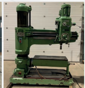
Perceuse radiale GSP 44 T 12 Broche CM4 Sortie de broche 300 mm Course du bras 1000 mm
