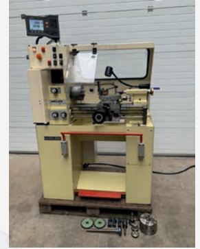
Tour parallèle WEILER PRIMUS Entre-pointes 400 mm \phi maxi sur le banc 250 mm \phi maxi au-dessus du trainard 130 mm
