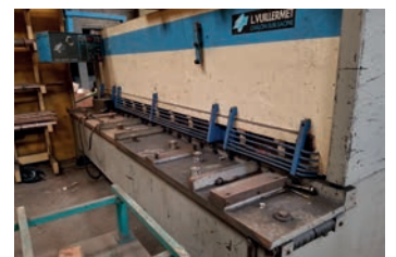
AV Cisaille guillotine VUILLERMET - Type 306H Longueur de pliage : 3100 mm Epaisseur : 6 mm - Presse tôle hydraulique - Butée arrière électrique gérée - Réglage de l'angle de coupe manuel Puissance moteur : 9,5 kw Poids : 5 500 kg Tél : 06 07 68 86 74
