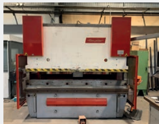
Presse plieuse hydraulique BEYELER PR6 100/2550 Capacité 100 T x 2550 Commande CYBELEC DNC 804 PS/K 6 Année 1998
