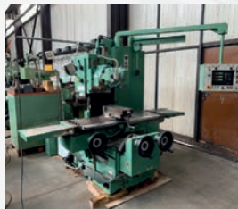
Fraiseuse à banc fixe VERNIER DB 420 Courses X 1200 mm Y 420 mm - Z 600 mm Cône SA40 Table 1600 x 400 mm Vitesse de rotation de 40 à 2000 t/min
