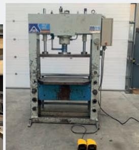
Presse hydraulique verticale AEM3 915 SP Diamètre vérin 110 mm Force vérin 100 T Course vérin 300 mm Année 1994
