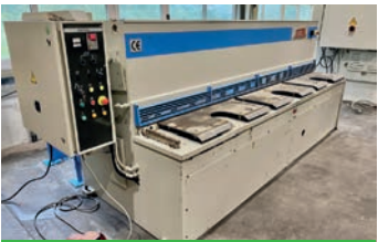
Cisaille à tôles hydraulique HGD 3100 x 6 ADFORM
