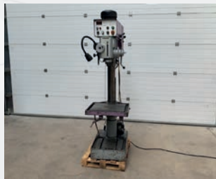
Perceuse/taraudeuse à colonne SIDAMO 40 CVDA Broche cône CM4 Sortie de broche maxi 140 mm Vitesse de broche de 65 à 2000 t/min Surface table 560 x 460 mm
