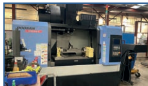
CU vertical 4 axes DOOSAN DNM 650 II De 2015 avec 4ème axe double diviseur Nikken CN Siemens 828D Table 1300 x 670 mm X 1270 x Y 670 x Z 625 mm Nombreuses options Broche BT 40 rotation maxi 12.000 tr/min
