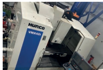
AV Centre d'usinage vertical 3 axes HURCO VMX 42t - 2008 CN WinMax Ultimax 4 - Table 1270 x 610 mm - X 1067 x Y 610 x Z 610 - Big Plus ISO 40 12k tr/min Changeur 24 outils - Arrosage centre broche Tél : 04 77 29 56 74 Mail : info@mfl-industrie.com
