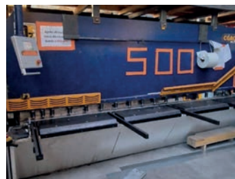
AV Cisaille guillotine à angle variable OZBORN CGACN 4106 Année 10/2016 - Longueur de cisailage : 4100 mm - Epaisseur de cisailage (acier doux) : 6 mm - Angle de coupe : 0,5 2,5° - Col de cygne : 350 mm Moteur principal : 15 kw Capacité du réservoir d'huile : 300 L - Dimensions (largeur avec guides) : 5030 x 2360 (2665) x 2300 mm - Poids : 9750 kg - Equipement : Commande numérique Cybelec Cybtouch 6G - Support de tôle pneumatique Tél : 01 39 99 52 85
