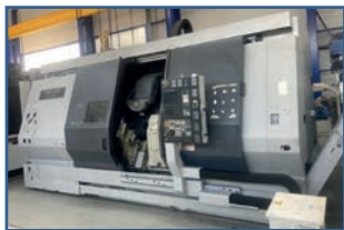
Centre de tournage fraiseuse 5 axes Mori Seiki Fanuc 18i-T - Capacité ø 420 x lg 1530 mm Broche tournage + broche de fraiseuse Axe B continu + 105° / -120° - axe C 0,001°
