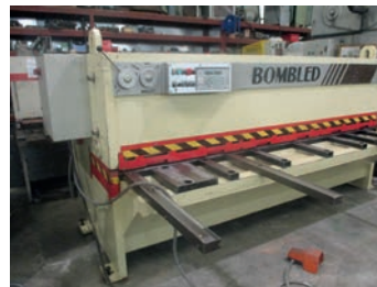
AV Cisaille guillotine BOMBLED Type GTS - Capacité : 3 m en 6 - Visible en bon état de fonctionnement Tél : 03 25 31 92 68 Mail : lemoine.mo@wanadoo.fr
