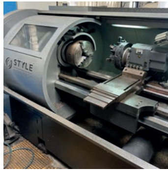
AV Tour électronique STYLE 510 x 1350 - Année de fabrication : 2012 - \phi de passage au-dessus du banc : 510 mm - Distance entre pointes : 1350 mm - Puissance moteur principal : 7,5 kw - Couple nominal maximum sur la broche principale (56-40%) : 1180 Nm - Vitesse maximum de rotation de la broche (3 gammes) : 2500 (3) t/min - Dimensions : 3200 x 1800 x 1800 mm - Commande numérique Style - Changeur d'outils automatique - Tourelle 8 positions VDI 40 - Cartérisation complète - Manivelles électronique - Vitesse de coupe constante Tél : 01 39 99 52 85
