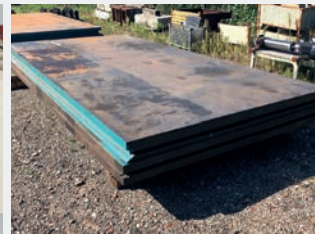
Marbre lisse en fonte 3910 x 2000 x épaisseur 350 mm Poids env 7 T Fournis avec 6 pieds de nivellement (2 marbres identiques disponibles) + autres dimensions disponibles
