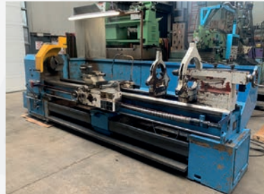
Tour parallèle RAMO A75 Entre-pointes 3000 mm \phi maxi sur le banc 750 mm \phi maxi au-dessus du trainard 500 mm Passage de broche \phi 91 mm
