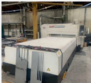
Découpe laser MAZAK Super TURBO X 510 MARKII CN MAZAK PREVIEW Année 2008 Format tôle 1500 x 3000 mm Capacité de découpe acier 25 mm inox 12 mm - alu 10 mm
