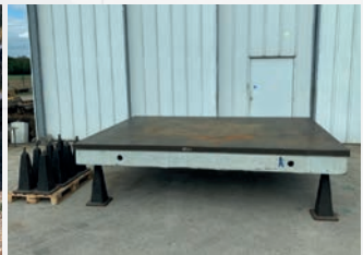
Marbre lisse en fonte STOLLE 3500 x 2500 x épaisseur 305 mm Hauteur sur pieds 900 mm Poids 6,3 T Fournis avec 12 pieds de nivellement
