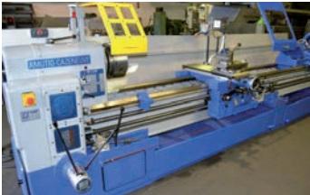
AV Tour parallèle CAZENEUVE Type HB 725 x 4000 - Reconstitue Distance entre pointe : 4000 mm - Hauteur de pointe : 315 mm - \phi admis au-dessus du banc : 725 mm - \phi admis dans le rompu : 920 mm - \phi admis au-dessus du trainard : 670 mm - \phi admis au-dessus du chariot : 400 mm - Alésage broche : 81 mm - Conicité de la contre pointe : CM6 - Course maxi du chariot transversal : 400 mm - Nombre de vitesse de broche : 18 - Rapides longitudinales Tél : 01 39 99 52 85
