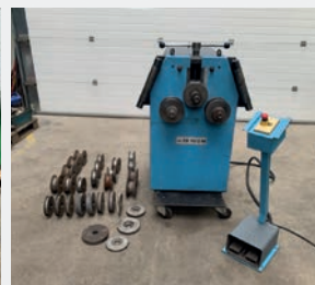
Cintreuse à galets ZOPPF ZB 70/2M Année 1999 Capacité de cintrage \phi 70 mm Diamètre des axes \phi 40 mm Diamètre des galets 152 / 162 mm
