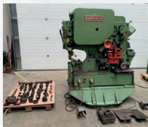
Cisaille/poinçonneuse PEDDINGHAUS 210 Super 13 Capacité maxi 60 T Profondeur col de cygne 370 mm Capacité poinçonnage \phi 20 x 25 mm \phi 90 x 5 mm Capacité cisailage 150 x 14 mm
