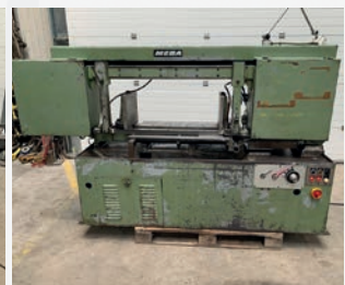
Scie à ruban MEBA Capacité coupe dans le rond \phi 440 mm Capacité coupe dans le rond 700 x 300 mm
