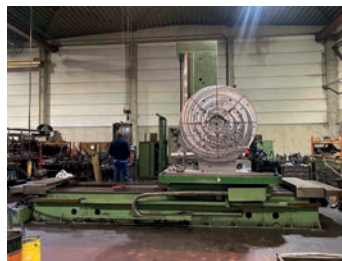
AV Aléseuse fraiseuse TOS WHN 13 de 1999 - Heidenhain TNC 426 - Table : 1800 x 2200 mm - X 3500 x Y 2500 x Z 1250 x W 800 mm - Broche ISO 50 ø 130 mm 2500 tr/min Tél : 04 77 29 56 74 Mail : info@mfl-industrie.com
