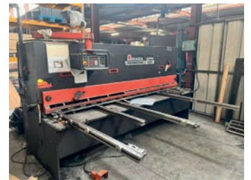
AV Cisaille guillotine AMADA Type GPN 630 - Très belle cisaille avec récupérateur de tôles arrière - Longueur de cisailage : 3050 mm Epaisseur de cisailage acier (45 km/mm 2 ) : 6 mm - Angle de coupe : 0,4° à 2,1° - Jeu entre lame manuel Réglage de la longueur de coupe électrique Butée arrière motorisée Capacité de la butée arrière : 1000 mm - Longueur du bras équerre : 1000 mm - Puissance du moteur principal : 6 kw Alimentation électrique : 380 v - Epaisseur de cisailage inox (30 kg/mm 2 ) : 4 mm - Nombre de serres tôles : 16 - Profondeur de la table : 570 mm Tél : 01 39 99 52 85
