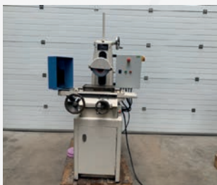
Rectifieuse plane HARIG SUPER 612 Courses X 300 mm - Y 170 mm Z 250 mm Meule \phi 200 mm Moteur de broche 3600 t/min
