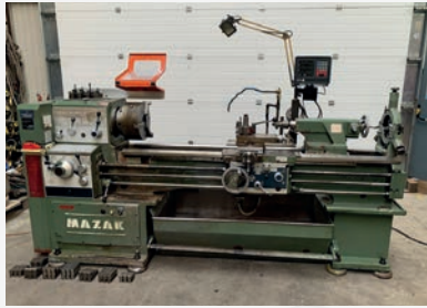
Tour parallèle MAZAK \phi 500 mm Entre-pointes 1500 mm \phi maxi sur le banc 500 mm \phi maxi au-dessus du trainard 240 mm
