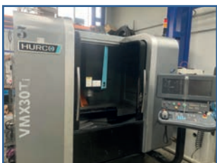
Centre d'usinage vertical Hurco VMX 30Ti 2013 CN WinMax 8 Mill - Table 1020 x 510 mm X 762 x Y 508 x Z 610 - Broche ISO 40 12k tr/min Changeur 30 outils - Arrosage centre broche
