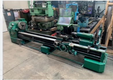
Tour parallèle ERNAULT SOMUA JUPITER 830 Entre-pointes 4000 mm \phi maxi sur le banc 830 mm \phi maxi au-dessus du trainard 500 mm Passage de broche \phi 80 mm
