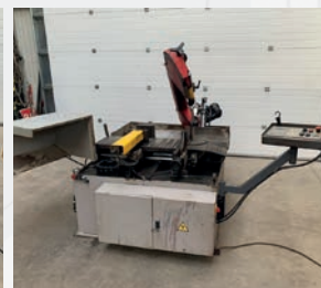
Scie à ruban automatique BOMAR Ergonomic 290.250.GANC Diamètre maxi 250 mm Coupe droite et angulaire Descente auto des avances
