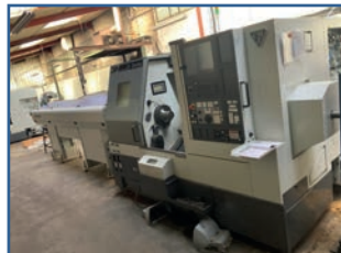
Tour CN CMZ bi-broches TA 15 MS 2017 avec 5000 h en Fanuc 32iTB Fraiseuse avec outils motorisés Embarreur lemca Boss 552/32 Diam 460 x entre-pointes 730 mm
