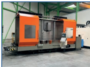
Centre fraiseuse 5 axes av table circulaire intégrée - Année 2013 CN Heidenhain iTNC 530 Table 3500 x 700 mm - X 3000 x Y 700 x Z 780 Broche BT 40 - 12.000 tr/min - 26 kW Tête B continu +/- 110° - Axe C 360° Ø 630 mm
