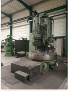
Tour vertical BERTHIEZ 9340/4 ø maxi de tournage 3200 mm Hauteur usinable 1660 mm Plateau ø 1800 mm Visu 2 axes HEIDENHAIN Course verticale du coulant 975 mm
