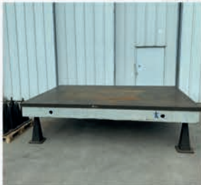
Marbre lisse en fonte STOLLE 3500 x 2500 x épaisseur 305 mm Hauteur sur pieds 900 mm Poids 6,3 T Fournis avec 12 pieds de nivellement
