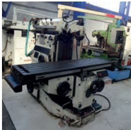
AV Fraiseuses HURON MU6 - 2 choix modèle avec variation des avances ou classique - Table : 2000 x 460 mm - X 1500 x Y 700 x Z 500 mm - Tête SA 50 avec préhension hydrau ou classique Visu 3 axes Heidenhain Tél : 04 77 29 56 74 Mail : info@mfl-industrie.com
