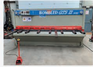
Cisaille hydraulique BOMBLED GTS II 3012 Capacité 3050 x 12 mm Course de la butée arrière ELGO 1000 mm
