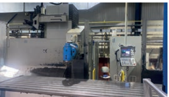
AV Fraiseuse banc fixe KIHEUNG U1000 Heidenhain TNC 426 - Tête auto Changeur 30 outils - Courses : 3100 x 1000 x 1600 mm - Tél : 06 63 65 11 01
