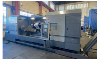
AV Tour CNC lourd à banc incliné 700L-MC Année 2011 - 6800 heures de coupe - CNC Fanuc Oi TD Manual Guide - \phi au dessus du banc : 1030 mm \phi maxi usinable : 900 mm - Longueur usinable : 3000 mm - Rotation de broche : 1500 rpm - Tourelle 12 postes BMT 85 - Mandrin hydraulique \phi : 460 mm - Axe C : 360 000 positions Tél : 06 09 14 93 74 Mail : info@techmologie.com
