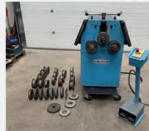
Cintreuse à galets ZOPF ZB 70/2M Année 1999 Capacité de cintrage ø 70 mm Diamètre des axes ø 40 mm Diamètre des galets 152 / 162 mm
