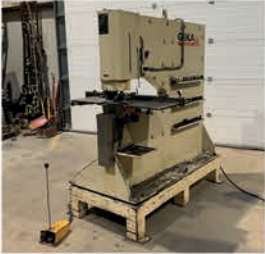
Poinçonneuse universelle GEKA 50/E-750 Capacité de poinçonnage 50 T Capacité de perçage ø 27 x 13 mm Profondeur col de cygne 750 mm
