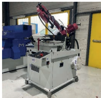
AV Scie à ruban coupe angles BEHRINGER SLB 230 DG - Sections : 280 x 210 - Angles : -45° à +60° RSMO-LG2B : 02 41 56 00 77 Mail : commercial@rsmolg2b.com
