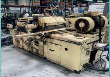
Rectifieuse centerless LIDKOPING 46 Occasion Largeur de meule 610 mm
