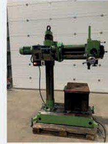
Perceuse radiale STANKO 2K52 Broche CM3 Sortie de broche 50 mm Course du bras 500 mm Colonne ø 180 mm
