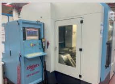
Stock no. : 22281 Machine : Centre d'usinage 5 axes Modèle : RÖDERS RFM 600 DSP Control : Roeders RMS6
