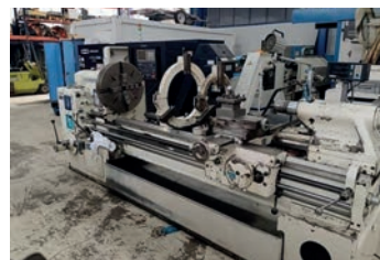
AV Tour parallèle conventionnel CAZENEUVE HB 725 x 2000 mm Banc rompu - Diam : 725/400 mm En excellent état - Mandrin 4 mors Rotation broche : 1250 tr/min - Visu 2 axes - Lunette - Bac copeaux - Prix : 15.000 € HT - Départ chargé Tél : 04 77 29 56 74 Mail : info@mfl-industrie.com
