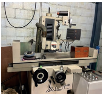
AV Rectifieuse plane OKAMOTO 450DX Auto - Visue - Capacité : 450 x 200 mm Tél : 06 63 65 11 01
