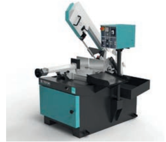
AV Scie à ruban IMET BS 350 SHI - Scie semi-automatique hydraulique - Étau hydraulique - Coupe d'angle maxi 45° à droite et 60° à gauche - Coupe à 0° : rond : 305 mm, carré : 250 mm, rectangle : 350 x 200 mm - Coupe à 45° gauche : rond : 250 mm, carré : 230 mm, rectangle : 230 x 200 mm - Coupe à 60° gauche : rond : 175 mm, carré : 155 mm, rectangle : 170 x 100 mm - Coupe à 45° droite : rond : 250 mm, carré : 230 mm, rectangle : 230 x 200 mm - Dimensions : 1480 x 1750 x 1900 mm - Poids : 650 kgs - Prix : 14 440 € HT Tél : 06 11 83 35 95 Mail : contact@ct-mo.fr
