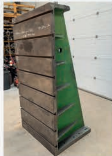
Equerre de bridage en fonte 2000 x 1000 x 860 mm Dimensions rainures en T 34 x 26 mm
