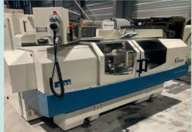
Rectifieuse cylindrique inter exteR STUDER S33 CNC Occasion Entre pointe 650 mm Hauteur de pointe 175 mm
