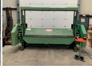
Presse plieuse hydraulique à tablier FAVRIN P4HS Capacité 2500 x 3 mm Course de la prince 200 mm
