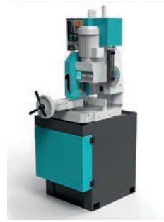
AV Fraise-Scie IMET SIRIO 315 SH Tronçonneuse semi automatique - Étau hydraulique - Coupe d'angle maxi 45° à droite et 60° à gauche - Coupe à 0° : rond : 108 mm, carré : 93 mm, rectangle : 150 x 90 mm - Coupe à 45° gauche : rond : 108 mm, carré : 93 mm, rectangle : 105 x 80 mm - Coupe à 60° gauche : rond : 93 mm, carré : 80 mm, rectangle : 75 x 90 mm - Coupe à 45° droite : rond : 108 mm, carré : 93 mm, rectangle : 105 x 80 mm - Dimensions : 800 x 900 x 1950 mm - Poids : 360 kgs - Prix : 8975 € HT - Tél : 06 11 83 35 95 Mail : contact@ct-mo.fr
