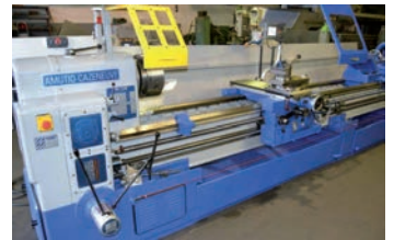
AV Tour parallèle CAZENEUVE - Type HB 725 x 4000 - Reconstitué - Distance entre pointe : 4000 mm - Hauteur de pointe : 315 mm - \phi admis au-dessus du banc : 725 mm - \phi admis dans le rompu : 920 mm - \phi admis au-dessus du trainard : 670 mm - \phi admis au-dessus du chariot : 400 mm - Alésage broche : 81 - Conicité de la contre pointe : CM6 Course maxi du chariot transversal : 400 mm - Nombre de vitesse de broche : 18 Rapides longitudinales Tél : 06 07 68 86 74 Mail : lgmo95@orange.fr
