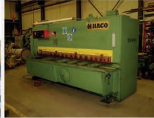
Cisaille hydraulique HACO TSL 3013 Capacité 3050 x 13 mm Course de la butée arrière 1000 mm
