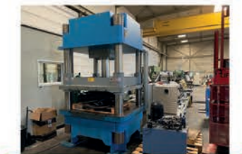
Presse hydraulique 4 colonnes 300 tonnes SICMI
