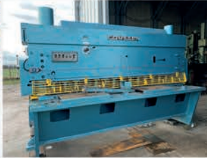
Cisaille hydraulique COMESSA CP 316 Capacité 3000 x 16 mm Course de la butée arrière 1000 mm
