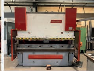
Presse plieuse hydraulique BEYELER PR6 100/2550 Capacité 100 T x 2550 Commande CYBELEC DNC 804 PS/K 6 Année 1998
