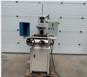
Rectifieuse plane HARIG SUPER 612 Courses X 300 mm - Y 170 mm - Z 250 mm Meule ø 200 mm Moteur de broche 3600 t/min
