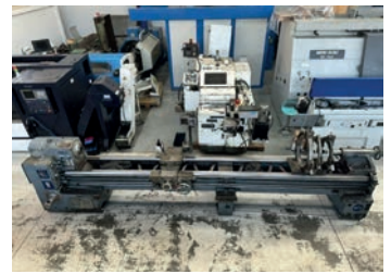
AV Tour parallèle conventionnel CAZENEUVE HB 725 x 4000 mm - Banc droit 725/400 mm - Mandrin 3 ou 4 mors - Rotation broche : 1250 tr/min Visu 2 axes - Lunette - Bac copeaux Prix : 22 000 € HT - Départ chargé Tél : 04 77 29 56 74 Mail : info@mfl-industrie.com
