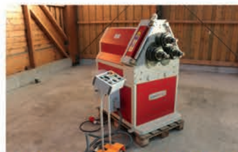
Cintreuse à profilés hydraulique d'exposition type 61
