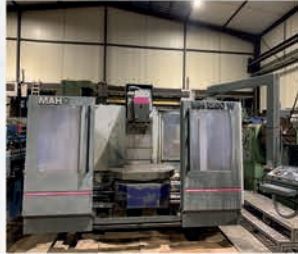
Fraiseuse CNC MAHO MH 1200W Courses X 1200 mm - Y 600 mm Z 600 mm CNC PHILIPS CNC 532 Table ø 1000 x 800 mm Vitesse de rotation de 20 à 4000 t/min
