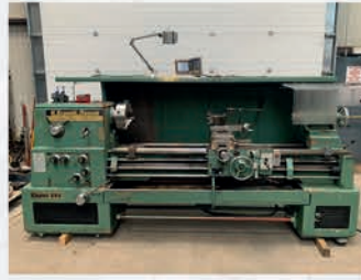
Tour parallèle ERNAULT SOMUA CHOLET 660 Entre-pointes 1800 mm ø maxi sur le banc 660 mm ø maxi au-dessus du trainard 360 mm Passage de broche ø 51 mm
