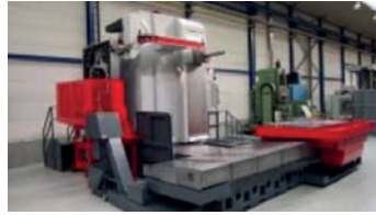
AV Aléuseuse Fraiseuse CNC - Type HBM-4 T - CNC Fanuc 31 iMB manuel guide - Broche \varnothing : 130 mm - Courses : X 3000 Y 2000 Z 2000 W 700 mm - Table : 1600 x 1800 x 0,001° - Rotation : 3000 t/mn - Puissance : 30 kw - Changeur d'outils 60 postes ISO 50 Tél : 06 09 14 93 74 Mail : info@techmologie.com
