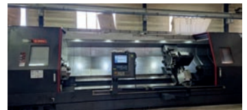
AV Tour CNC SMEC SL-6500AL - Année 2022 - CNC Fanuc OiTF - \phi de passage au dessus du banc : 1030 mm - \phi de tournage maxi : 900 mm - Longueur de tournage maxi : 5 050 mm - Vitesse de broche maxi : 1500 tr/min - \phi du mandrin : 535 mm (21") - Puissance maxi du moteur AC : 55 kw - Nombre de postes : 12 BMT 85 Tél : 06 09 14 93 74 Mail : info@techmologie.com
