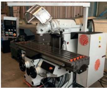
AV Fraiseuse HURON MU6 - Visue Variateur - Table : 2000 x 460 mm Tél : 06 63 65 11 01
