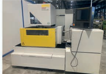
Machine électro érosion FANUC ROBOCUT C600ic - Occasion Année 2022 Courses : X = 600, Y = 400, U = 200 V = 200, Z = 310 mm
