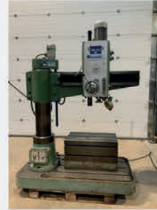
Perceuse radiale WAGNER PRC 35 Broche CM4 Sortie de broche 220 mm Course du bras 700 mm Colonne ø 230 mm
