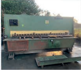
Cisaille hydraulique HACO HS 3010 Capacité 3000 x 10 mm Course de la butée arrière 1000 mm
