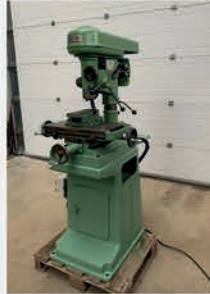
Perceuse fraiseuse SYDERIC S120 UB Broche ø 55 mm - Cône SA30 Sortie de broche 130 mm Profondeur col de cygne 210 mm
