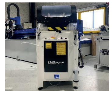
AV Scie mono-tête aluminium GEAM EVOLUTION - ORCA 500A - Semi automatique - Lame : 500 mm - Coupe angles - RSMO-LG2B : 02 41 56 00 77 Mail : commercial@rsmolg2b.com
