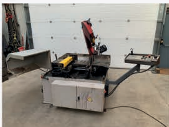
Scie à ruban automatique BOMAR Ergonomic 290.250.GANC Diamètre maxi 250 mm Coupe droite et angulaire Descente auto des avances
