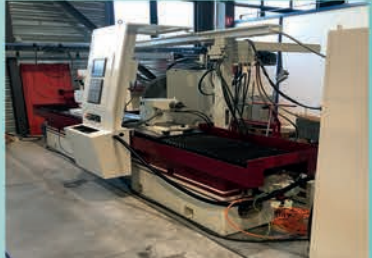
Rectifieuse cylindrique STUDER S-50 Rétrofitée Occasion Entre pointe 1600 mm Hauteur de pointe 225 mm
