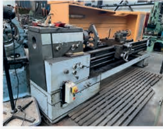
Tour parallèle MULLER & PESANT ø 520 mm Entre-pointes 2500 mm ø maxi sur le banc 520 mm ø maxi au-dessus du trainard 280 mm Passage de broche ø 56 mm
