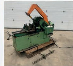
Scie alternative KASTO PSB 280 U Capacité rond 280 mm Capacité carré 240 x 240 mm Descente automatique 2 vitesses de rotation
