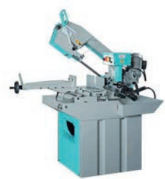
AV Scie à ruban IMET GBS 242 GH Scie manuelle à descente contrôlée hydraulique - Coupe d'angle maxi 45° à droite et 60° à gauche - Coupe à 0° : rond : \varnothing 250 mm, carré : 210 mm, rectangle : 290 x 210 mm - Coupe à 45° gauche : rond : 220 mm, carré : 200 mm, rectangle : 210 x 200 mm - Coupe à 60° gauche : rond : 140 mm, carré : 130 mm, rectangle : 140 x 130 mm - Coupe à 45° droite : rond : 170 mm, carré : 170 mm, rectangle : 170 x 170 mm - Dimensions : 1500 x 1250 x 1700 mm - Poids : 290 kgs - Prix : 5 380 € HT Tél : 06 11 83 35 95 Mail : contact@ct-mo.fr
