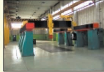
Portique fraiseuse JOBS type Jomach 35 Cnc Heidenhain 430 - 1998 X 9000 - Y 3000 - Z 2000 - cone 40 12 000 tr/mn - puissance 7.5 Kw
