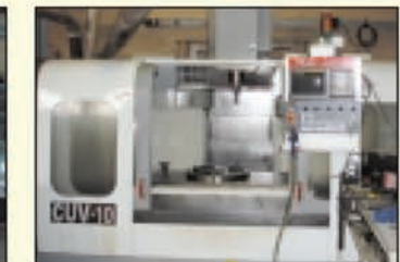
C U vertical HEAD type CU V 10 - 2000 - Fanuc OM X 1 020 Y 510 Z 510 - 8 000 tr/mn convoyeur a copeaux - Broche 8 000 tr/mn boite de vitesse - arrosage centre broche
