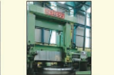
Tour vertical SCHIESS model 3000 CNC Cnc Fagor 8025 Ti / totalement retolfité en 1997 Diam plateau 3 400 mm / diam de tournage 3 000 mm Hauteur de passage 2 200 mm / puissance moteur 55 Kw Convoyeur a copeaux - excellent état
