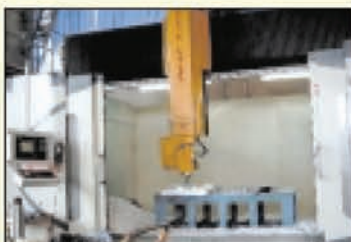
Portique fraiseuse 5 axes BRETON mod NC 1300 2T/KM Siemens 840D - année 2000 broche 6 000/12 000 tr/mn - 12 / 6 kw X 3 500 - Y 1 800 - Z 1 1500 - A +/- 90° - C +/- 195 °
