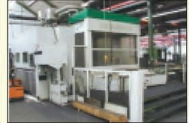
CU Horizontal DORRIES SCHARMANN SOLON 2 - 1995/1996 Cnc SIEMENS 840C - 2 palettes 800 x 630 - Chgr 161 outils X 1 200 / Y 1 300 / Z 1 000 - B 360 000 ° - vitesse broche 5 800 tr/mn Convoyeur a copeaux - arrosage centre broche 50 bars - cone HSK 100 A Puissance broche 40 kw avec boite de vitesse 2 gammes - mesureur outils -
