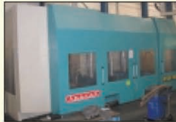
Fraiseuse CNC ANAYAK type HVM-5000 P / 2001 X 4 300 / Y 1 500 / Z 1 360 / 8 000 tr/mn tête Indexable 1 ° Cnc TNC 430 - Chgr 10 outils - arrosage centre broche
