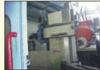
Fraiseuse CNC NOVAR KBF 3000 / 800 - TNC 407 - 1995 Surface table 3000 x 800 - X 2 950 - Y 800 - Z 800 chgr de 24 outils - tete indexable 2.5 ° - cone type 50
