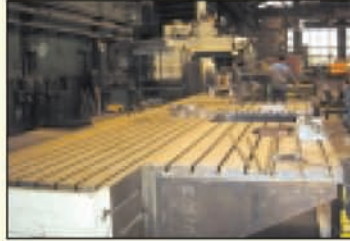
Fraiseuse banc fixe ZAYER KMU 14 000 / 1990 X 12 300 / Y 1 500 / Z 2 000 / chgr 60 outils tete indexable auto / table 4 eme axe - TNC 407
