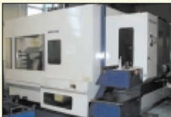
CU Horizontal MORI SEIKI MH 630 - 1998 Cnc Fanuc MSC 502 - 2 pal 630x630 - X 1 000 - Y 850 - Z 420 Chgr 60 outils B 360.000° - centre broche 50 bars - convoyeur a copeaux
