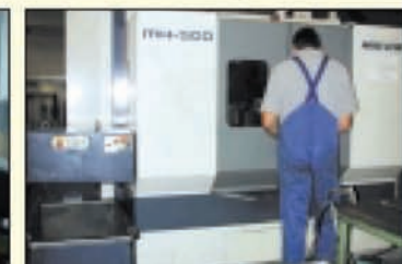
CU Horizontal MORI SEIKI MH 500 - 1998 2 pal 500x500 - X 800 - Y 650 - Z 750 Cnc Fanuc MSC 502 B 360.000° - centre broche 50 bars - convoyeur a copeaux
