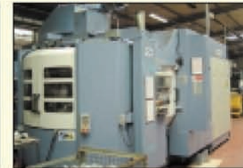
CU horizontal CNC MCM modele AUTO CLOCK 600 1999 - cnc Fanuc 16 IM - 2 palettes de 500x500 B 360.000° - chgr de 40 outils - X 1 340 - Y 600 - Z 700 broche 15.000 tr/mn - rapide axe 50m/mn - convoyeur a copeaux
