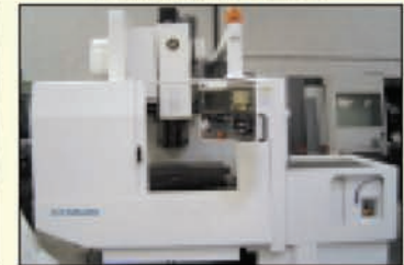
CU vertical KITAMURA My center 3 X / OM 1996 - 2 palettes 800 x 400 / X 760 / Y 455 Z 460 / 10.000 tr/mn / ATC 24 outils
