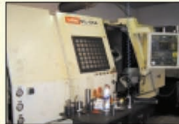
Tour cnc YANG type ML 55 A - 1997 FANUC OT - EP 1200 - Diam barre 90 Diam / banc 720 - Diam / chariot 550 Tourelle 12 outils / puissance broche 26 Kw
