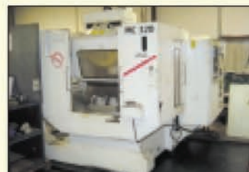
CU vertical STAMA type MC 320 / 1991 Cn Fanuc OM / 2 palettes type rotapalette X 500 / Y 300 / Z 350
