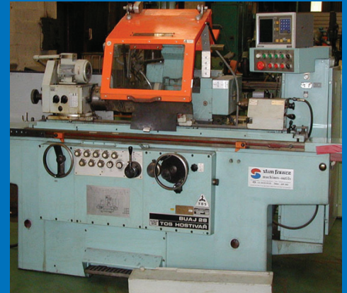
Rectifieuse cylindrique universelle TOS BUAJ 28 Ø s/banc : 280 mm / Entre-pointes : 1000 mm / Broche inter haute-fréquence : 20 000 Tr/mn
