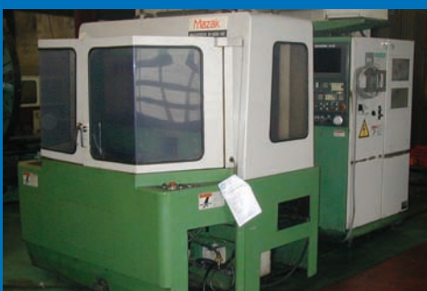
Centre d'usinage horizontal 4 axes MAZAK H500/40 avec CNC MAZATROL M32 Courses : X 560 - Y 460 - Z 510 / 2X palettes 400 x 400 / 4ème axe 360 000 pos. / changeur 30 outils
