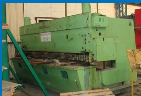
Cisaille-guillotine mécanique COMESSA CP 4000 x 12 / Butées électriques
