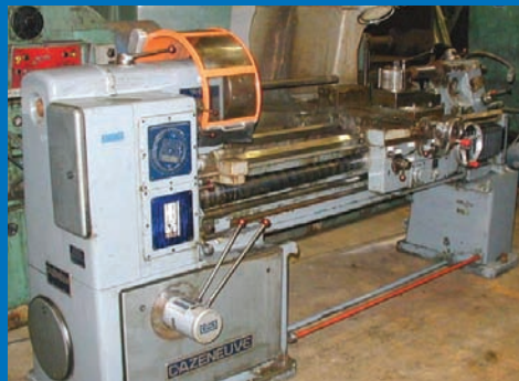
Tour CAZENEUVE HB 575 Ø s/banc : 575 mm / Entre-pointes : 1500 mm / visu 2 axes / contre-pointe pour perçage sensible
