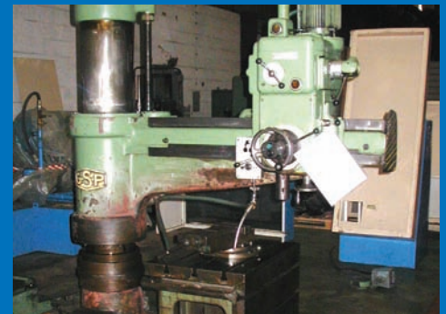
Perceuse radiale GSP 405 T125 Bras 1250 mm / Portée max. 1400 / blocage hydraulique
