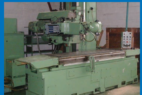
Fraiseuse banc fixe GRAFFENSTADEN FB 616 2D Courses : X 1600 - Y 700 - Z 900 - Table : 2200 x 630 Variation des avances / visu 3 axes
