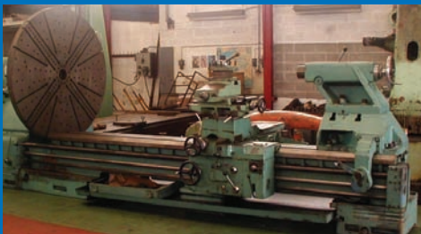
Tour SCULFORT SUPERCAP 750 R Ø s/banc : 1500 mm / Entre-pointes : 3000 mm / Ø dans rompu : 1800 mm / mouvement rapide
