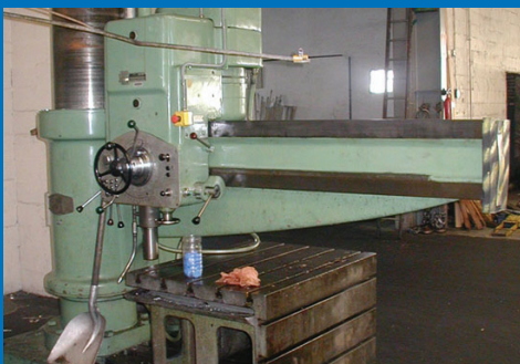
Perceuse radiale GSP 407017 Bras 1750 mm / Portée max. 1950 / blocage hydraulique
