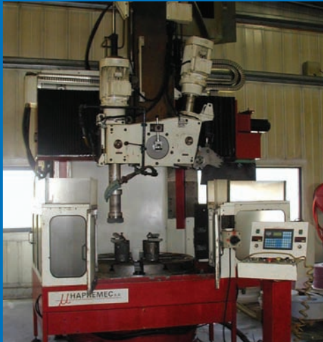
Rectifieuse intérieur verticale CNC TITAN avec CNC ALSTHOM CYBER 3000 Ø plateau : 1400 mm / 2 broches 11 Kw
