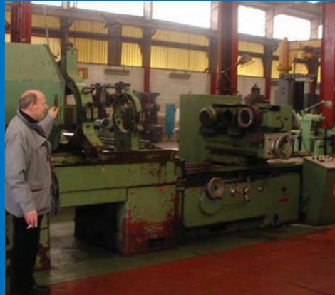
Rectifieuse intérieur horizontale WOTAN S30813L15 Ø à rectifier 700 mm / Ø s/banc 1200 mm / Profondeur à rectifier : 800 mm
