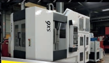
Centre rotopalette HURON SX6 CNC Siemens 840D - 12 000 tr Arrosage centre - Table 650 x 400
