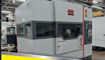
Centre QUASER MV 184 P - 2012 MB M Guide-ST - 1200 x 600 Palpeur - Arrosage centre - Convoyeur
