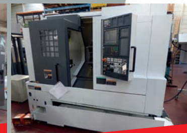
Tour MORI SEIKI Type NL 1500MC 500 - CN FANUC MSX-850 III ø maxi d'usinage 356 mm Longueur d'usinage 504 mm - Axe C
