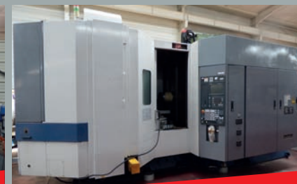
Centre d'usinage horizontal MORI SEIKI SH630 CN FANUC MSC 502 - Palette 630 x 630 Courses 840 x 760 x 840 - Cône BT50
