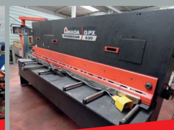
Cisaille guillotine AMADA GPX 630 Capacité 3000 x 6 mm - Réglage de l'angle de coupe et du jeu entre lames automatiques
