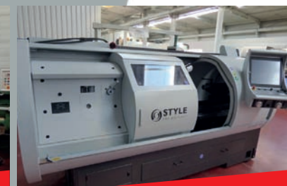
Tour par apprentissage CNC STYLE 510 Année 2017 - CN STYLE CONTROL Longueur entrepointe 1350 mm - Vitesse de rotation de broche 2500 trs/min
