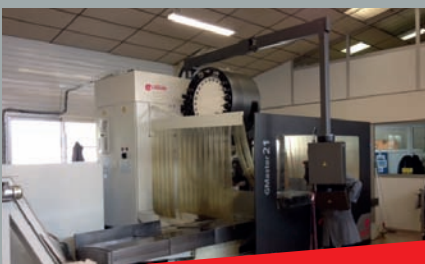
Fraiseuse à banc fixe LAGUN Type G Master 21 Surface de la table 2100 x 900 mm Courses 2000 x 1000 x 1000 mm
