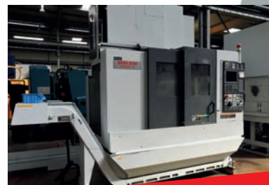
Centre d'usinage vertical MORI SEIKI Type NV5000 Alpha 1A/40 CN FANUC MSG 501 - Table 1900 x 600 mm Courses 800 X 510 X 510 mm Chargeur de palettes
