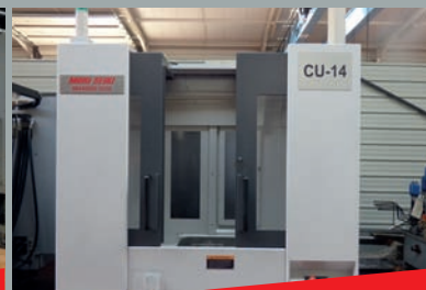
Centre d'usinage horizontal MORI SEIKI Type NH4000 DCG - Dimensions palette 400 x 400 mm CN MSX 501 III - Courses 560 x 560 x 630 mm ø Broche 20 000 trs/min - Arrosage centre broche 4 ème axe continu
