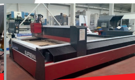
Machine découpe jet d'eau WATERJET SUPREMA DX612 - CN MITSUBISHI 720M Capacité 4000 x 2000 mm Pompe HP KMT 6200 bars - 45 Kw
