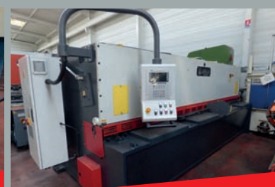
Cisaille guillotine DENER NC 4106 Positionneur ESA 530 - Capacité 4160 x 6 mm Butée arrière programmable Réglage du jeu entre lames motorisé
