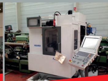
Centre d'usinage 5 axes REALMECA Type RM5H - CN Heidenhain Courses 300 x 200 x 250 mm - Axe A 360 000 positions - Axe B
