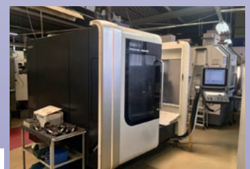
CU DMU 50 - 5 axes De 2010 CNC Mill Plus Courses 500 x 450 x 400 10 000 tr/min - ISO 40
