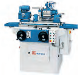
AV Rectifieuse KNUTH Multi-Grind - ø maxi de la pièce : 200 mm - Longueur max de la pièce : 500 mm Cône de la poupée de travail : CM 2 - ø mandrin : 100 mm - Course manuelle poupée de rectification : 200 mm (verticale et transversale) - Course fourreau : 14 mm - Tél : 05 62 23 73 33
