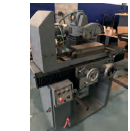
AV Rectifieuse plane SIT - Lg table 450 x largeur table 160 mm - Table 400 x 130 avec plateau magnétique 250 x 130 mm Bac d'arrosage - TBE - Prix : 4 000 Euros Tél : 06 88 94 32 50 - Mail : info@mfl-industrie.com
