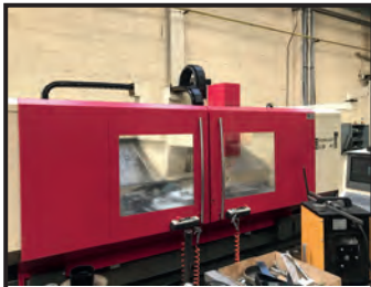
CU vertical HEDELIUS - CN Heidenhain - Table 3900 x 750 mm - Broche 8000 tr/min Changeur 30 outils ISO 40 - Arrosage centre X 3200 x Y 800 x Z 600 mm
