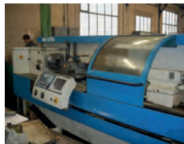
AV Tour CNC par apprentissage STANKO Krasny - De 2006 - CNC Fagor 8055TC - EP : 2000 x dia 600 mm Tél : 03 88 72 02 47
