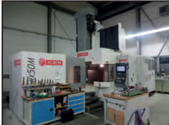
Centre de fraissage portique 5 axes HURON KX 50 X 2000 x Y 1700 x Z 800 mm - Table : 2200 x 1250 mm - Electrobroche Kessler 20.000 rpm
