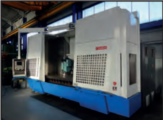
Fraiseuse 4 axes HURON EX 30 - CN Heidenhain X 2400 x Y 700 x Z 800 - Table : 2800 x 750 Puissance 25 Kw - Cône HSK63 - Changeur
