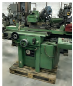
AV Rectifieuse plane MONOPRECIS - Type RHE 200 Surface utile de la table : 500 x 200 - Course longi- tudinale : 540 mm - Course transversale : 240 mm Distance maxi de la table sous meule : 400 mm Vitesse de la meule : 2740 tr/mn - Prix : 3 000 Euros HT - Tél : 03 88 72 02 47
