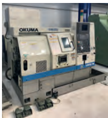
AV Tour CNC 3 axes OKUMA LB10 - Année 1999 Diam : 170/340 x longueur EP 300 mm - Axe C - Outils tournants - Embarreur LNS - Bon état - Super prix Tél : 06 88 94 32 50 - Mail : info@mfl-industrie.com
