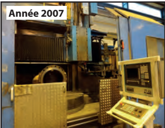
Année 2007 Tour vertical TITAN SC 22 - CNC Siemens 840D Diam plateau : 2000 mm - Charge : 12 T Rotation maxi : 140 tr/min Broche fraissage : 2000 tr/min - Axe C
