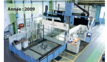
Centre d'usinage à portique 5 axes simultanés HEYLINGENSTÄDT pour tournage et fraisage
