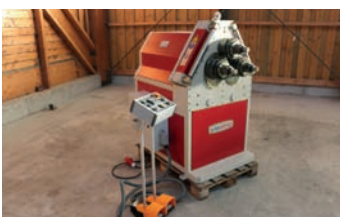
Cintreuse à profilés hydraulique d'exposition type 61
