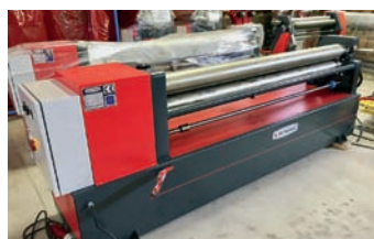
Rouleuse-croqueuse asymétrique AKYAPAK ASM 140-20/4.0
