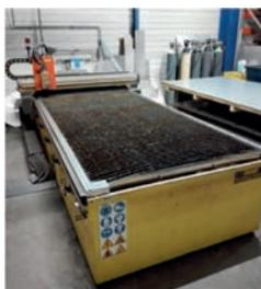
AV Plasma Expert SOITAAB - Année 2009 - 3500W - Table 1500 x 3000 - Générateur KJELLBERG Hifocus 80. Torche PERCUT 90. Epaisseur de découpe 0.5 mm à 25 mm Prix 12 000 Euros HT. Contact b-technologie. Tél : 06 09 79 32 81
