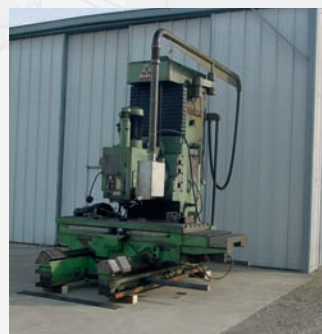
Fraiseuse verticale DROOP & REIN FS130 Courses X 2000 mm - Y 1000 mm Z 1000 mm Broche SA 50 Table 2400 x 1070 mm Visu 3 axes HEIDENHAIN
