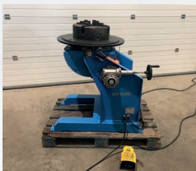
Positionneur à table tournante AUTOMA SP 500 M Année de construction 2015 Capacité 500 kg Ø du plateau 650 mm Inclinaison maxi 110°
