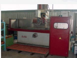
Rectifieuse plane ELB HAHN & KOLB FS1052 Courses X 1000 mm - Y 500 mm - Z 350 mm Année de construction 1989 Table 1600 x 550 mm Axes X-Y-Z : prise de passe auto
