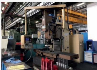
Fraiseuse verticale CNC RAMBAUDI RAMMATIC 600 Course X 1260 mm - Y 690 mm - Z 600 mm CN NUM 1060 Année 1991
