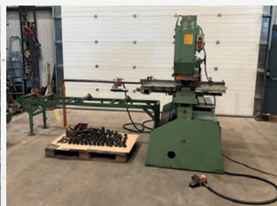
Cisaille/poinçonneuse PEDDINGHAUS PEDDIMAX 800 Capacité de poinçonnage Ø 31 x 20 mm Ø 100 x 6 mm Table 1000 x 430 mm Butée règle manuelle
