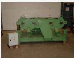
Vibrateur 4 bacs WALTHER type TA.4/72 Dimensions bacs : 800 x 250 x Ht 300 mm Armoire électrique neuve
