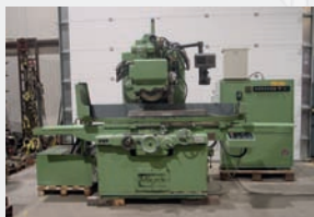
Rectifieuse plane MAGERLE FP 10R S1 Courses X 1000 mm - Y 300 mm Z 265 mm Visu 2 axes HEIDENHAIN Plateau magnétique BRAILLON 1000 x 300 mm Axes X-Y-Z : prise de passe auto
