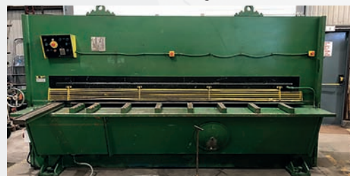
Cisaille hydraulique HACO TS 3012 Capacité 3050 x 12 mm Butée arrière électrique Course 940 mm
