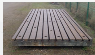
Taqes en fonte rainurées 6620 x 2700 x épaisseur 260 mm - 19 T 6030 x 2960 x épaisseur 350 mm - 22,5 T + autres dimensions disponibles
