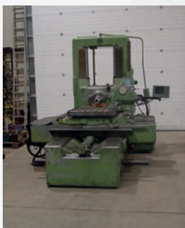
Pointeuse DIXI type 75 ON Courses X 780 mm - Y 680 mm Z 430 mm Sortie de broche 750 mm Table rotative 870 x 700 mm
