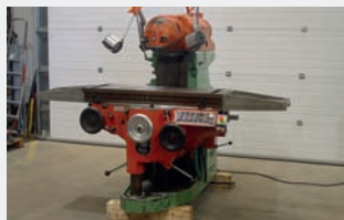
Fraiseuse universelle HURON NU3 Courses X 900 mm - Y 700 mm Z 500 mm Broche SA 40 Table 1235 x 460 mm Vitesse de rotation de 30 à 2066 t/min.
