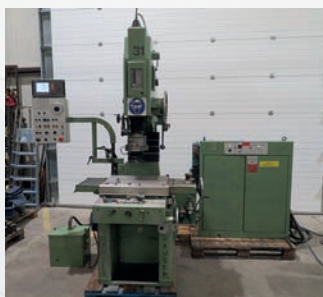
Rectifieuse par coordonnées HAUSER 3SM Courses X 400 mm - Y 250 mm Ø maxi de rectification 200 mm Visu 2 axes HEIDENHAIN
