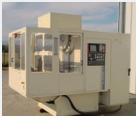
Centre d'usinage horizontal REALMECA type CU300H Course X 320 mm - Y 350 mm - Z 250 mm CN NUM 1060 Série II Année 1998
