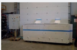
Vibrateur 4 bacs WALTHER type TA.4/72 Dimensions bacs : 800 x 250 x Ht 300 mm Armoire électrique neuve
