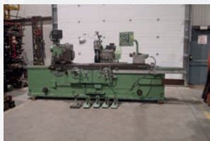
Rectifieuse cylindrique CONSTRUCTIONS DE CLICHY Entre-pointes 1500 mm Ø maxi de rectification 450 mm Table inclinable
