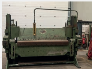
Pliieuse à tablier FAVRIN PHMM 2050 x 10 Capacité de pliage 2050 x épaisseur 10 mm Angle de pliage 0 à 110°
