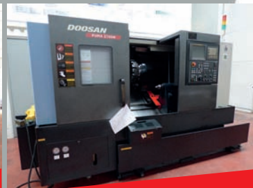
Tour CN DOOSAN PUMA 2100M CN FANUC OITD - Ø Maxi d'usinage 406 mm - Longueur maxi 520 mm Axe C - Outillage
