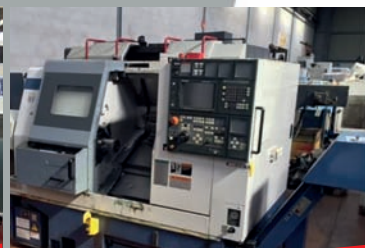
Tour MORI SEIKI SL150MC CN MSD-50III - Ø maxi en tournage 430mm - Distance entrepointe 560mm Nombreux outillage
