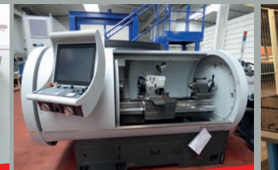
Tour par apprentissage CNC STYLE 350 - Année 2015 ø sur banc 350 mm - Longueur entre pointes 850 mm - VDI 30
