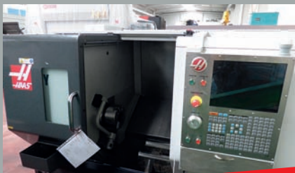
Tour HAAS ST-30Y Ø d'usinage max 457mm - Longueur d'usinage 584mm - Axe C - Axe Y Outillage
