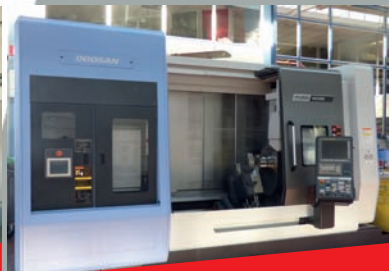
Centre de tournage fraisage DOOSAN SMX 2600S - CNC FANUC 311B Ø maxi d'usinage 660 mm - ø en barre 81 mm Longueur maxi 1540 mm - Magasin 80 outils Lunette AUTOBLOCK
