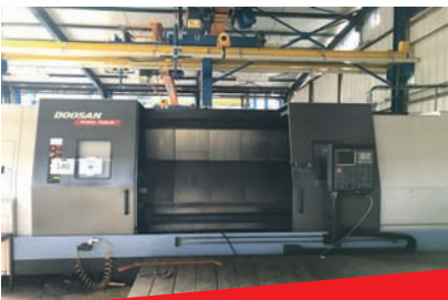
Tour DOOSAN PUMA 700LM CN FANUC 321A - Ø maxi d'usinage 900mm - Longueur maxi 3200-Axe C Année 2013
