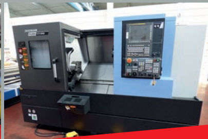
Tour DOOSAN PUMA GT2100B CN FANUC I Series Ø maxi d'usinage 390 mm Longueur maxi 550 mm
