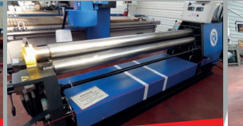
Rouleuse hydraulique 3 rouleaux ROUNBLED R2003 Longueur utile 2100 mm Épaisseur 2 mm
