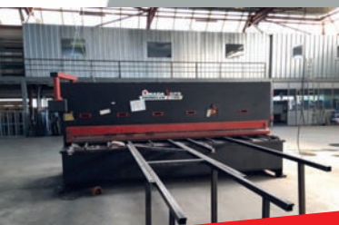
Cisaille guillotine AMADA GPS640 Capacité 4000 x 6mm Réglage de l'angle de coupe et du jeu entre lames manuel
