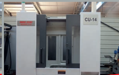
Centre d'usinage horizontal MORI SEIKI NH4000 DCG - Dimensions palette 400 x 400 mm CN MSX 501 III - Courses 560 x 560 x 630 mm Broche 20 000 trs/min - Arrosage centre broche 4 ème axe continu
