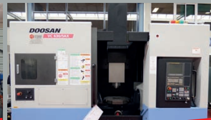
Centre d'usinage vertical DOOSAN VC630-5AX CN FANUC I Series - ST 630 x 590mm Courses 650 x 765 x 520 mm - Année 2015
