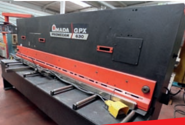
Cisaille guillotine AMADA GPX 630 Capacité 3000 x 6 mm Réglage de l'angle de coupe et du jeu entre lames automatiques
