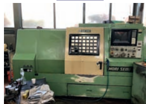
AV TOUR CNC 2 AXES MORI SEIKI TYPE SL 25 - Année : 1988 - diamètre maxi en barre : 68 mm - diamètre admissible au dessus du banc : 520 mm - diamètre sur glissière transversal : 350 mm - diamètre usinable standard : 260 mm - distance entre pointe : 500 mm - vitesse de broche : 35-3500 tr/min - puissance broche : 15/11 kw - type de broche : A2-6 - alésage de broche : 80 mm - tourelle : 12 postes - course fourreau contrepointe : 100[m - commande CNC FANUC 10 T Graphique Conversationnelle - mandrin 3 mors diamètre 200 [mm] - contre pointe CM4 à fourreau hydraulique - palpeur outils - convoyeur à copeaux. Prix : 9 900 Euros. Tél : 01 34 08 42 44
