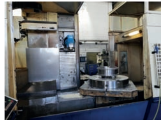
AV Fraiseuse HURON TXD 635 - Année 1999 - CNC Num 1060 - X 2500, Y 1000, Z 1500 mm - Broche : 28 kw - Table : 1500 x 1500 mm. Tél : 06 63 65 11 01
