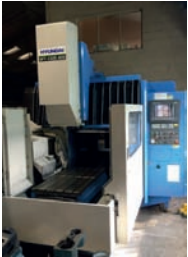
AV CENTRE D'USINAGE «HYUNDAI» SPTV 32S - CN Siemens 840 C - Courses 1000 x 799 x 460 mm - 22 kW - Magasin 30 outils - Surface des palettes 1240 x 650 mm - Course X 1000 mm - Course Y 700 mm - Course Z 460 mm - Vitesse de broche 22 à 3150 t/mn - Puissance broche 20 kW - Commande numérique 840 C - Programmation conventionnelle simplifiée - Ecran 14" - Convoyeur à copeaux - Plus de 50 cônes BT 50. Tél : 06 07 68 86 74
