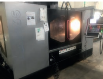
AV Centre d'usinage Vertical WELE Type AA 1365 - Année ; Juillet 2012 - Surface de table 1450 x 650 mm * Courses : 1300 x 650 x 600 mm - Charge admise sur la table 1300 kg - Puissance 11/15 KW * Vitesse de broche 8000 tr/min * Boite de vitesse 285 N/M- BT40 - Boite de vitesse 285 N/M- BT40 - CNC Fanuc 18 IM+Ecran Couleur 10.4"+Manuel Guide i - Convoyeur à copeaux - Arrosage centre broche 20 bars - Année 07/2012. Tél : 06 07 68 86 74
