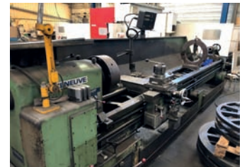
AV TOUR PARRALELE CAZENEUVE Type HB 725 X 4000 - Distance entre pointe 4000 mm - Hauteur de pointe 315 mm - Diamètre admis au-dessus du banc 725 mm - Diamètre admis dans le rompu 920 mm - Diamètre admis au-dessus du trainard 670 mm - Diamètre admis au-dessus du chariot 400 mm - Alésage broche 81 - Conicité de la contre pointe CM6 - Course maxi du chariot trans- versal 400 mm - Nombre de vitesses de broche 18 - Rapides longitudinales - Armoire neuve séparée, Visu, lunette - Vis Mère protégée. Tél : 01 34 08 42 44
