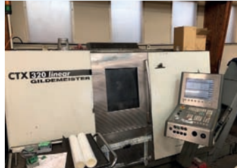
Tour CNC DMG CTX 320 V6 Avec axe Y - Outils motorisés Dia 250 x 700 mm CNC Siemens 840 TBE
