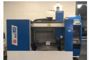
CUV HURON KX 10 De 2007 Courses 1000 x 700 x 550 CNC Siemens 840 D Shopmill
