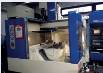
CUV 5 axes HURON KX 15 De 2002 CNC Siemens 840D Shopmill Courses 1000 x 800 x 550 mm
