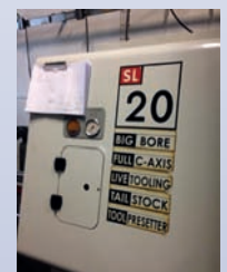
Tour CNC HAAS SL 20 De 2004 3 axes Ø 300 X EP 550 mm TBE
