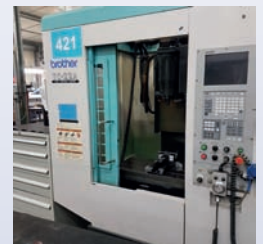
CUV BROTHER TC22A Commande Brother CNC A00 - Année 1999 Table 400 x 650 mm - Courses 500 x 400 x 410 mm - Broche BT 30 - 12 000 tr/min - Magasin 25 outils - Diviseur 4 ème axe continu Nikken Plateau 220 mm - Manivelle électronique
