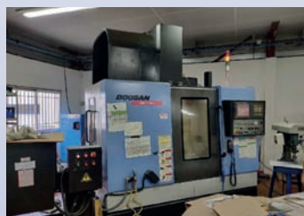
CUV DOOSAN DAEWOO Type NM 410 HS de 2008 Courses 762 x 410 x 510 Broche 20 000 tr/min CNC Fanuc 21 IMB
