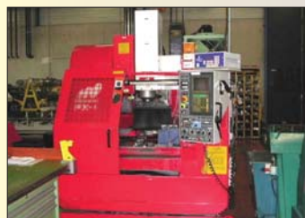
Centre Vertical MATSUURA Type FX 4ème axe LEHMANN
