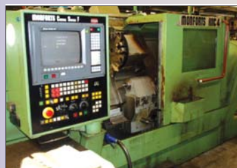
Tour MONFORTS RNC 4 FANUC 15T - 400 x 700 Embarreur IRCO
