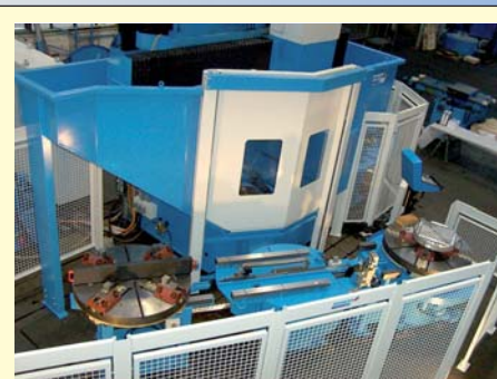
BERTHIEZ LVM 125 P (1987/2007), palettisé, Ø 1 250 / 1 600 mm, axe C, outils tournants, CN SIEMENS 840 D . Entièrement reconstruit et rétrofié
