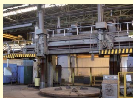
SCHIESS Ø 4 000 / 4 400 mm, hauteur 2 890 mm, charge 45 T, double montant, chariot latéral.
