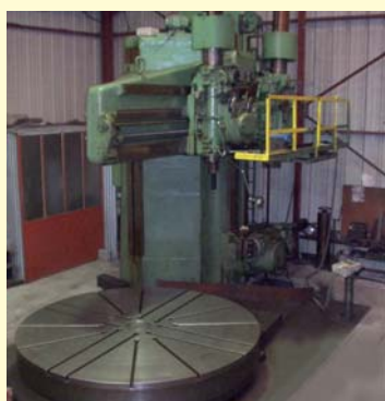
BERTHIEZ 8630 Ø 2 800 / 8 000 mm, hauteur 2 000 mm, double coulant sur traverse, chariot latéral, VISU.
