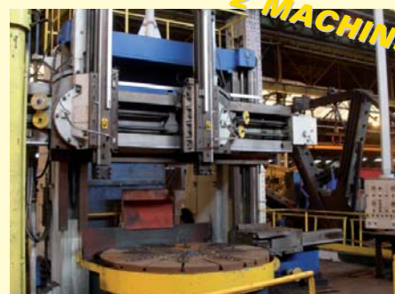
STANKO 1525 Ø 2 240 / 2 500 mm, hauteur 1 600 mm, charge 13 T, double montant, chariot latéral, VISU 4 axes.
