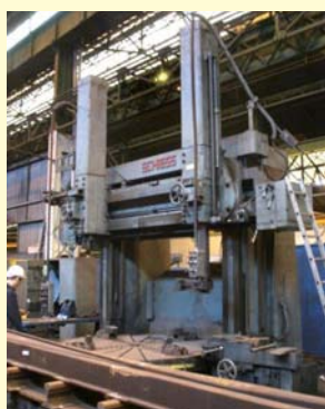
SCHIESS KZ 250 (1960) Ø 2 500 / 2 740 mm, hauteur 1 750 mm, charge 10 T, double montant, chariot latéral.
