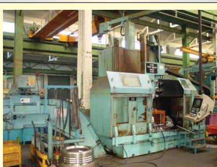
BERTHIEZ TFM 160 (1980/1993) Ø 1 650 / 1 880 mm, hauteur 1 600 mm, chang. d'outils 12 positions, 55 kW, CN NUM 760 .
