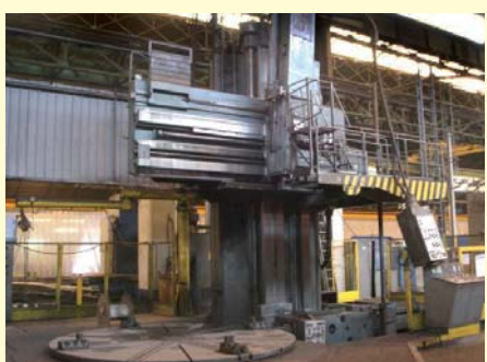
SCHIESS 2VKE 400/800 (1972) Ø 4 000 / 8 000 mm, hauteur 3 500 mm, charge 70 T, un montant et colonne déplaçable, chariot latéral avec copieur, copieur sur chariot de la traverse.
