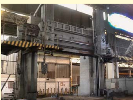
SCHIESS 4K600 (1963), Ø 6 000 / 6 300 mm, hauteur 3 000 mm, charge 60 T, double montant, chariot latéral, filetage, tournage conique.
