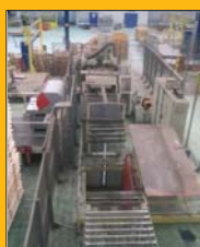
Ligne de coupe à longueur DIMECO 1 000 x 1,5 mm
