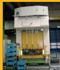
Presse hydraulique arcade 200 T DIEFFENBACHER Table 2 x 1 m
