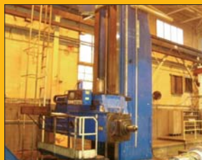
Alésuseuse CNC PAMA Montant mobile, ø 152 mm Courses X / Y : 8 / 3,6 m Table rotative
