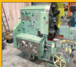
Tour parallèle STANKO modèle 165 - Hauteur de pointe 600 mm Entre pointes 5 m
