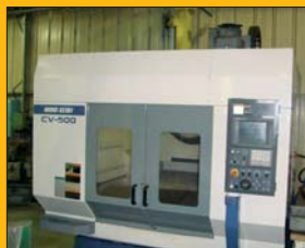
Centre d'usinage vertical MORI SEIKI CV 500B Courses 1,020 / 0,510 / 0,510 m
