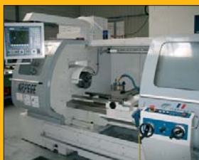
Tour CNC ARPEGE apprentissage ø 425 mm - Entre pointes 1 150 mm CNC FAGOR 8055
