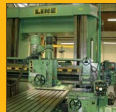
Fraiseuse Portique LINE type 11120 RF 6 Courses x 6 m - Entre montants 2 m - 3 têtes - 22 kw
