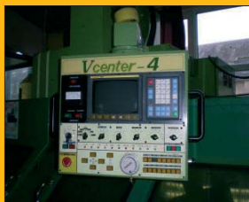
Centre d'usinage vertical VICTOR 4 CNC FANUC OM Courses 0,7 / 0,450 / 0,450 m
