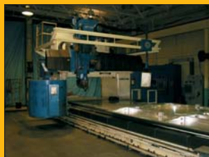
Fraiseuse à portique LINE CNC SERAMILL 240 Courses 8 / 2,5 / 0,9 m - Changeur
