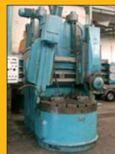
Tour vertical DORRIES SD 125 ø 1,4 m - Hauteur 1,180 m Tourelle revolver et chariot de perçage
