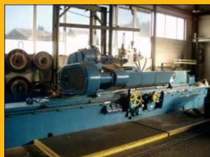
Rectifieuse extérieure GENDRON ø 600 mm - Entre pointes 3 m
