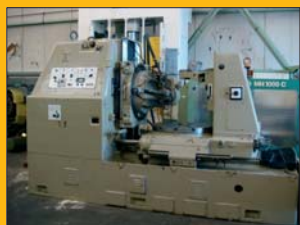
Tailleuse fraise mère WMW ø 1250 mm - Module 14
