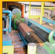
Ligne de refendage AUXMET 1 500 x 1,5 mm - Poids coil 15 tonnes
