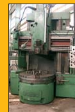
Tour vertical BERTHIEZ BMF 125 ø 1,6 m - Hauteur 1,5 m - Tourelle automatique 4 positions
