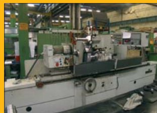
Rectifieuse extérieure TOS Type BUB 50 ø 500 mm - Entre pointes 2 m
