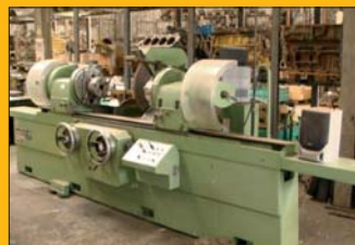
Rectifieuse de vilebrequin SCLEDUM ø 560 mm - Entre pointes 2 m
