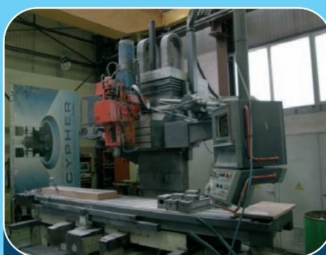
Fraiseuse banc fixe RAMBAUDI RAMMATIC 800 (1991) avec CNC FIFIA FNC 260 Courses : X 2 000, Y 800, Z 800 Table : 3 600 x 800 mm - Changeur 30 outils
