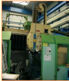
Tour BERTHIEZ tfm100 Num 1060 - Changeur 12 outils Cap maxi 1 250 mm
