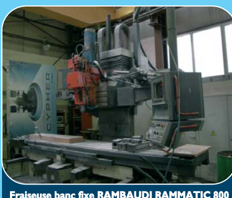
Fraiseuse banc fixe RAMBAUDI RAMMATIC 800 (1991) avec CNC FIFIA FNC 260 Courses : X 2 000, Y 800, Z 800 Table : 3 600 x 800 mm - Changeur 30 outils
