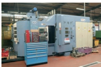
Centre MCM type CLOCK 600 Palette 500 - Axe B - Fanuc 16i
