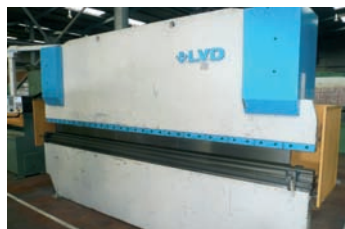
Presse plieuse LVD type PPEI CN 4 axes - Cap. 135T x 4 000
