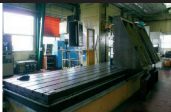
Fraiseuse COLGAR type MG V Courses : 5 000 x 1 000 x 1 500
