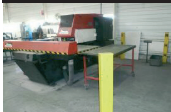
Poinçonneuse AMADA type ARIES 245 Format : 2 000 x 1 000
