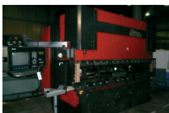
Presse plieuse AMADA type HFB CN 5 axes - Cap. 125T x 3 000
