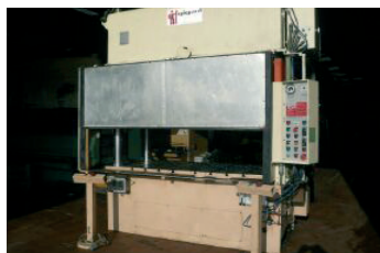
Presse 4 colonnes GIGANT Cap. 200 Tonnes
