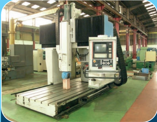
Fraiseuse à portique 5 axes continus JOB JOMACH 21 (1990) avec CNC NUM 1040 Courses : X 2 500, Y 1 600, Z 900 - Table : 4 000 x 1 500 mm Tête axe A 220° + axe C 400° - Broche 7,5 kW à 18 000 t/mn
