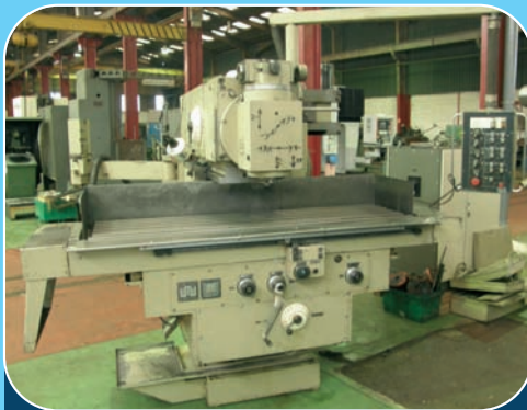
Fraiseuse Fritz Heckert FQW 400 Table : 2 000 x 400 mm Courses : X 1 400, Y 560, Z 460 Broche : 15 kw
