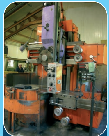
Tour vertical STANKO 1512 EX300 Diam sur plateau : 1 000 mm Diam. lax : 1 250 mm Hauteur /s traverse : 1 000 Latéral
