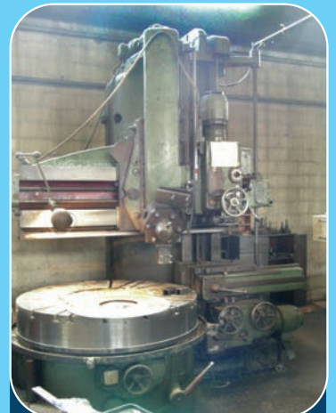
Tour vertical BERTHIEZ Diam sur plateau : 1 400 mm Hauteur sur traverse : 1 200 mm Diam max : 1 800 mm Chariot latéral
