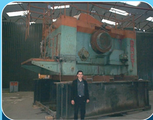
Presse mécanique 4 bielles BRET 500 T Cadence : 40 Cpm - Table : 2 400 x 1 500 mm
