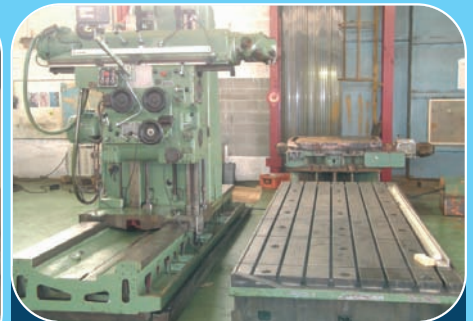
Fraiseuse banc fixe HURON LU X 3 000 Y 1 000 Z 100 - Visu 3 axes Graissage centralisé
