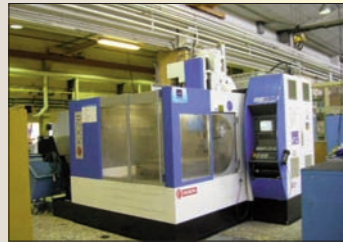
HURON KX 20 - Année 2000 1 200 x 1 000 x 550 CNC Siemens 840D Broche 24 000 tr/min
