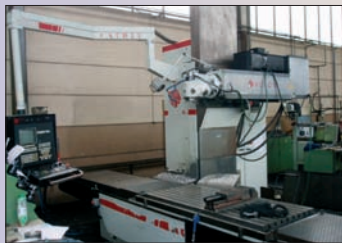
Fraiseuse CNC HURON SXB 523 1 800 x 730 x 1 000 - CNC NUM 750 Bon état + Portes outils ISO 50
