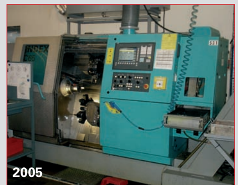
INDEX C65 SIEMENS 840 D ø 65 en barre - 2 broches 5 000 tr/mn 20 kW 3 tourelles - 2 axes Y - Outils tournants
