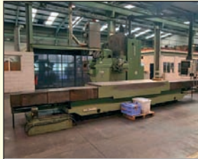
Fraiseuse banc fixe CNC de marque ZAYER modèle KF 3000 - Année 1990 Cnc HEIDENHAIN 355 - Course axe X 2 700 Course axe Y 1 000 - Course axe Z 1 000 Surface de table 3 000 x 1 000 - Tête de fraisage universelle manuelle
