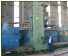
Aléuseuse CNC à montant mobile de marque JUARISTI modèle MDR 150 CM Rétrofitée en 2009 avec CNC FAGOR Course axe 5 000 mm - Course axe vertical 2 500 mm - Course axe transversal 400 mm Course RAM 1 000 mm - Table 2 000 x 2 000 Course table 1 200 mm - Diamètre de broche 160 mm - Vitesse de broche 450 tr/mn
