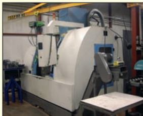
Centre usinage vertical de marque EUMACH Année 2000 - Cnc Fanuc 18 i Course axe X 1 020 - Axe Y 610 - axe Z 510 Changeur de 24 outils Vitesse de broche 8 000 tr/mn Puissance de broche 11 kW Arrosage centre broche 20 bars
