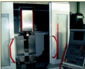
Fraiseuse CNC 5 axes de marque HERMLE type C 800 U - Année 1998 - Cnc Heidenhain TNC 430 Table 4 & 5 axes NC diamètre 540 x 540 mm Axe A 20° / 90° - Axe C 360° Course axe X 800 mm - Axe Y 600 mm Axe Z 500 mm - Vitesse de broche 8 000 tr/mn Arrosage centre broche 40 bars Changeur de 30 outils
