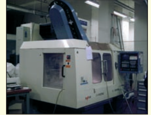
CU vertical FAMUP MCV 650 - Année 1994 CNC NUM 750 Surface table 800 x 420 - X 650 - Y 400 - Z 450 BT 40 - Vitesse de broche 20 000 tr/mn Changeur de 24 outils
