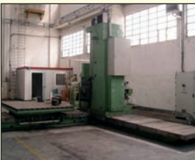
Aléuseuse à montant mobile CNC de marque PAMA modèle ACC 110 - 270 CNC ECS 2 400 D Diamètre de broche 110 Plateau 2 500 x 2 000 Course axe X (longitudinale) 5 000 Course axe Y (transversale) 1 300 Course axe Z (verticale) 1 900 - Tête de fraisage
