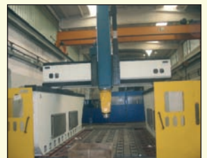
Portique 5 axes à MONTANT MOBILE CNC de marque DAVEL model MAV 621 - Année 2004 CNC SELCA 4060 PD Course axe 6 500 mm - Course axe transversal 2 850 mm - Course axe vertical 1 100 mm Changeur de 20 outils - TÊTE 5 AXES CONTINU +/- 110° - 360° - Vitesse de broche 15 000 tr/mn Puissance de broche 40 kW
