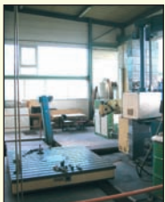
Aléuseuse CNC de marque INNSE ZENITH modèle 1-10 - CNC Num 760 B Plateau 2 000 x 2 000 Course axe X (longitudinale) 3 000 Tête de fraisage CN 360° Course axe Y (transversale) 2 000 - Course axe Z (verticale) 2 000 - Changeur automatique de tête - Convoyeur à copeaux Arrosage centre broche
