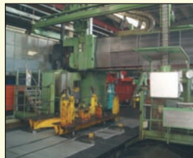
Portique à MONTANT MOBILE CNC de marque INSEE - Année 1995 - CNC NUM 760 Course axe 15 000 mm Distance entre montant 4 000 mm Course axe Y 4 700 mm distance table / nez de broche 2 100 mm Course axe vertical 1 250 mm - TÊTE AUTOMATIQUE 6 POSITIONS - Course quill 800 mm CHANGEUR DE 120 OUTILS Convoyeur à copeaux
