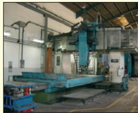
Portique de fraisage CNC de marque DYE modèle FPF 4CN/C - rétrofitée 2005 Cnc FIDIA M1F - Course axe X 500 Axe Y 4 100 - Axe Z 1 700 Vitesse de broche 2 000 tr/mn Puissance de broche 50 kW Tête de fraisage type HURON
