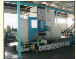
Fraiseuse banc fixe CNC de marque CME modèle FCM 3000 - Année 1997 Cnc HEIDENHAIN 407 - Course axe X 3 000 Course axe Y 1 200 - Course axe Z 1 500 Surface de table 3 500 x 1 200 Tête de fraisage type HURON
