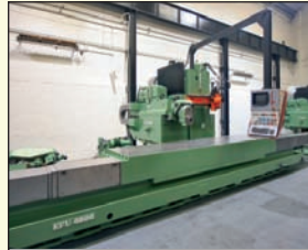
Fraiseuse banc fixe CNC de marque ZAYER modèle KFU 4000 - Année 1990 Cnc FIDIA FD CNC 10 - Course axe X 3 700 Course axe Y 1 000 - Course axe Z 1 000 Surface de table 4 000 x 1 000 Tête de fraisage AUTOMATIQUE Changeur de 40 outils
