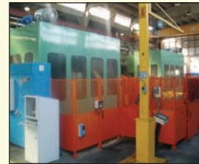
DEUX CENTRES D'USINAGE HORIZONTAUX de marque MANDELLI - Modèle REGENT 1500 CNC SIEMENS 840 D 10 PALETTES DE 1 000 mm x 1 000 mm Course axe X 2 800 mm - Course axe Y 1 500 mm Course axe Z 1 500 mm - Changeur de 120 outils par centre d'usinage - Année 1995 - Arrosage centre broche haute pression
