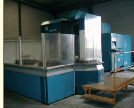
Centre d'usinage FOREST LINE FLEXIAX 480 - Cnc FANUC 15 M - Année 1990 QUATRES palettes 800 x 800 - X 1 200 - Y 1 000 - Z 1 000 - B 360 000° - Changeur 80 outils Vitesse de broche 4 000 tr/mn - Puissance de broche 23 kW - Boîte de vitesse
