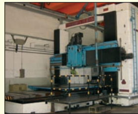
Portique de fraisage CNC de marque DROOP & REIN modèle FASH 140 KU rétrofitée 2001 Cnc SELCA S4040 - Course axe X 4 000 Axe Y 3 850 - Axe Z 1 800 - Traverse verticale mobile - Distance entre montant : 3 850 mm Puissance de broche 25 kW Tête de fraisage type HURON
