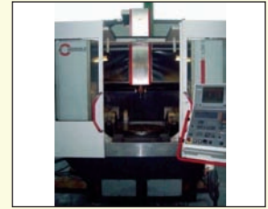
Fraiseuse CNC 5 axes de marque HERMLE type C 1200 U - Année 1999 Cnc Heidenhain TNC 430 Table 4 & 5 axes NC diamètre 800 mm - Axe A 15° / 97° - Axe C 360° - Course axe X 1 200 mm Axe Y 900 mm - Axe Z 500 mm - Cône type 40 Vitesse de broche 8 000 tr/mn - Arrosage centre broche 40 bars - Changeur de 87 outils
