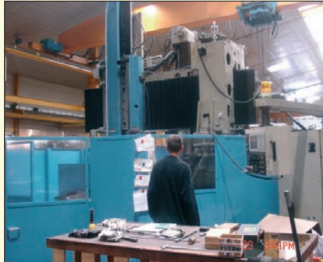
Tour vertical à banc déplaçable CNC TOSHIBA modèle TSN 16 / 32 A - CNC MITSUBISHI MELDAS 520 - Rétrofitée 2000 Diamètre plateau 1 600 mm - Diamètre usinable 3 200 mm Hauteur de passage / traverse 1 400 mm - Course verticale de la traverse 900 mm Boîte de vitesse - Puissance moteur 37 kW - TRES BON ETAT
