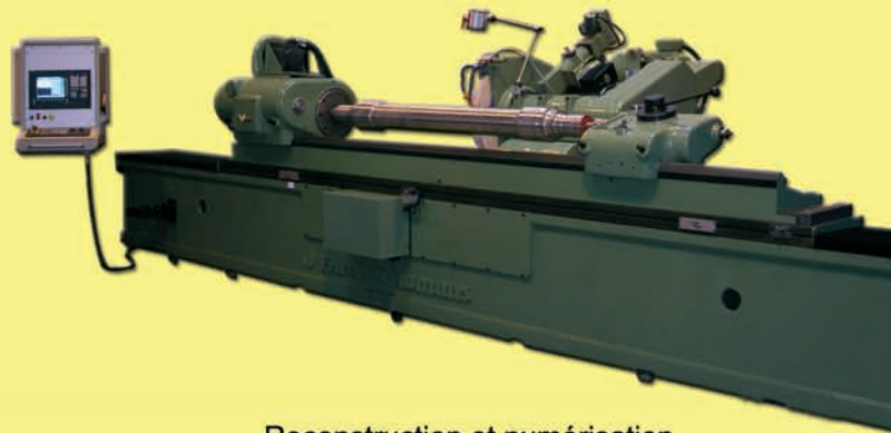
Reconstruction et numérisation rectifieuse cylindrique 5 axes
