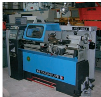
AV Tour parallèle CAZENEUVE - Type HBX 360 - EP : 1 000 mm - Diamètre : 360 mm - Visu 2 axes - Réf. 4590 Contact : +33 556 57 01 22
