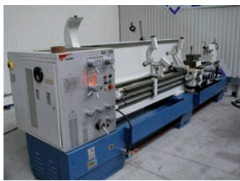
AV Tour parallèle NARDINI NZ - 325 x 3 000 mm - Diam. au dessus du banc : 650 mm - EP : 3 000 mm - Diam. dans le rompu : 860 mm - Tél : 01 34 08 42 42 E-mail : dmr@dmr.fr
