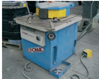
AV Encocheuse / grugeuse hydraulique EUROMAC MULTI 220/6 VA - Capacités : 220 x 6 mm - Angle variable de 30° à 140° - Contact : 06 18 37 68 26
