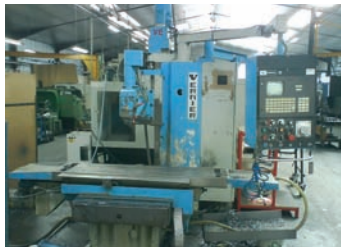
AV Fraiseuse VERNIER DB 420 CNC Table : 1 600 x 400 mm - Courses : 1 100 x 600 x 420 mm Tél : 06 18 37 68 26
