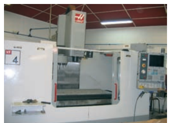
AV Centre d'usinage HAAS VF4B Courses : 1 270 x 508 x 635 - Broche : 15 Kw - 2 gamme de vitesse - 7 500 tr/min - ISO 40 - E-mail : contact@fihht.fr
