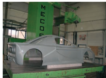
AV Fraiseuse à colonne mobile MECOF X 7 500, Y 1 500, Z 2 200 Tête 4/5 axes continus - 17 000 tr/min - Taque + table tournante - 2 000 x 2 000 - W 1 800 - CN Heidenhain i.530 - Tél : 03 83 15 22 85
