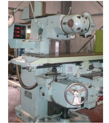
AV Fraiseuse DUFOR type 302 - Course : 1 100 x 400 x 550 - Visue 3 axes Placard d'outillage - Tél : 02 31 82 62 62 lepareur@wanadoo.fr
