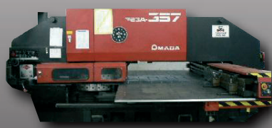
Poinçonneuse CNC AMADA - PEGA 357 30 T - 1 270 x 3 660 mm avec repos. CN Fanuc - Tourelle 44 outils 2 auto index
