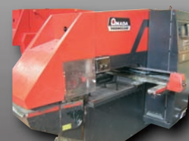
Poinçonneuse CNC AMADA - ARIES 222 20 T - 600 x 1 200 mm avec repos. CN Fanuc - Tourelle 10 outils
