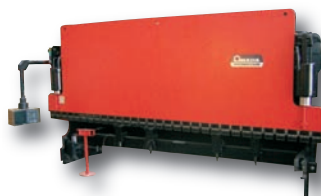
Presse plieuse AMADA PROMECAM - STPC 200 T x 6 000 mm CNC 4 axes
