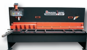
Cisaille guillotine AMADA GPN 630 3 000 x 6 mm - CN Soutien de tôle arrière et évacuateur
