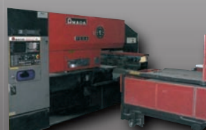
Poinçonneuse CNC AMADA - PEGA 244 20 T - 1 000 x 2 000 mm avec repos. CN Fanuc - Tourelle 24 outils 2 auto index
