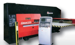
Poinçonneuse CNC AMADA - EUROPE 258 20 T - 1 270 x 4 000 mm avec repos. CN Fanuc - Tourelle 31 outils 3 auto index - 2001
