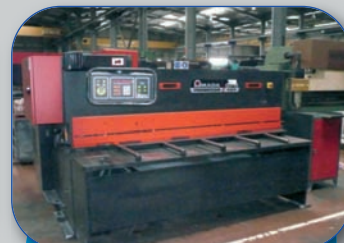
Cisaille guillotine AMADA GPN 420 Support tôle Transporteur à bandes
