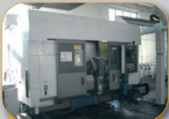
Tour MORI SEIKI MT 2000 Bi broche - Bi tourelle - Axe Y Tête de fraisage - Robot de chargement PROMAT - S240
