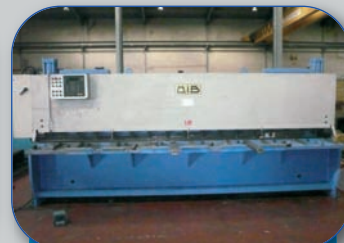
Cisaille guillotine MIB 106 4 000 x 6 - Butée arrière à commande numérique DNC 10 - Support tôle arrière avec transporteur à bande
