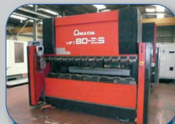
Presse plieuse AMADA HFT 80-25 CNC DC 2000 4 axes
