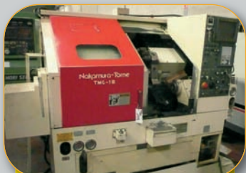
Tour NAKAMURA CN TMC 18 Diamètre de passage : 240 mm Longueur usinable : 256 mm avec ravitailleur de barre
