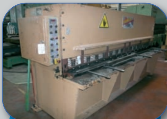
Cisaille guillotine COMETAL CN 306 Cap. : 3 000 x 6 mm
