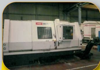
Tour CNC YANG CK3B Diamètre de passage : 650 - 440 - EP : 1 300 mm Diamètre mandrin : 315 mm Tourelle 12 postes
