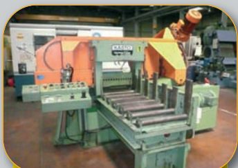
Scie à ruban automatique KASTO KALTENBACH Diam 320 mm - Amenage automatique
