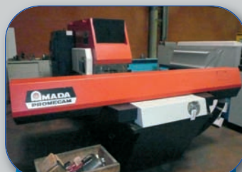
Poinçonneuse AMADA ARIES 2.4.5 Format : 2 000 x 1 000 - EP 4 mm
