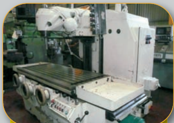
Fraiseuse HURON PU50 Courses : 1 300 x 1 000 x 600 mm Visu 3 axes
