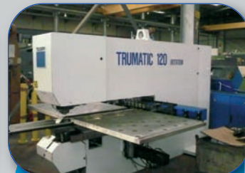
Poinçonneuse TRUMPF 120 Rotation Format : 1 000 x 2 000 EP 4 mm
