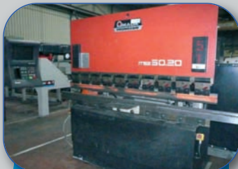
Presse plieuse AMADA ITS II 50-20 CN Opérateur Cap. : 50T x 2 000 mm
