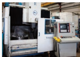
Tour vertical CN BERTHIEZ TVR 80 - ø plateau 800 mm - ø max usinable 1000 mm - NUM 1060 de 1997
