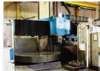
Tour vertical CN BERTHIEZ BM 160 ø plateau 2200 mm - ø max usinable 3200 mm - NUM 760 - Changeur d'outils - Convoyeur à copeaux
