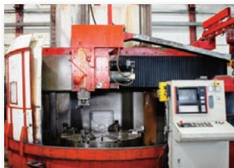
Tour vertical BERTHIEZ TFM 160 ø plateau 1650 mm - ø max usinable 1880 mm - CN NUM 1060 de 1998
