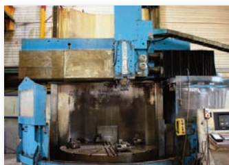
Tour vertical CN BERTHIEZ TFM 200 ø plateau 2000 mm - ø max usinable 2300 mm - NUM 760 - Changeur d'outils - Convoyeur à copeaux
