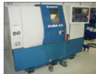
Tour CNC DAEWOO PUMA 8S Fanuc O-T - Année 95 - 500 sur banc - 310 sur chariot - Entre pointes 370 mm Barre 51 mm - Mandrin D 210 mm Vitesse 5.000 TR/mn
