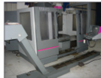
MAHO MH 1200 W CNC PHILIPS 532 Courses X 1200 - Y 600 - Z 600 Table 4 axe D 800 mm broche 6300 TR/mn
