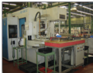
Tailleuse CNC fraise-Mère PFAUTER PE 150 C - Bosch CC220 - Année 1992 - ø maxi 150 Module maxi 4 - Unitaire ou carrousel de chargement
