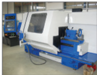
Tour TOS SU50 CNC Autoapprentissage HEIDENHAIN MANUAL + diamètre sur banc 500 - Chariot 390 - Entrepointes 1300 mm - broche D62 - Tourelle MULTIFIX
