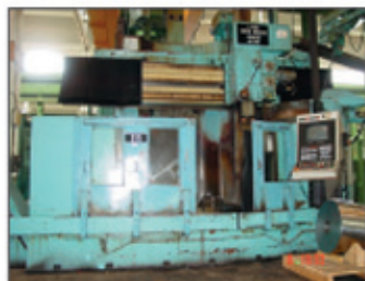
TOUR BERTHIEZ TFM 160 NUM 760 Magasin 12 outils convoyeur à copeaux plateau ø 1640 4 Mors serrage hydraulique
