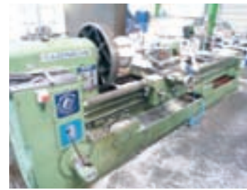
Tour CAZENEUVE HB 725 Sur le banc : 725 mm Entre pointes : 2000 mm Alésage de broche : 81 mm
