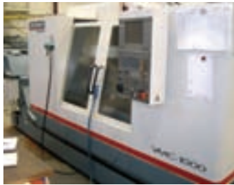
Centre d'usinage CINCINNATI ARROW 1000 CNC HEIDENHAIN 426 Année 1999 Courses X Y Z : 1020,5 x 510,5 x 560 mm Vitesse de broche : 10 000 tr/min
