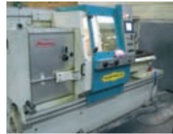
Tour CNC PINACHO SMART 310 FANUC CNC POWERMATE 0 Année 2004 Hauteur de pointes : 310 mm Distance entre pointes : 1 500 mm Admis sur le banc : 620 mm
