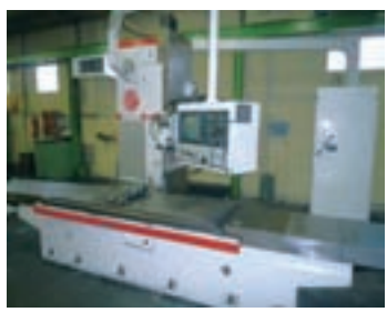
Fraiseuse banc fixe HURON SXB 623 CNC HEIDENHAIN TNC 155 Course longitudinale X : 2050 mm Course transversale Y : 730 mm Course verticale Z : 1030 mm
