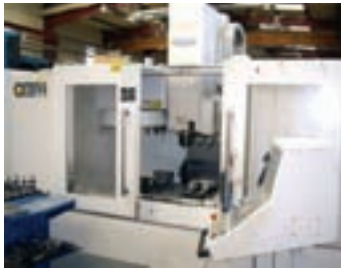
Centre d'usinage HARTFORD VMC 1270 CNC HEIDENHAIN 426 Année 2003 Courses X Y Z : 1246 x 623 x 560 mm Vitesse de broche 8000 tr/min
