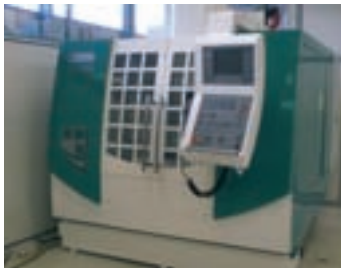
Centre d'usinage TRENS MC 100 VA Heidenhain TNC 426 Année 1999 Surface de la table : 1080 x 580 mm Courses X Y Z : 1006 x 610 x 762 mm
