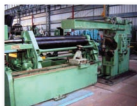
Machine à faire tomber les bords BOLDRINI - RIBO12/4000 4000 x 12 mm - Avec accessoires
