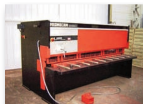
Cisaille guillotine AMADA PROMECAM GH 1030 3000 x 10 mm - Butée arrière électrique
