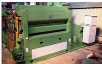
Planeuse LISSE - 9.63 1600 x 5 mm - 9 rouleaux
