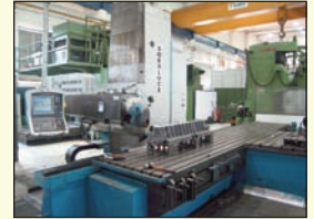
Fraiseuse CNC de marque SORALUCE modèle SP 6000 - Année 2000 CNC Heidenhain TNC426 Course axe X 4 500 - Axe Y 1 200 - Axe Z 1 600 Tête universelle
