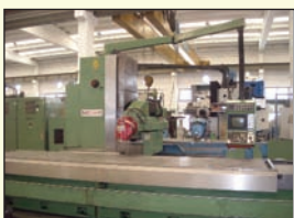
Fraiseuse CNC marque NOVAR type KBF 5000 Heidenhain TNC 360 Course axe X 4 000 mm Course axe Y (vertical) 1 400 mm Course axe transversal 1 000 mm Tête de fraisage automatique type KAR 2 Cône ISO 50
