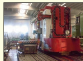
Fraiseuse à montant mobile de marque SORALUCE type FS 12 000 CNC Heidenhain 430 - Année 1998 Tâches de 6 000 mm x 2 000 mm - Table rota- tive de 2 000 mm x 2 000 mm avec course de 1 000 mm - Course axe X 12 000 mm Axe Y (vertical) 2 400 mm - Axe Z 1 500 mm Changeur de 80 outils
