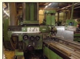
Fraiseuse conventionnelle à montant mobile de marque MECOFF - Visualisation 3 axes Course axe X 4 260 mm - Axe Y 1 000 mm Axe Z (vertical) 1 700 mm - Avance variateur Tête universelle
