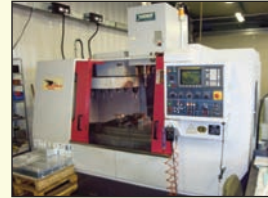
Centre d'usinage CNC de marque YANG modèle SMV 1000 - Année 2000 - Fanuc OM Course axe X 1 020 mm - Axe Y 510 mm Axe Z 510 mm - Vitesse de broche 6 000 tr/mn Changeur de 20 outils - Arrosage centre broche - Convoyeur à copeaux
