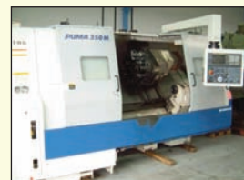
Tour CNC DAEWOO modèle PUMA 350 M Fanuc 18 T - Année 1999 Mandrin diamètre 380 mm - Axe C Outils tournants - Tourelle 12 outils - Passage de broche 100 mm - Entre pointe 1 000 mm Diamètre de passage sur banc 450 mm
