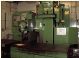
Fraiseuse CNC de marque SORALUCE modèle FS 5000 - Année 1991 CNC Heidenhain TNC415 Course axe X 4 700 - Axe Y 1 050 - Axe Z 1 250 Tête automatique 6 positions - Changeur de 30 outils - Table circulaire CNC de marque FIBRO 1 500 x 1 500
