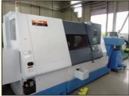
Tour CNC de marque MAZAK modèle SOT 300 Année 2001 - CNC Mazatrol Fusion 640 T Diamètre de tournage / le banc 620 mm Diamètre sur le chariot 420 mm - Entre pointe 1 000 mm - Puissance de broche 22 kW Tourelle de 12 outils - Mesureur d'outils
