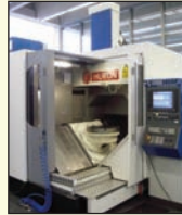
Centre d'usinage HURON modèle KXZ 10 FIVE 5 AXES - ETAT NEUF - ANNEE 2007 Course axe X 900 - Axe Y 900 mm - Axe Z 500 mm A -45° / +180° - C 360° - Vitesse de broche 24 000 tr/mn - Surface de table 5 AXES Diamètre 630 mm - ANNEE 2007 ETAT EXCEPTIONNEL 1000 HEURES
