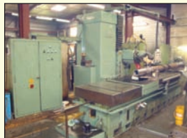
Fraiseuse Conventionnelle de marque FIAS Visualisation 3 axes Course axe X 3 000 - Axe Y 1 000 - axe Z 1 000 Avance variateur - Tête universelle
