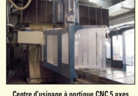
Centre d'usinage à portique CNC 5 axes CORREA RAPID 40 - Année 2001 CNC Siemens 810 Surface de table 4 000 x 1 500 mm Course axe X 4 000 - Axe Y 2 600 Axe Z 1 500 - Distance entre montant 2 300 mm Tête 5 axes +/- 200° - B +/- 95° - Cône HSK 63 Vitesse de broche 18 000 tr/mn Changeur de 24 outils
