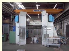
Fraiseuse CNC à portique 5 AXES de marque RAMBAUDI modèle RAMSPEED H 60 L Année 1997 CNC Siemens 840 D - Course axe X 6 000 mm Axe Y 2 700 mm - Axe Z 1 500 mm - Tête 5 axes automatique - Vitesse de rotation 15 000 tr/mn Cône HSK 63
