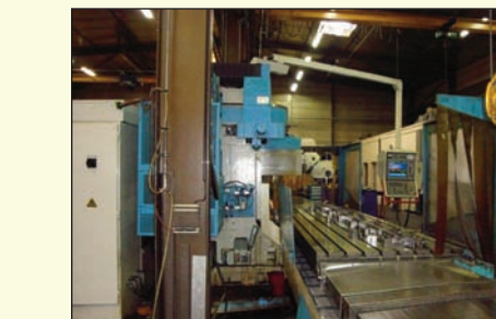
Fraiseuse CNC de marque MSA modèle BF 4200 - Année 2002 CNC Heidenhain TNC426 Course axe X 4 200 - Axe Y 1 200 - Axe Z 1 250 Tête automatique - Changeur de 30 outils Arrosage centre broche 20 bars Convoyeur à copeaux
