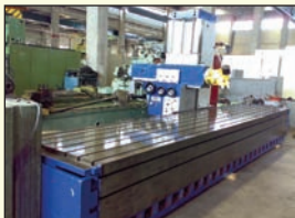
Fraiseuse conventionnelle MECOFF modèle CS 10 - TRES BON ETAT Surface de table 6 000 x 1 050 Course axe X 4 300 mm - Axe Y 970 Axe Z 1 700 mm Vitesse de broche 35 / 1 132 tr/mn Puissance de broche 25 HP
