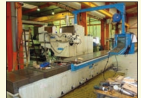
Fraiseuse CNC de marque ZAYER modèle 4000 BF3 - Rétrofitée 2000 CNC Heidenhain TNC 426 Course axe X 3 600 - Axe Y 1 000 - Axe Z 1 000 Surface de table 4 000 x 700
