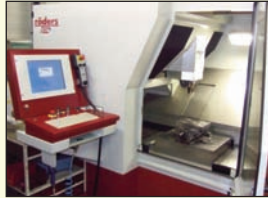
Centre d'usinage CNC de marque RÖDERS modèle RXP 500 - Année 2007/2008 Course axe X 500 mm - Axe Y 400 - Axe Z 240 mm Vitesse de broche 42 000 tr/mn Changeur de 21 outils - Palpeur laser Avance rapide 40 mm/mn
