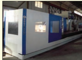
Fraiseuse CNC de marque SORALUCE modèle SP 12 000 - Année 2005 CNC Heidenhain iTNC 530 Course axe X 10 500 mm - Axe Y (vertical) 2 000 mm - Axe Z 1 200 mm - Tête automatique 1°/1° Changeur de 60 outils - Table circulaire CNC de marque PHVCN 1000 avec contre pointe Arrosage centre broche 20 bars ETAT NEUF et EXCEPTIONNEL - 2940 HEURES
