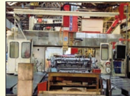
Portique CNC de marque FOREST LINE modèle MAJORMILL 360 - Année 1992 - CNC NUM 760 F Course axe X 16 000 mm - Axe Y 4 150 mm Axe Z 1 250 - Distance entre montant 3 600 mm Vitesse de broche 32 kW Changeur de 72 outils - Tête AUTO 2.5 Tête angulaire Changeur de tête automatique MACHINE EN TRES BON ETAT
