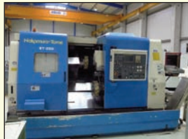
Tour CNC de marque NAKAMURA modèle WT 250 - année 1998 - CNC Fanuc 18 T Diamètre de tournage / la tourelle 250 mm Distance entre broche 870 mm Deux tourelles 2 x 12 outils - Deux broches Ravitailleur de barre F M B
