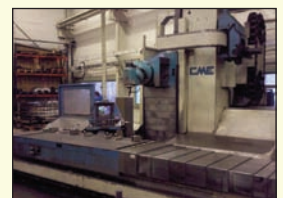
Fraiseuse CNC banc fixe de marque CME modèle BF 04 - Année 1996 CNC Heidenhain TNC 426 Course axe X 2 500 mm - Axe Y 1 200 Axe Z 1 500 mm - Tête automatique Changeur de 30 outils Convoyeur à copeaux
