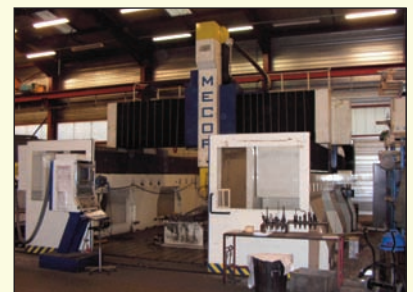
Fraiseuse CNC à portique 5 AXES de marque MECOFF modèle DYNAMILL 2000 Année 1996 / 1997 CNC Fidia M 30 - Course axe X 5 500 mm Axe Y 3 000 mm - Axe Z 1 250 mm Tête 5 axes automatique Vitesse de rotation 18 000 tr/mn
