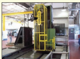
Fraiseuse à montant mobile de marque COLGAR type PRGRAM 200 CNC Fanuc 15 MB Course axe X 7 000 mm - Axe Y (vertical) 2 750 mm Axe Z 1 000 mm Tête de fraisage bi rotative automatique Changeur de 60 outils
