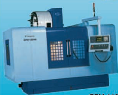
CPV 1100B Centre d'usinage vertical à glissières prismatiques.
