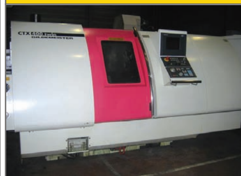
Tour CNC GILDEMASTER GTX 400 E Ø 420 mm - Longueur 600 - 2 Broches opposées + contre broche - CN HEIDENHAIN PILOT
