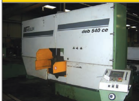
Scie à ruban MISSLER type DEB 540 CE Amenage automatique - Ø de coupe 540 mm
