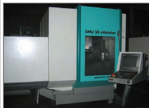
CU vertical DMU 50 EVOLUTION Table 500 x 380 - Courses 500 x 420 x 380 - 2 Magasins d'outils - CN HEIDENHAIN
