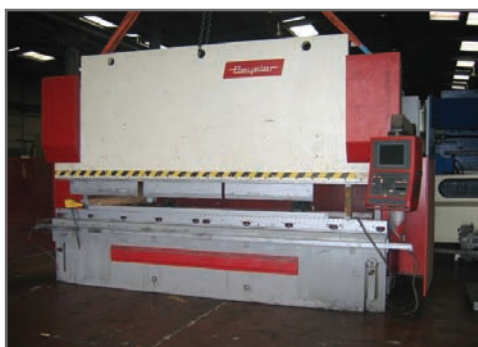
Presse plieuse BEYELER PR 6 Capacité : 200 T. x 4000 mm - CN 6 axes
