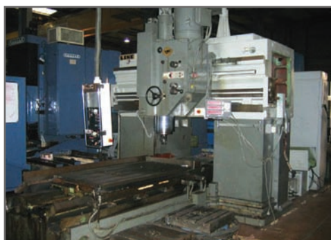
Fraiseuse à portique LINE Table : 1500 x 800 - Courses : 1500 x 900 x 600
