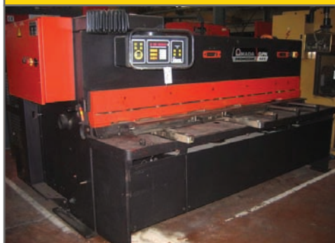
Cisaille guillotine AMADA GPN 425 Capacité : 2500 x 4 - Support tôles fines
