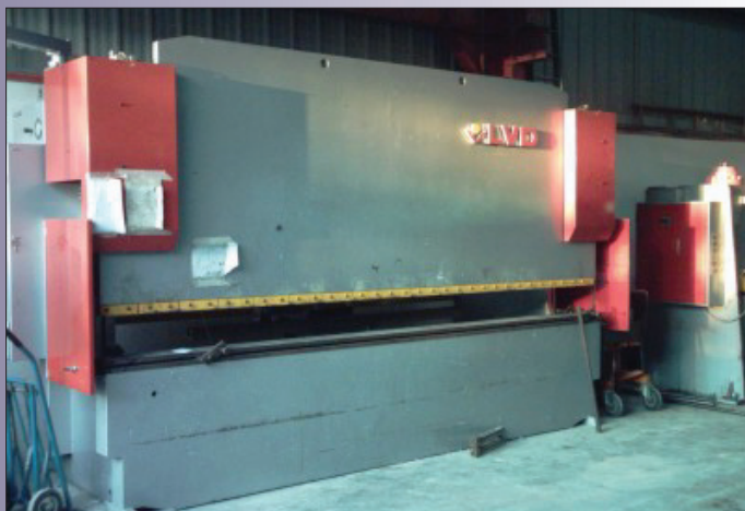
Presse plieuse C.N.C. LVD type PPE-I-170/42 Puissance : 170 T x 4200 mm
