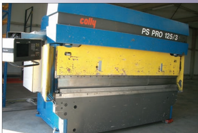
Presse plieuse COLLY PPSRO125/3 - C.N.C. DELEM DA24 3 axes - 125 T x 3060 mm
