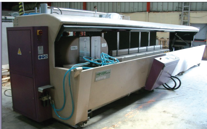
Tronçonneuse aluminium double tête C.N.C. FOM type BLITZ 50 THETA CZ C longueur 6000 mm
